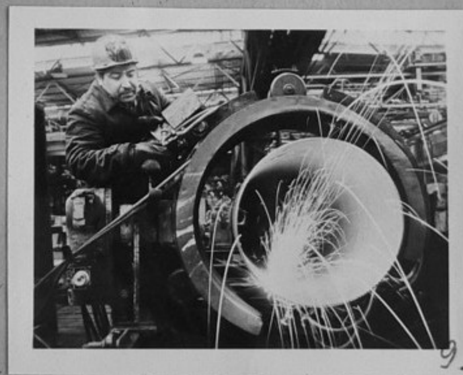
85-887-9-В з-да за тръби в Хомутов-обработка на тръба до диаметър 530мм в един от цеховете на з-да. /репр./ЛА
