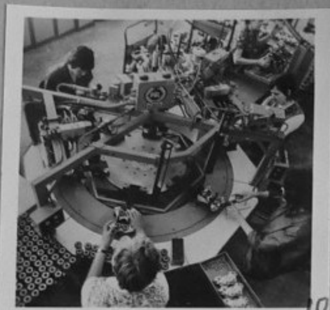
76-1163-10-Това оборудване за монтаж на дискови спирачки е проектирано и произведено в АВТОБРЗДИ. /Репродукция/, ЗЩ.
