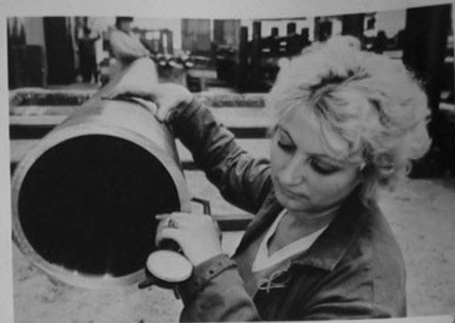
85-887-11-Проверка на дебелината на тръбите. /репр./ЛА
