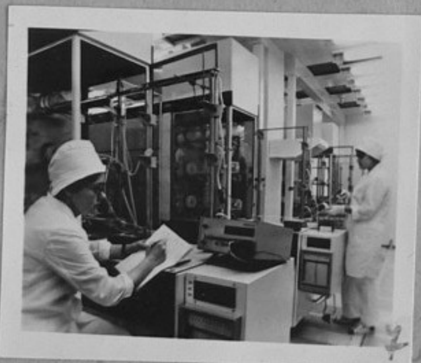
81-1383-7 Наскоро бе открит технологичен комплекс за микроелектроника към Научно-изследователски институт "ТЕСЛА-А.С.ПОПОВ" в Прага - в лабораторията за температурни операции Ева Дудрова/в ляво/и Зузана Кубова регулират работния режим в дифузионна пещ М.Калина/МД
