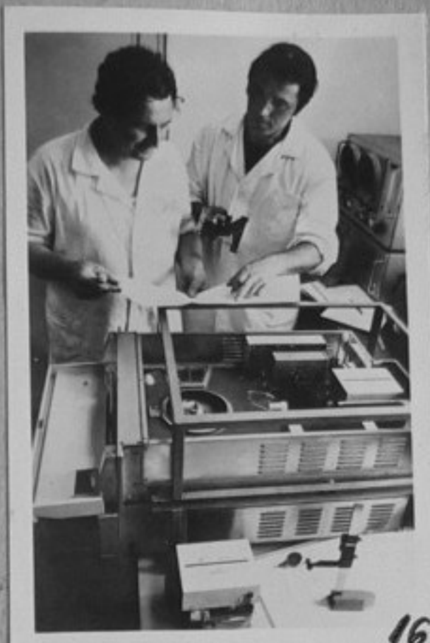
77-3178-16-В завода за магнетофонна техника "Збройовка" във Бърно се изпробват прототипите на касетъчната дискова памет ЕС 5069. Техниците Павел Клестил и Зденек Свобода се приготвят да използват прототип на дисковата памет ЕС 5069. /репр./ЛА
