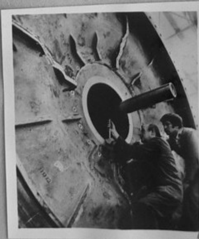
81-1395-1 Вацлав Ратай по време на работа на ЕТ 05 роторно парезна машина, с която се изработва ротора на турбоалтернатора 200 М2 И.Влах/МД
