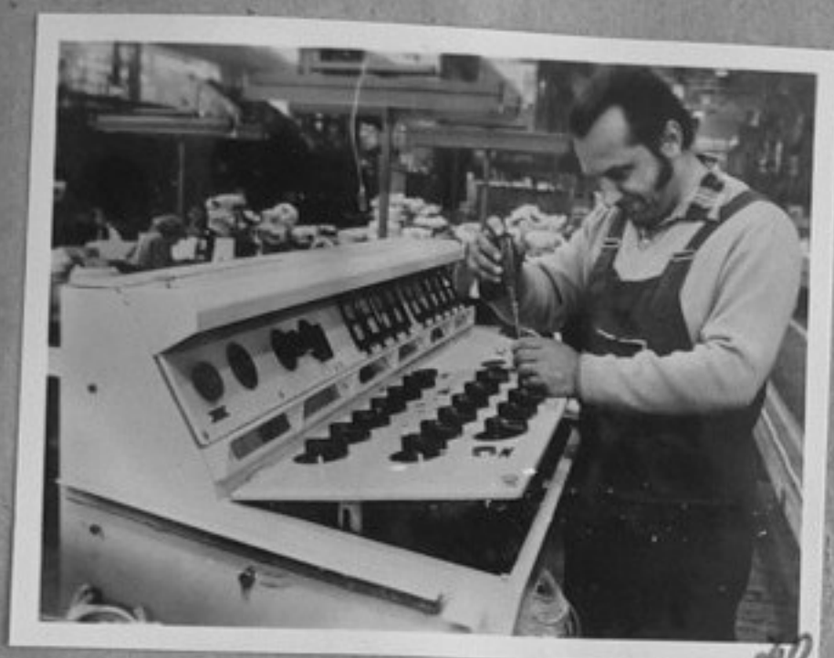
74-1323-20-Ел. техникът Иржи Жиндра монтира контролното табло на ел. локомотив "Е-62" в заводите "Шкода", Пилзен. /Репр. П. Щерев/СС
