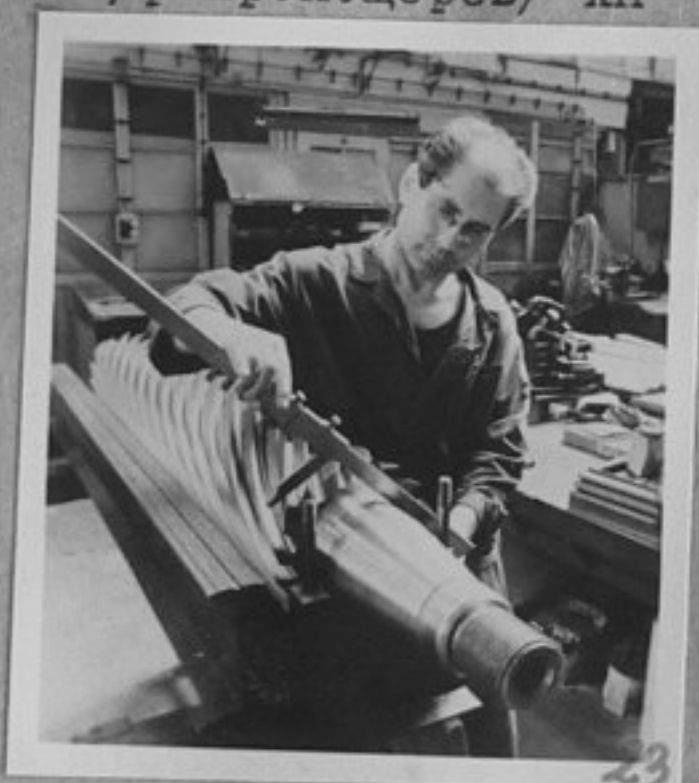
74-196-23-Механикът Шмид изработва обикновени метало-режачи фрез-машини за цветни метали с диаметър 254 мм. в инструменталния завод към заводите "Шкода" в Пилзен, Западна Бохемия.
