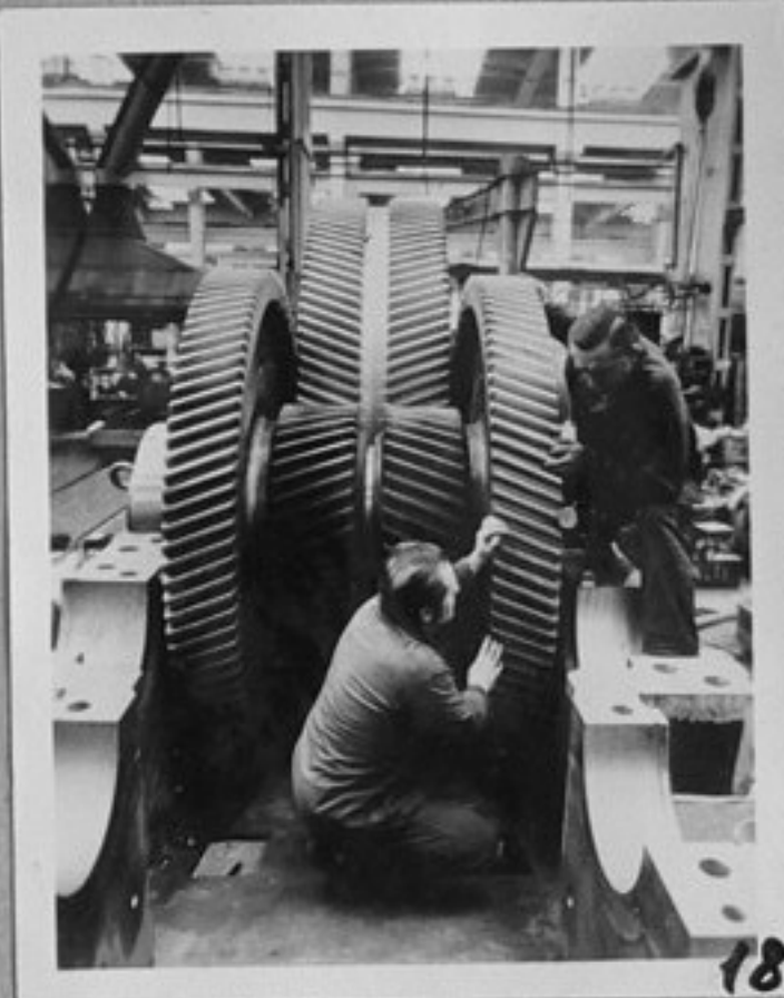
75-4817-18-Изглед от механичния завод на заводите "Шкода", където се произвеждат скоростни кутии. Шлосерите Ладислав Симанек и Вацлав Бездек измерват захващането при промяна на скоростите на гигантския ескаватор КУ 800, който ще работи на открития рудник в Прунеров, Северна Бохемия. /Репродукция/, ЗЩ.
