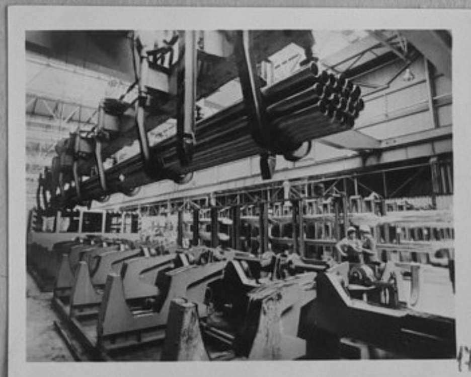
82-2655-17-Полиране на антикорозионни тръби с диаметър 75мм, за да могат да бъдат готови за изпитване на теч. репр./ЛА
