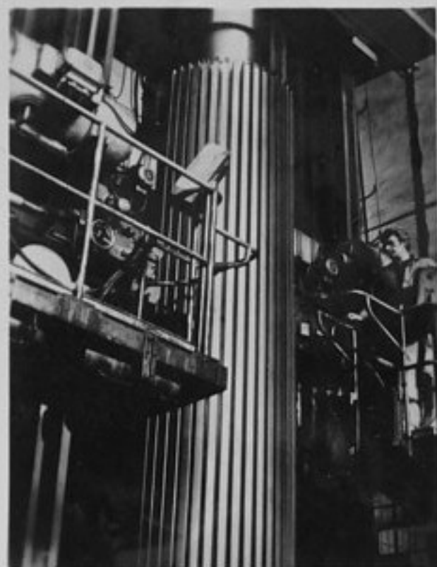
81-1395-1 Вацлав Ратай по време на работа на ЕТ 05 роторно парезна машина, с която се изработва ротора на турбоалтернатора 200 М2 И.Влах/МД
