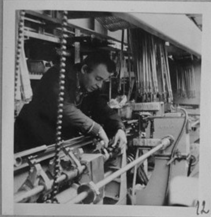
85-1042-12,13,14-В з-да в Храстава се работи върху нов модел тъкачен стан, с който ще се достигне скорост на тъкане 1 00 м в минута- /репр./ЛА
