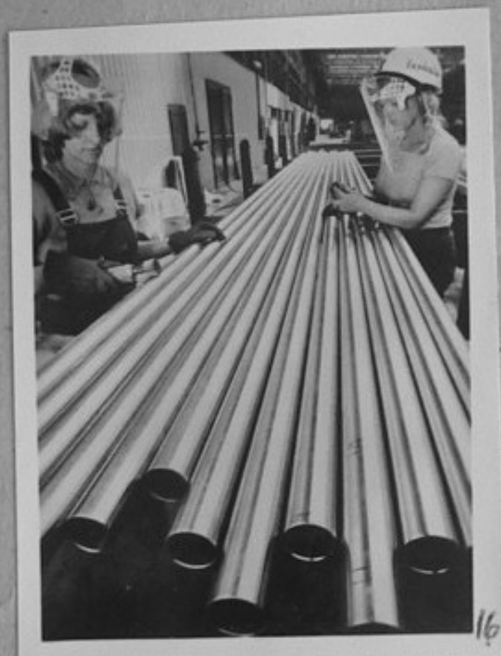
82-2655-16-Прокатните станове и Металургичния комбинат в Чомутов, Северна Бохемия, произвеждат безшев- ни тръби от най-различни видове. Зденка Коларжова и Ева Джибикови- чова довършват обработката на анти- корозионни безшевни тръби, които са с диаметър 57мм. /репр./ЛА
