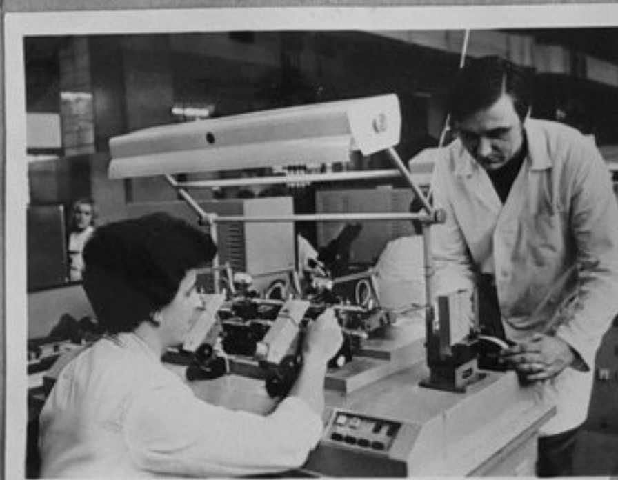
Заводи за телекомуникационни уреди "Тесла" в Рожнов, Северна Моравия. /репр./, ИК 75-1147-47-Божена Опалкова - ръководител на младежка бригада за соц.труд произвежда поредния полуавтоматичен апарат за термо-сгъстителен контакт на цялостни вериги.
