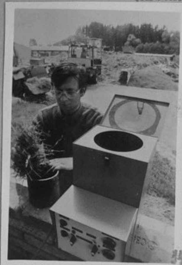
84-932-14 Инж. Ян Рихоут от кооператива в Нетребице измерва сухото в-во на сено със спец. новосъздадена електронна апаратура. репр./КИ
