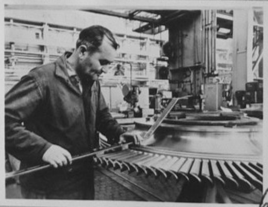
74-3036-6-Шлосерът Антонин Кржистал изработва перки за ротори, предназначени за ел-централа "Букурещ III", Западна Бохемия. /Репр. П.
