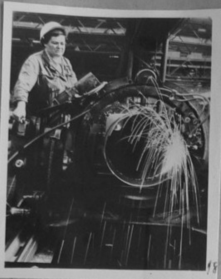
82-2655-18-Алжбета Фабианова полира краищата на безшевни тръби с диаметър 530мм. репр./ЛА
