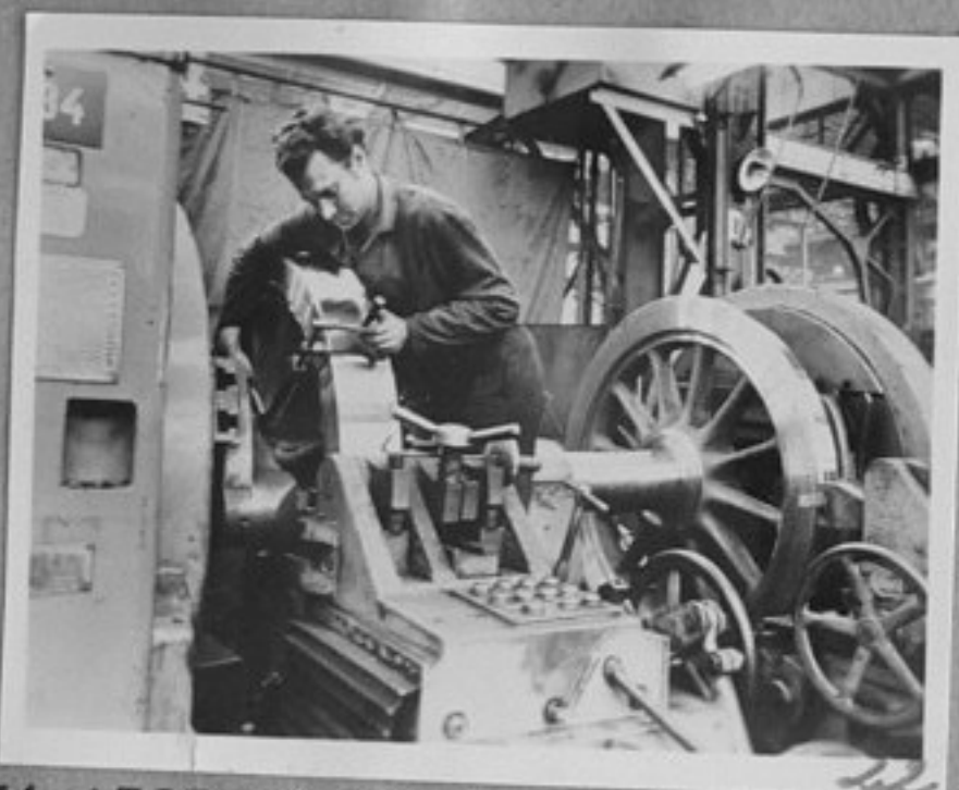
74-1323-22, 23-Стругарят Вацлав Янски измерва диаметъра и профила на двигателната ос на електрически локомотив "Е-62" в Електролокомотивния завод към заводите "Шкода" в Пилзен. /Репр. П. Щерев/СС
