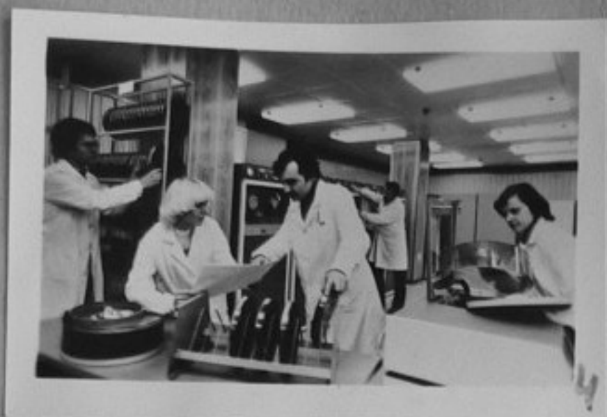
81-1383-4 В Острава, Северна Моравия бе въведен в експлоатация нов електронно-изчислителен център, оборудван с ЕИМ и ЕС 1055, произв. в завод "РОБОТРОН" в ГСР - общ изглед от ЕИМ и ЕС 1055 и от дисковите агрегати, които представляват външната памет П. Бергер/МД
