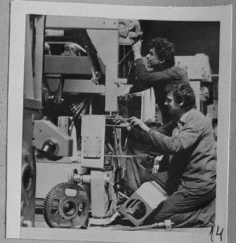
85-1042-12,13,14-В з-да в Храстава се работи върху нов модел тъкачен стан, с който ще се достигне скорост на тъкане 1 00 м в минута- /репр./ЛА
