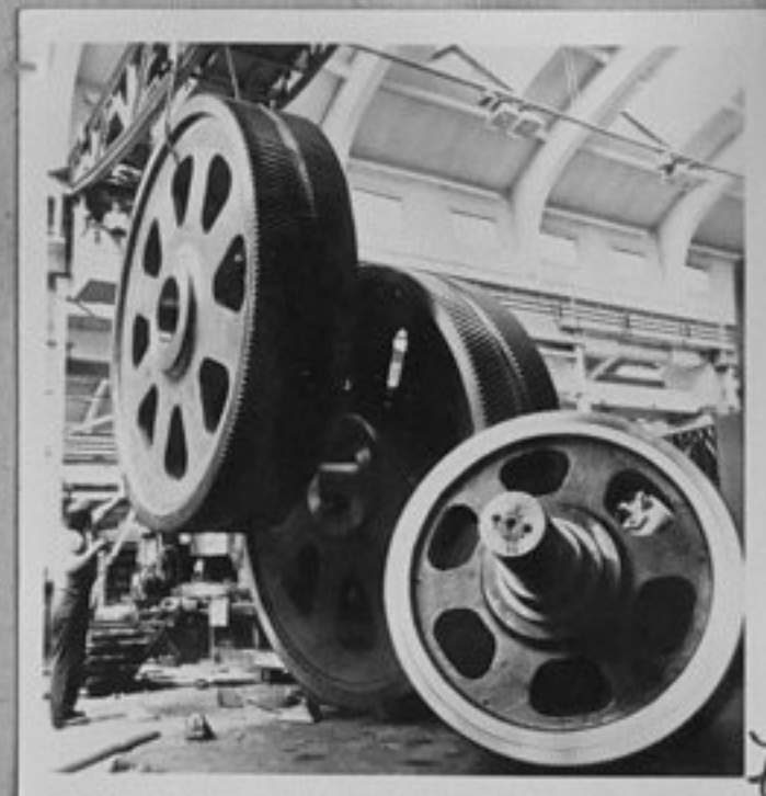
78-488-7 Гигантски колела, част от скоростни кутии, проектирани да задвижват захарни заводи в Куба, произведени в машиностроителните заводи "Шкода" в Пилзен, Западна Бохемия
