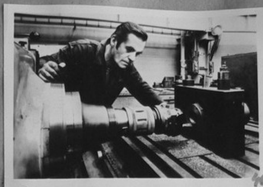
75-1147-46-Операторът Иржи Винч работи на специална фрез и бор-машина, която работи с точност 1 до една хилядна от милиметъра.
