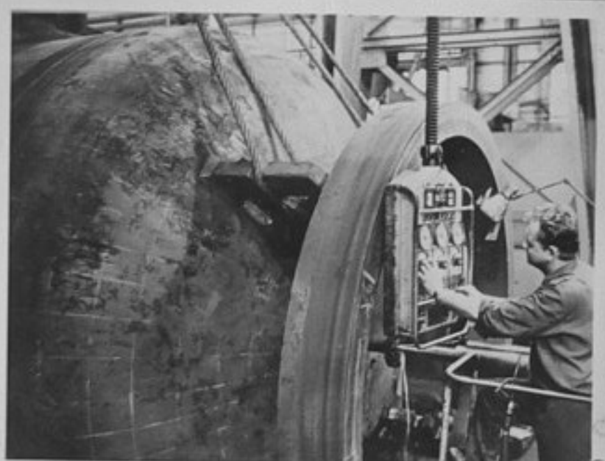
78-2495-3,4 В комбината "Шкода" в Пилзен се работи върху скъсения парен котел на атомния реактор, който ще бъде използван в реакторната зала за изпробване на капацитет за парни котли "ВВЕР-440"
