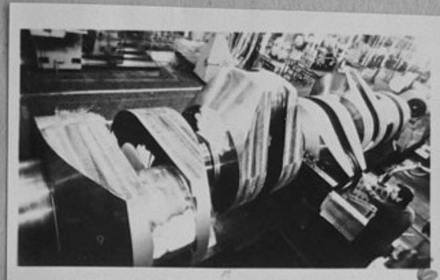
80-2884-6 Дългият 9.5 м.колянов вал за кораби е предназначен за Холандия П.Бергер/МД
