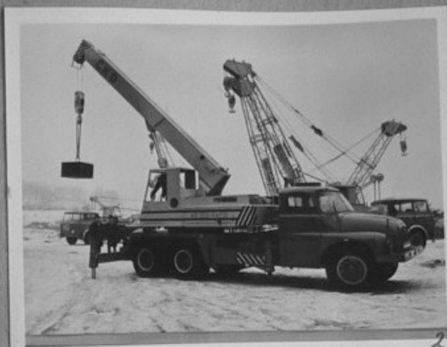
70-604-23-Кран, произведен в инженерните заводи в Слани. Товароподемност 15 тона и максимална височина на повдигане 16.5 м. /репр./ XII
