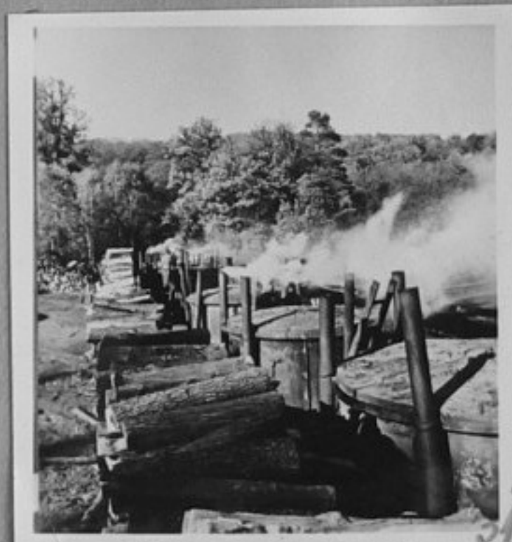
72-2020-31-Производство на дърве- ни въглища чрез суха дестилация в дестилационни пещи. /репр.П.Щерев/МК
