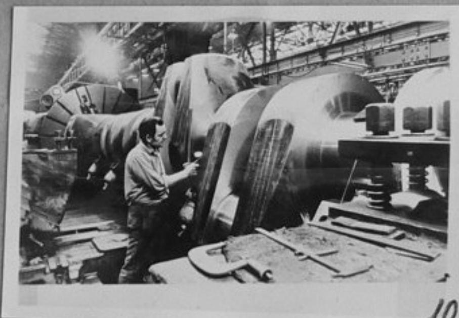
74-3036-10-В заводите "Шкода" в Пилзен, стругарят Ярослав Габриел изработва 45-тонен колян вал с 5 маха, предназначен за полските корабостроителници. /Репр. П. Черев/СС
