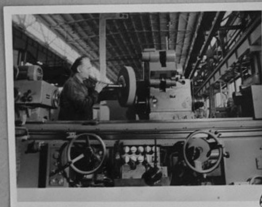
78-2770-6 Заводите "ТОС" в Прага-Хостивар, са най-старите производители в Европа на машинообработващи инструменти, пионер в производството на шлайфмашини. Техният Ян Устохал монтира шлайф-диск на универсална шлайфмашина "ВХУ", предназначена за иднос в Аржентина
