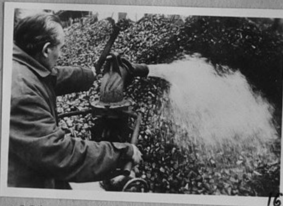
79-1027-16-Станислав Шида използва струи вода, за да придвижи захарното цвекло до специалните платформи за превоз. Той е работник от захарния завод в Ужице, Централна Бохемия.
