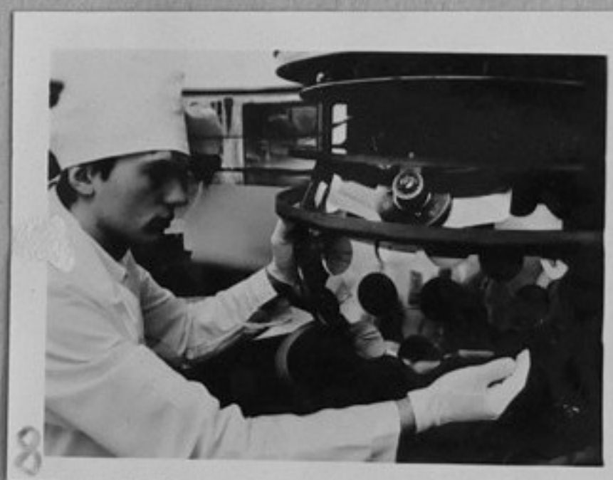
81-1383-8 Иржи Махачек извършва една от ключовите операции в производството на напрегнати интегрални схеми - той поставя дискове във вакуумна тръба, където те се покриват с алуминий Научно-изследователски институт "ТЕСЛА-А.С.ПОПОВ" - Прага М.Калина/МД
