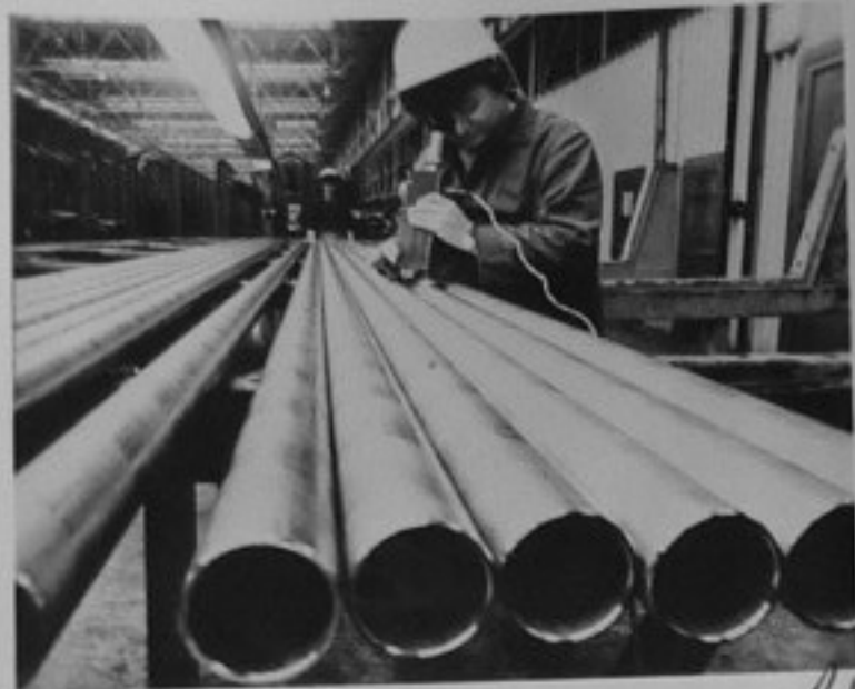
85-887-10-Проверка на качеството на антикорозионния слой на тръбите. репр./ЛА
