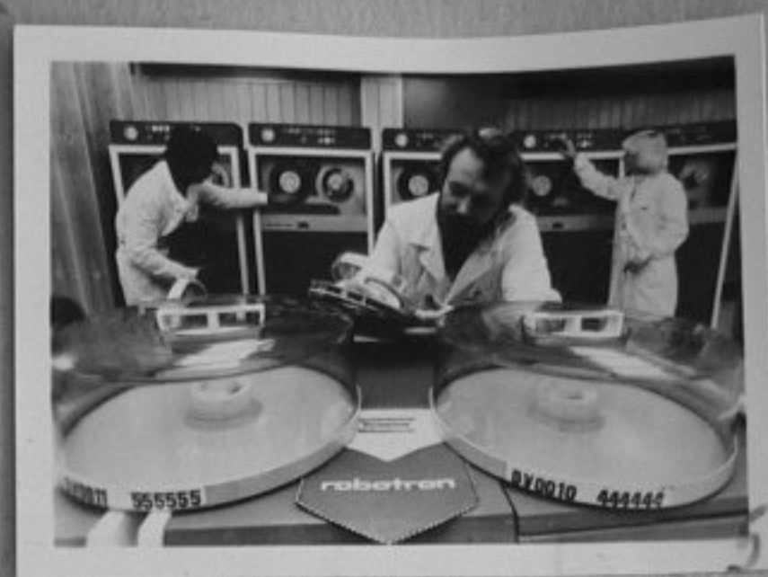
81-1383-5 Иржи Дедек/на преден план/приготвя магнитна лента. В дъното са стендовете с магнитните ленти, които представляват външната памет на ЕИМ "РОБОТРОН", монтиран в новия изчислителен център в Острава П. Бергер/МД
