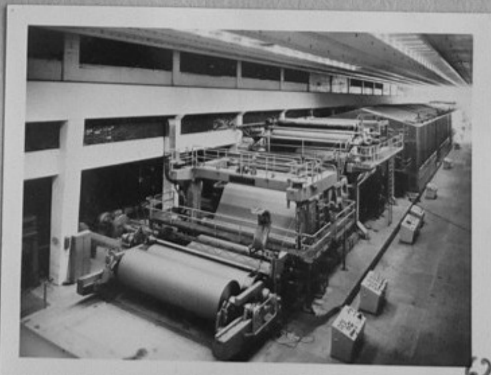
69-3756-62- А/О Енсо - Кутцейт фабрика Тайниокоски Вуоксенниска - монтирана картонена машина № 5, която произвежда 100,000 тона различни опаковачни картони. /репр./ XII
