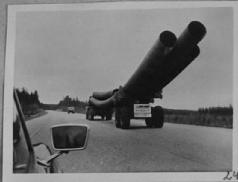
73-3863-24-Транспортиране на гигантски тръби с диаметър 70 см. за петролопровода СССР-Финландия. /репр. Б. Попов/ТК
