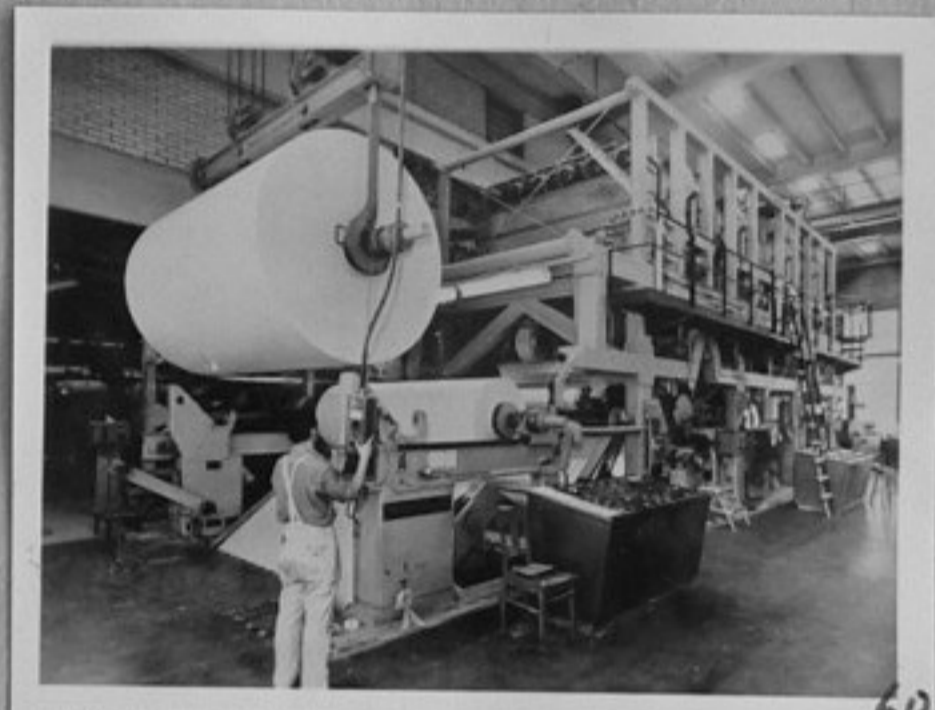
69-3756-60-Нова книжнооблицовъчна машина А/О метсялеитон - целулоза - Аанекоски - монтирана в целулозния завод. /репр./ XII
