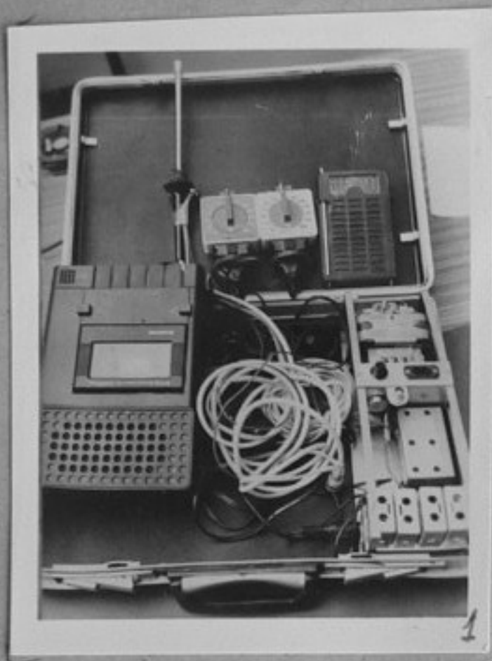
82-2655-1-Радиопредавателят, използван от радио "Солидарност", намерен от Силите за сигурност в Полша. Радиопредавателят е свързан с магнетофон и часовник./репр./ЛА
