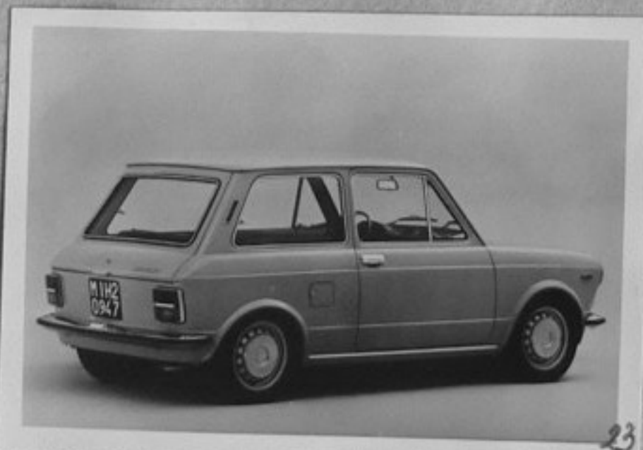
70-605-22, 23-Нов аутобианки А 112. Производство на ДЕЗИО. Ширина 1.48 м., дължина 3.23 м. Четириместен. широк багажник. /репр./ XII
