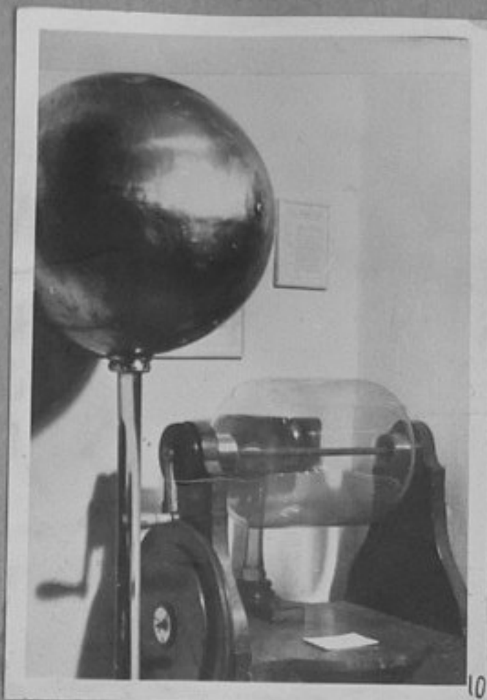
10-Кът от музея на М. Ломоносов в Ленинград. Електростатистически цилиндричен апарат, с който големият руски учен е правил своите опити.
