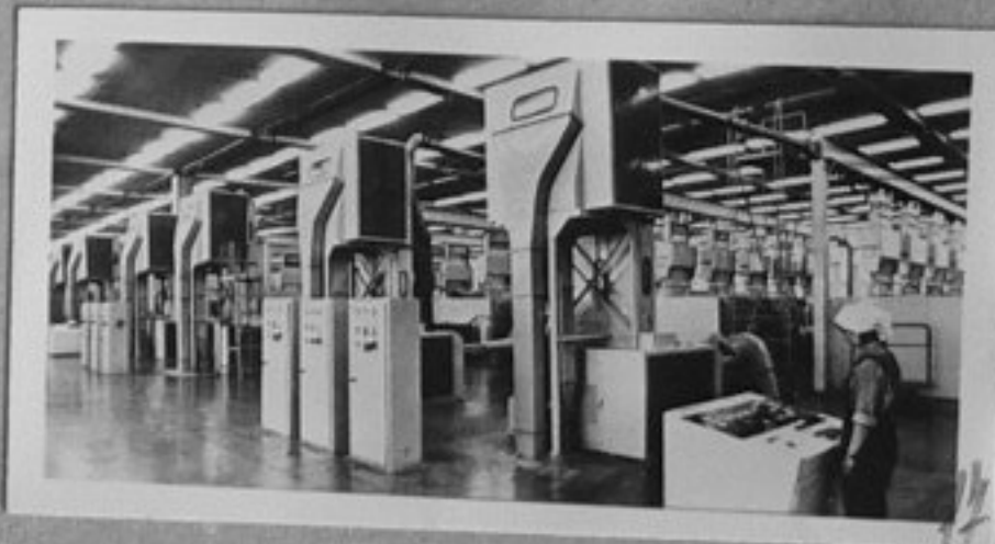
72-4805-17 - Един от цеховете на опитната автоматична фабрика за безвременно-пневно-механично предене в Москва. В нея целият технологически процес - от приготвянето на суровината до получаването на готовата продукция - е почти напълно автоматизиран, включително и транспортирането на суровината до машините и почистването на работната площадка. /репр./ЕИ
