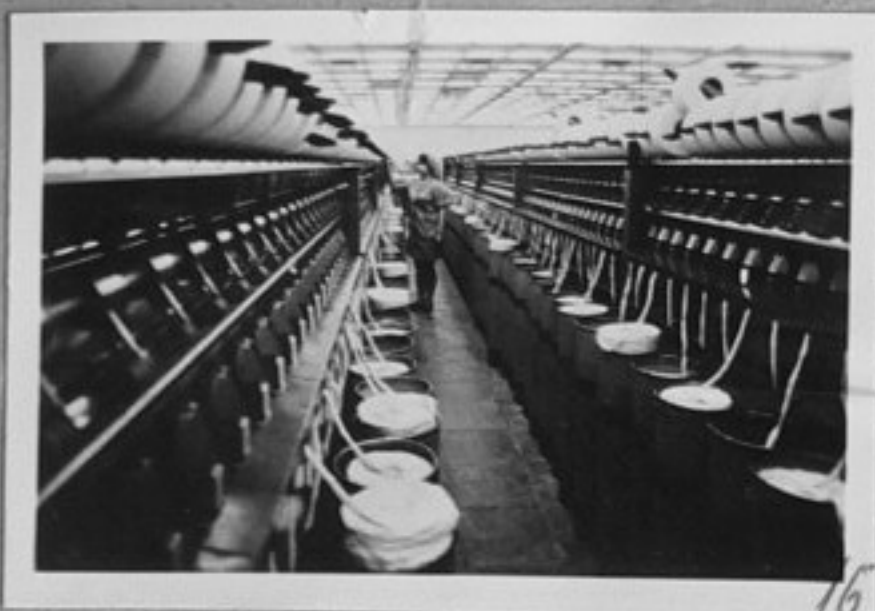
73-5745-16-Един от производствените участъци на автоматизираната ф-ка за безвретено предене "Автомат" в Москва, в който работят пневматични машини, създадени от съв. и чехослов. конструктори. / репр. П. Щерев/СС
