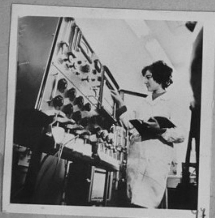
73-5593-47-СИБ.Инж.Н.Курочкина от лабораторията за адсорбции при Инж.институт работи с апаратура за определяне повърхността на катализаторите. /репр./ЛА
