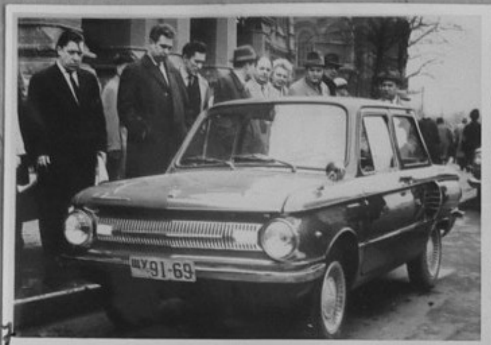
66/3984-7 - Новият модел малолитражен автомобил "Запорожец". Мощността му е 30 конски сили. /ЕИ 24/36
