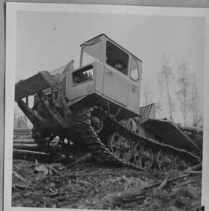
68-4472-12-Трактори ТДТ-54 предназначени за горската промишленост. /Т.Хорисян/ XII
