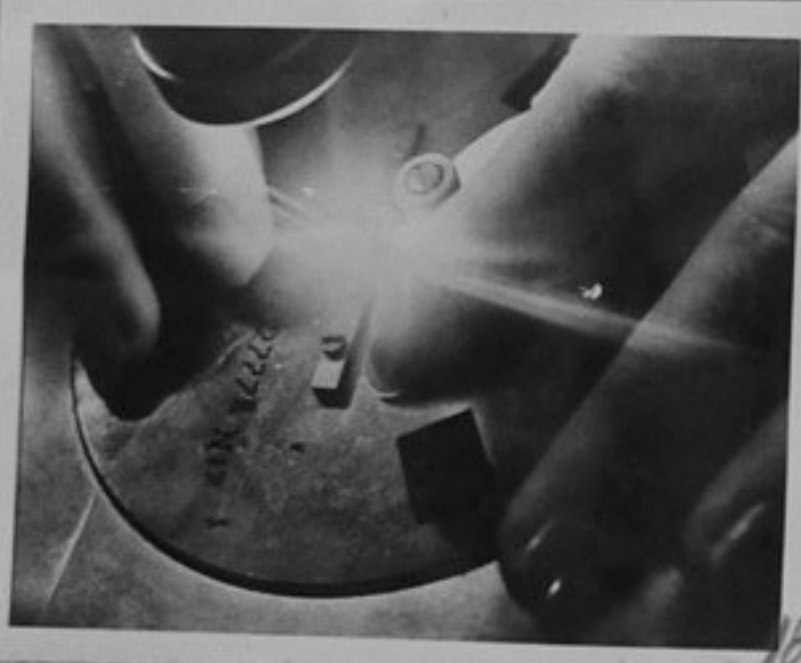
74-2179-13, 19-Контрол на радиалното и осево биене на часовниковите кола с помощта на микроскоп във Втори часовников завод. На преден план-контрольорът-Л. А. Полушкина. /Репр. П. Щерев/СС
