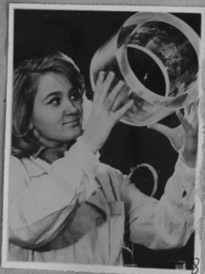
66/724-8-Пластмасов пръстен-повиден сцинтилатор. /24/36/ ММ
