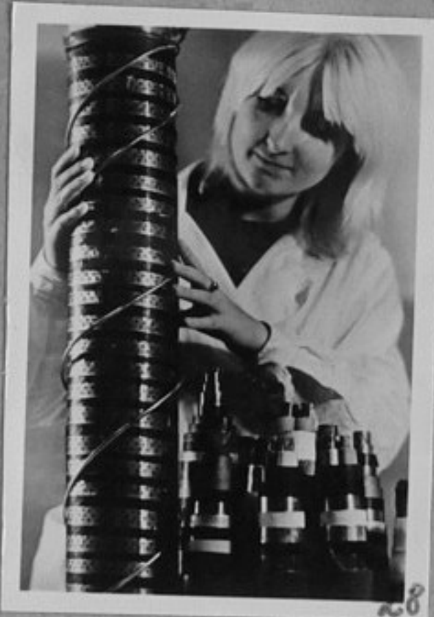
74-5165-28-Уникален масленапителен кабел, изчислен за напрежение 88 киловата, произвеждан в завод "Камкабел", Западен Урал. /Репр./, СС
