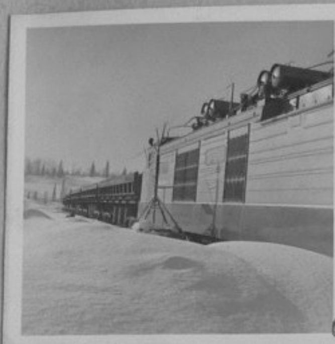
Каменовъглен басейн в Междуреченск - Южен Сибир. 75-782-8,9-Извозване на въглища с електровози, от открития рудник.
