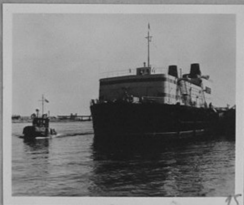
69-3365-15,16-Плаващата електростанция "Северно сияние", предназначена за снабдяване с енергия, топлинна и светлинна златните мини в Чукотка.
