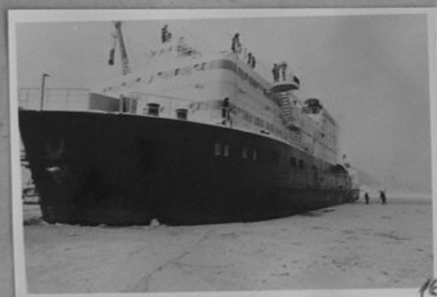
78-1463-16 Плаващата електроцентрала "Северно сияние" на кея на Тюменския корабостроителен завод. Тя е първата в страната електро-централа кораб, която е снабдена с мощни турбини, работещи с природен газ. Централата ще снабдява с енергия и топлина новите предприятия, строежи и сонди на Уренгоя, както и на работното селище репр./МД
