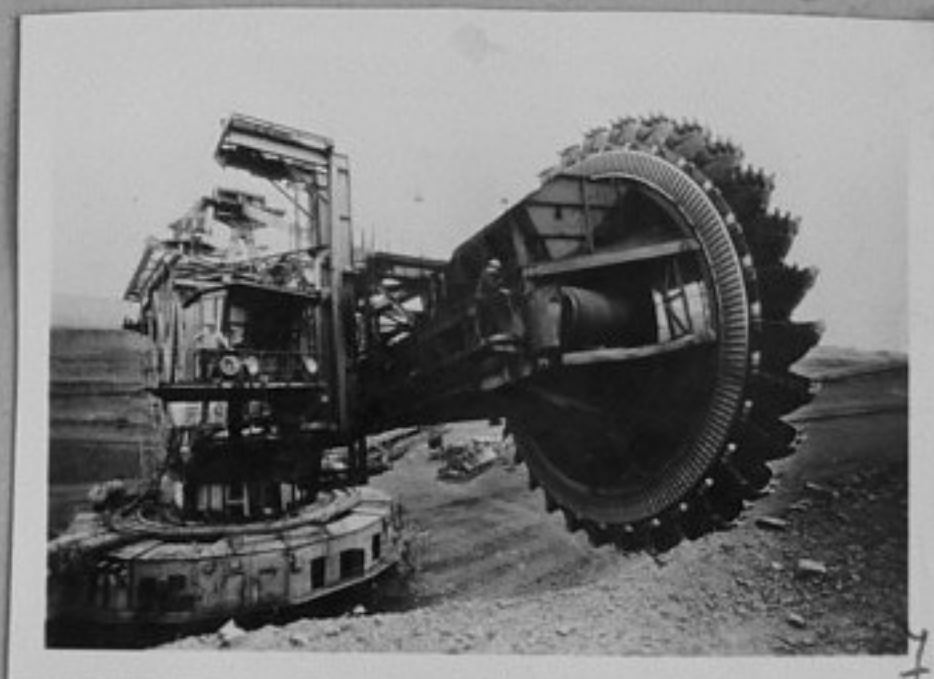
87-1233-7-Казахска ССР. Екибастуз-новият крупен въглищен разрез "Восточный". Подготвяне за работа на новия роторен ескаватор. /репр./ЛА
