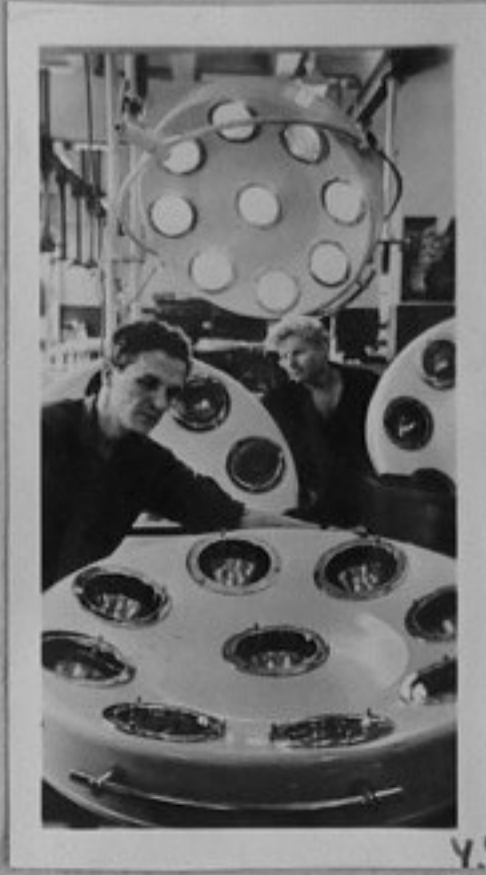
73-5593-46-СИБ. Монтаж на много-горелковни операционни осветителни тела в Свердловския завод за електромедицинска апаратура. /репр. П. Щерев/ЛА
