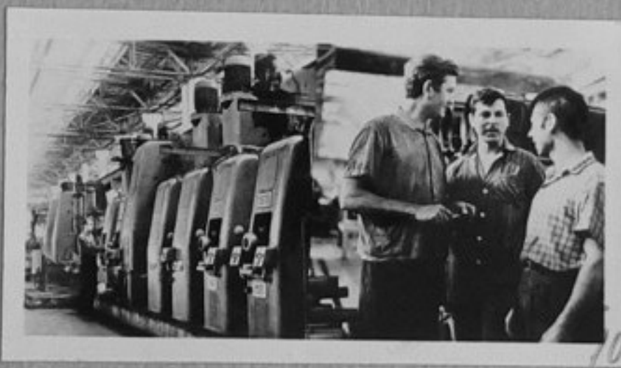
72-4805-10 - Автоматичната линия за обработка на корпусите на електромоторите в Бакинския електромашиностроителен завод. /репр./ЕИ
