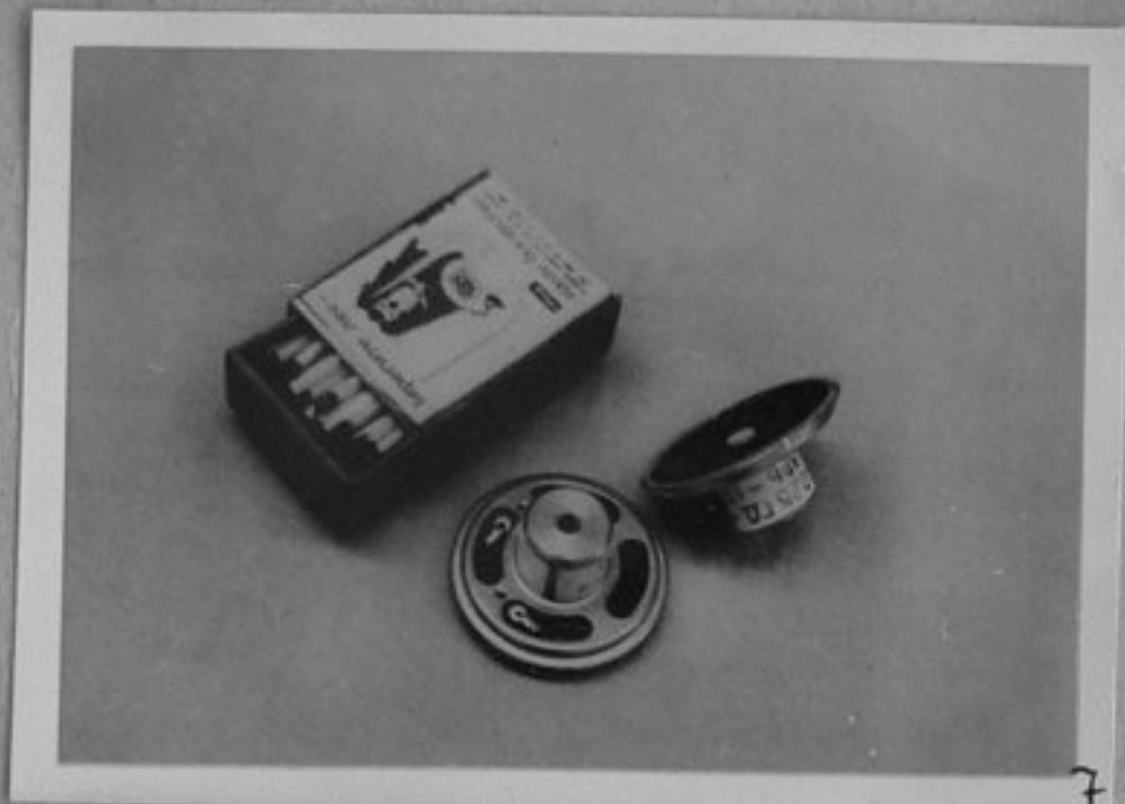
67/345-7 -- Миниатюрен високоговорител за джобни радиоприемници, производство на Бердския радиозавод. Високоговорителят е с диаметър 40 мм. и височина 16 мм. и лесно се побират в кибритена кутийка. /ЕП 24/36
