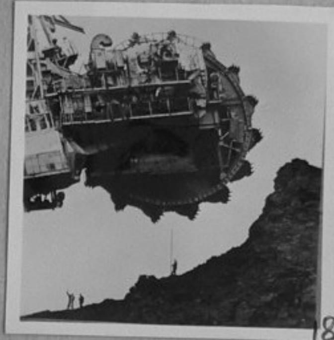
77-3226-18 Невеоткритият въглищен басейн "Богатир". Тук работи роторният ескаватор с мощност 5000 тона въглища в час репр./МД
