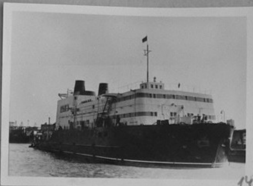
69-3365-14-Плаващата електростанция "Северно сияние" в пристанището на Тюменския корабостроителен завод.
