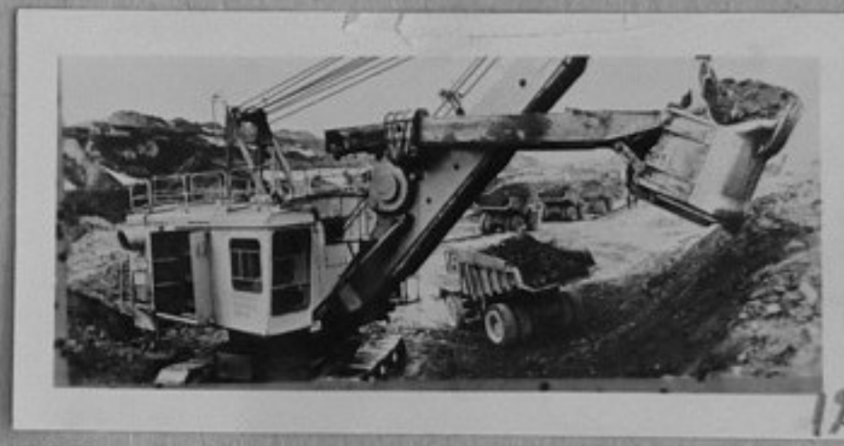
73-3231-12-Товарене на камени въглища чрез ескаватор "ЕКГ-8И" в Черниговския комбинат "Камеровоугол". /репр.П.Щерев/ТК
