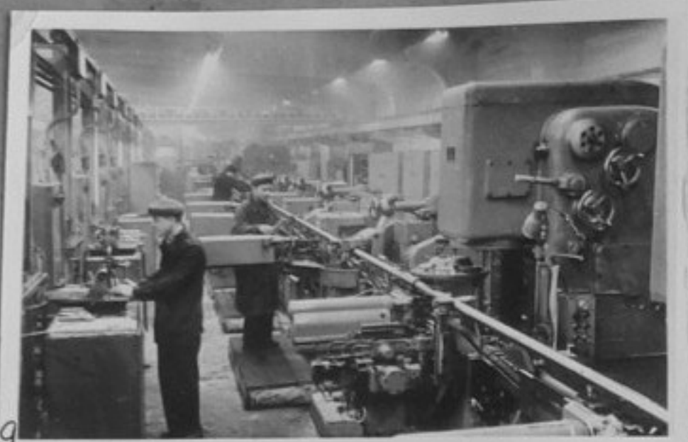
9-Автоматическая линия за изработване на зъбчати козела, с която е съоръжен завод за металообработващи машини "Красний пролетарий" в Москва. С тази автоматизация производството се увеличава три пъти.
