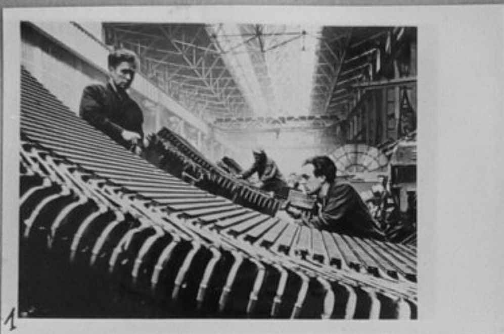
1-Ленинград. Колективът от хидрокорпуса на завода "Електросила" - С.М. Киров, се готови за достойна среща на XXII конгрес на КПСС. На снимката: И.Щетов и А.Хужин намотават статори на хидрогенератора за Уч Курганската ВЕЦ.
