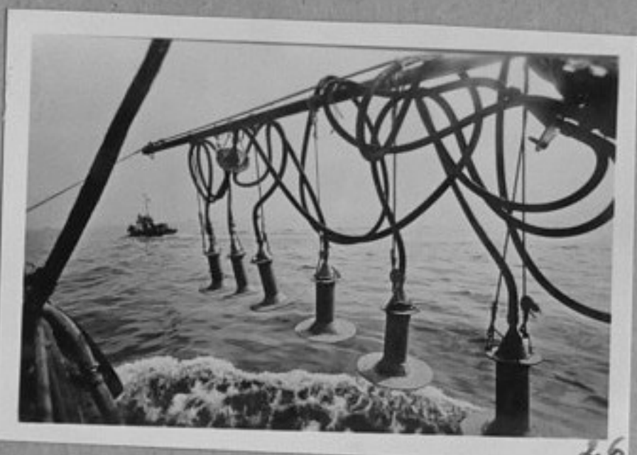
74-543-26-Газови детонатори, готови за спускане в морето. Чрез тях се образуват сеизмически вълни/детонация на газ-ови смеси/и се прави сеизмическо проучаване на морското дъно без взривове. /репр. П. Щерев/ЛА
