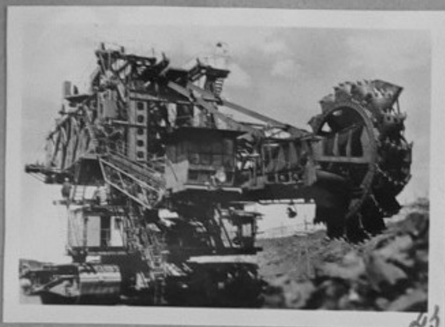
73-5745-23-Един от ескалаторите за открита разработка на въглища, създадена от машиностроителите на ГДР за Казахска ССР. /Репр. П.Щерев/СС
