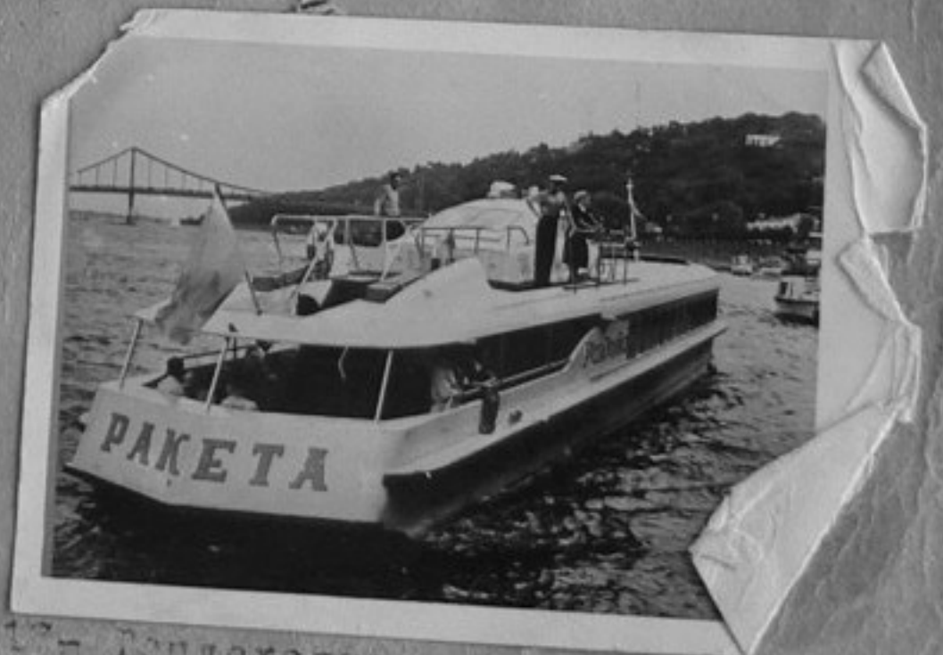
16- Нов модел пътнически топлоход на подводни крила "Ра-к-е-т-а". Топло- ходът е направен от д. алуминий и има 50 кресла, развива скорост до 60 км в час.
