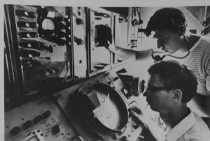
73-3911-19-Операторите на радиолокационните съоръжения определят характеристиката на ръста на градоносните облаци. /репр.П.Щерев/ТК
