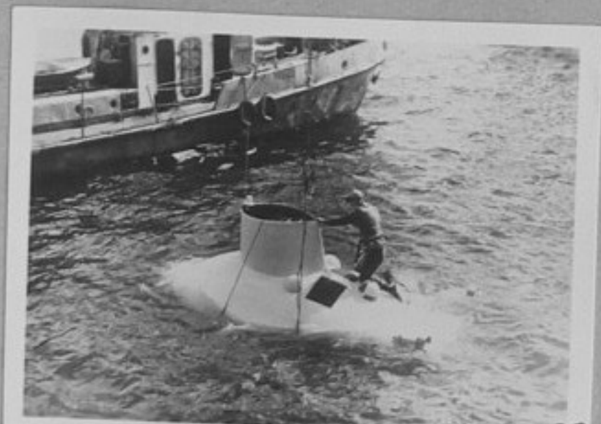
78-670-29 Батискафът "Шелф-І", разработен и конструиран от сътрудниците на Далеккоизточния университет във Владивосток. Апаратът с екипаж от двама души може да се гмурне на 500 м. дълбочина и развива при движение скорост повече от 5 клм. в час. Може да остане под водата 36 часа репр./МД
