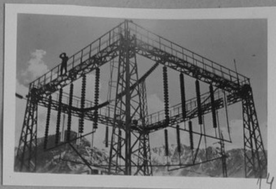
86-111-14-Стенд за продължителни изпитания на линейна изолация и проводници във високопланинската научно-изследователска станция. /репр./ЛА
