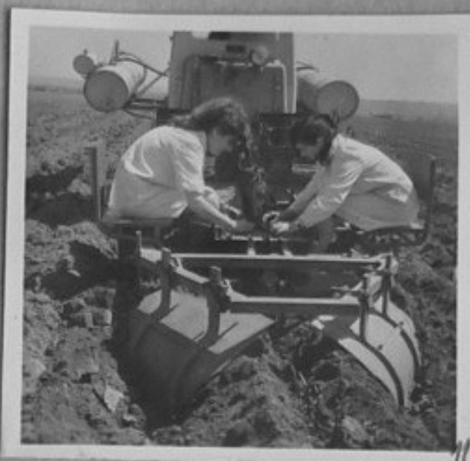
70-1279-11-Машина за засаждане на лози в коренилища - лозаровинарски и-тут в Плевен. /Л.Чаръкчиев/ ХП
