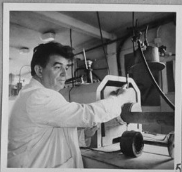
74-2699-3,5,10-Универсална индукционна уредба за оксидиране -създадена от авторски колектив с инж. Марков от НИИКИЕМ по електропромишленост. /А.Бояджиева/ТК
