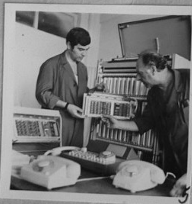
73-128-5,8-Инж.Емилия Ташева, инж.Николай Малезанов и инж.Христо Ковачев - колектив с ръководител К. Арабаджиян, конструирал апаратура за предаване на данни със скорост 600 или 1200 бит/сек - АПД-1200. /Д.Рогев/ИК
