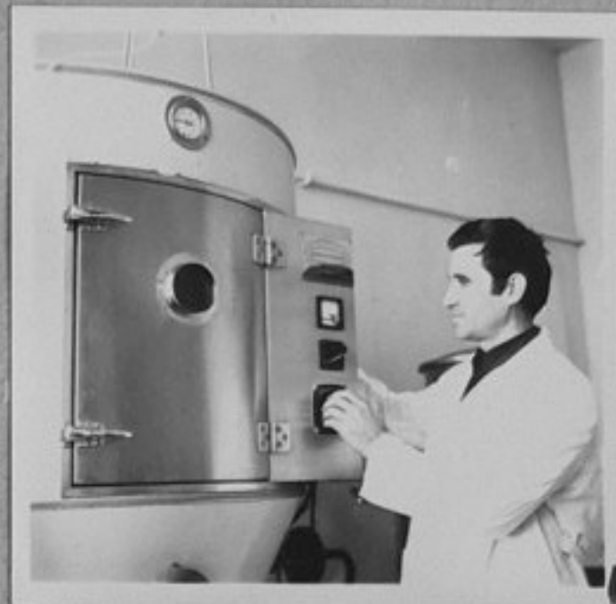
70-4512-1-Ив. Пенелски, технолог в института, в момента работи със сушилна за сухо кисело мляко и сух сладолед. /Л. Златков/ ХП
