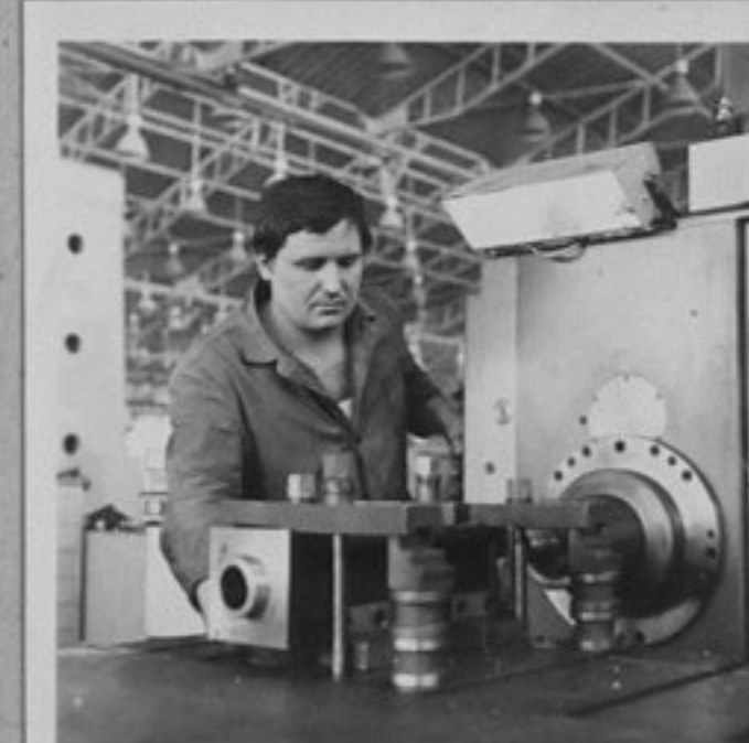
80-3501-8 Стефан Стефанов работи на "борверг" с цифрово управление, произв.на фирмата "Варнсдорф" - ЧССР
