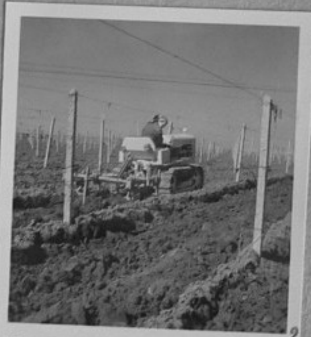
70-1216-2,8-Трактористката Божана Раданова, извършва риголване с приспособление за отгребване защитната зона в лозята. /Люб.Чаръкчиев/ XII
