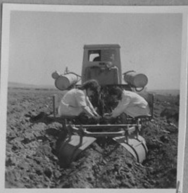
70-1279-1-Машина за засаждане на лози в коренилища - лозаровинарски и-тут в Плевен. /Л.Чаръкчиев/ ХП
