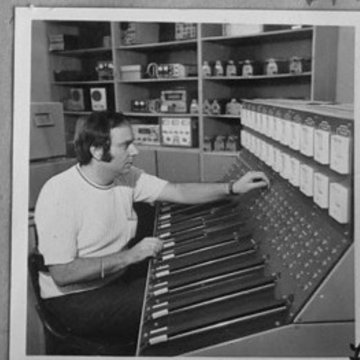
77-2386-7-Инж.Теодор Атанасов, отг.инструктор извършва настройка на устройството за еталонаж и изпитване на маломощни захранващи блокове за ЦПУ тип програма. /В.Балевска/ЛА
