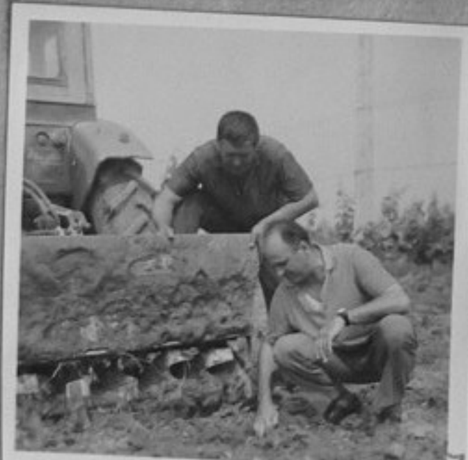
70-2574-7,8-Регулиране работната дълбочина на фреза с трактор "Белорус". /Лало Златков/ ХП
