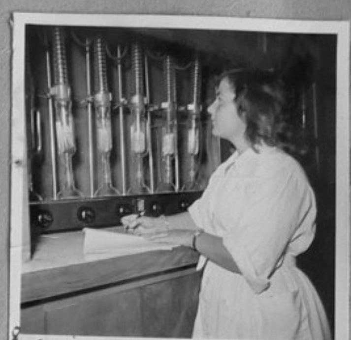
8-Лаборантката Г.Пърлева определя маслеността на кълнчогледа.
