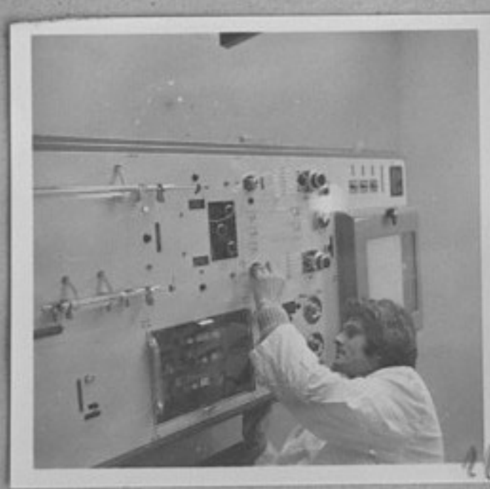
79-592-9-Лаборатория "Овцевъдство"-лаборантката Ели Ивайло-инж.химик чрез аминокиселинен анализатор определя гъстотата на вълна-винния състав на фуражи, кръв и белтъци. /Х.Румян/ЛА
