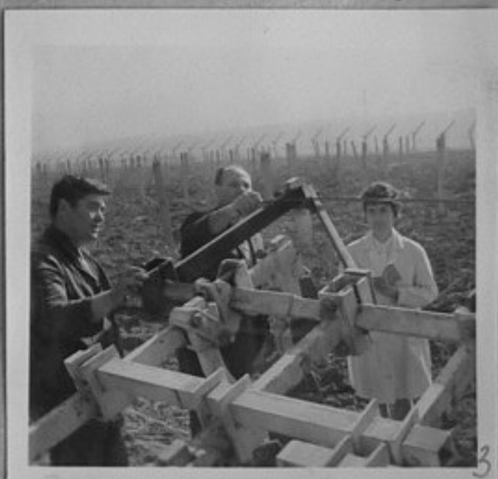
70-1278-3-Навесна машина за извършване на всички видове обработки в лозя. /Люб.Чаръкчиев/ XII
