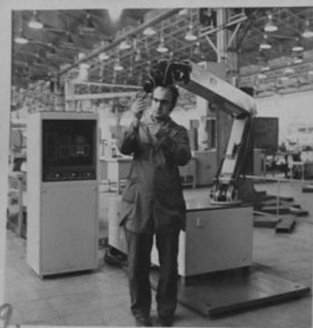
80-3503-9 РБ-211 - бояджий- ски робот.По него работи бригадир ел.монтьор Геор- ги Дамянов Ем.Богоев/МД
