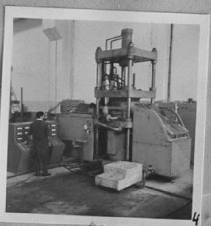
68-4012-4,8-Леене на метали с противовъздушно налягане по методите на проф. Балев. /Л. Чаръкчиев/ XII
