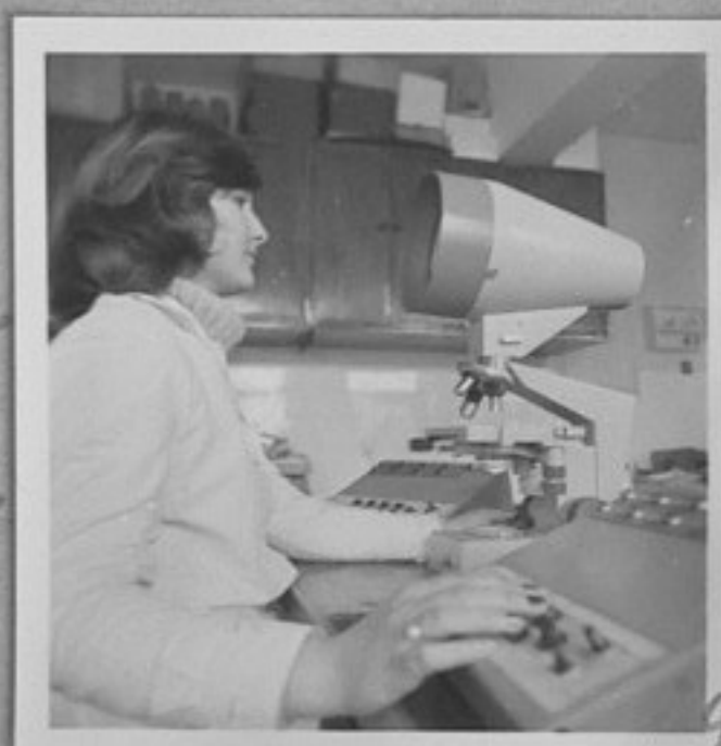
79-592-9-Лаборатория "Овцевъдство"-лаборантката Ели Ивайло-инж.химик чрез аминокиселинен анализатор определя гъстотата на вълна-винния състав на фуражи, кръв и белтъци. /Х.Румян/ЛА
