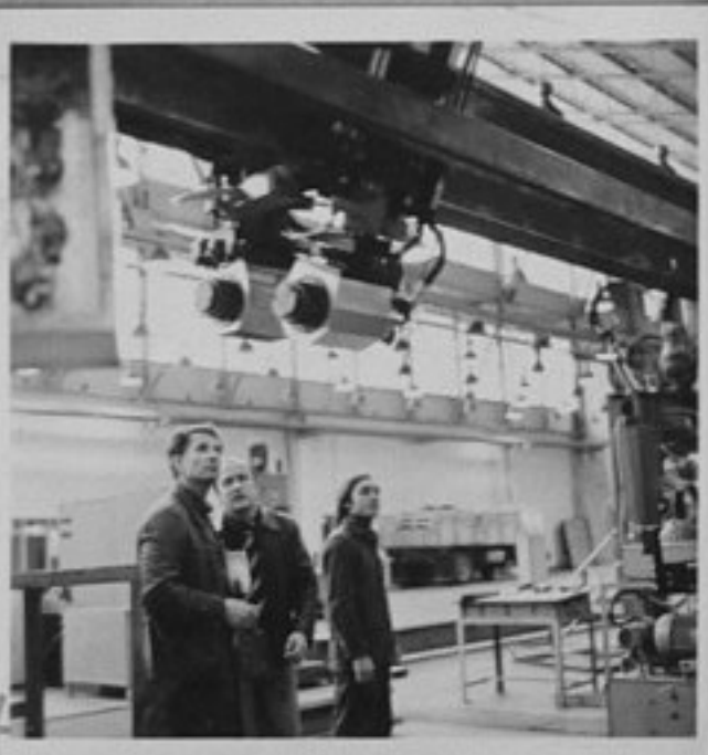
80-3502-7 Портален манипулатор от серия 520 с обръщащо устройство в момент на изпитание Ем. Богоев/МД
