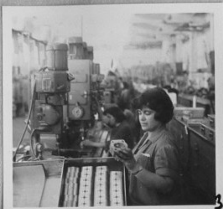
68-1933-3,4,6- На конвейера за производство на тела за зъбни помпи./Крум Арсов/СС
