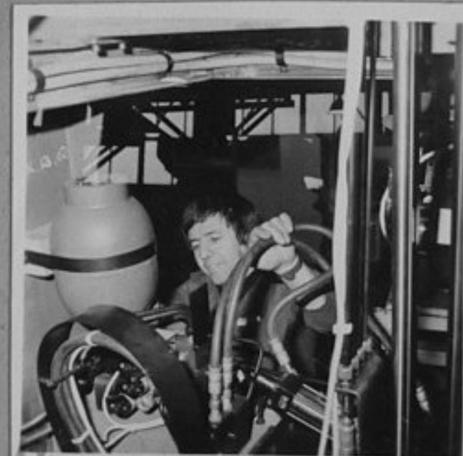
80-3502-12 Вълчо Станчев извършва монтаж на портален манипулатор от серия 520 Ем. Богоев/МД
