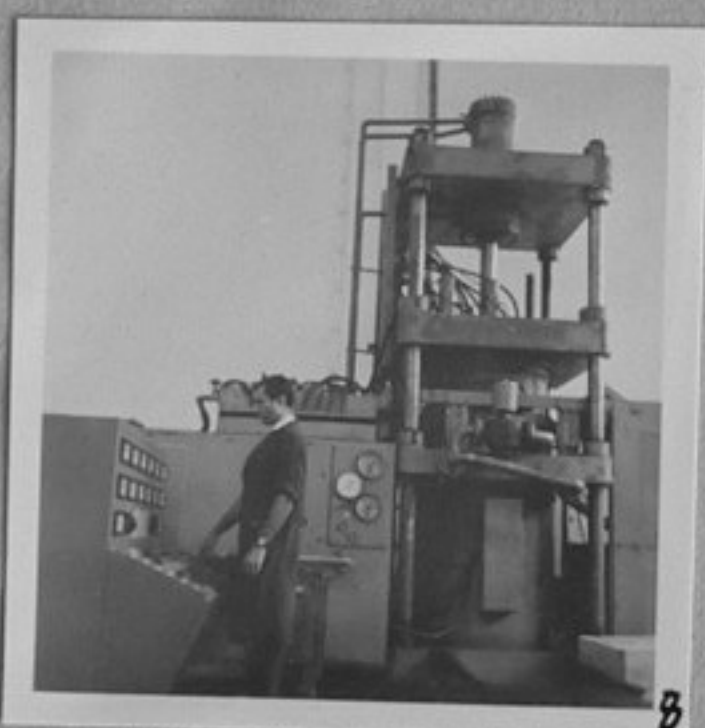
68-4012-4,8-Леене на метали с противовъздушно налягане по методите на проф. Балев. /Л. Чаръкчиев/ XII
