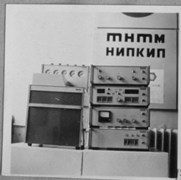
74-1606-13-Лабораторен газов хроматограф "Термохром" 23, дело на колектив с ръководител н.с.инж.Л.Стойков. /А.Цанков/ТК
