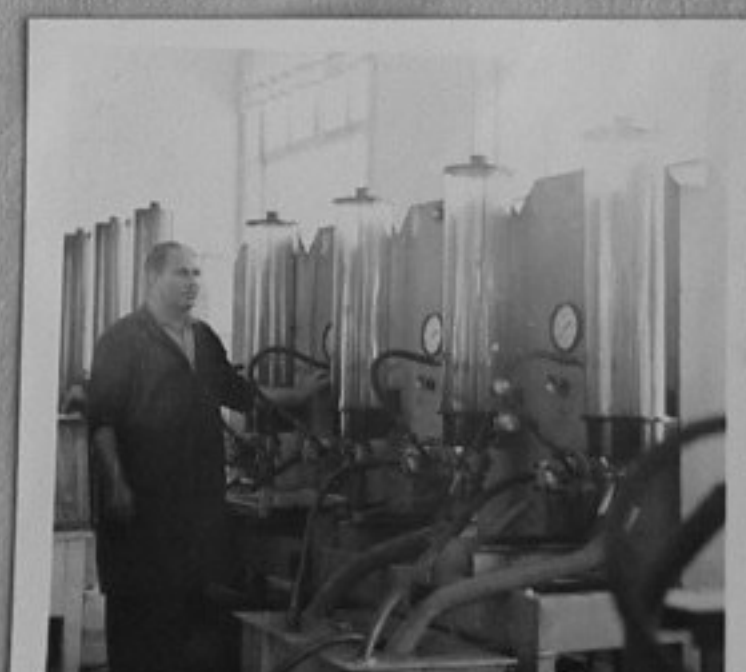
68-1939-19-Стенови установки за изпитване на хидравлични зъбни помпи за високо налягане./Кр.Арсов/СС
