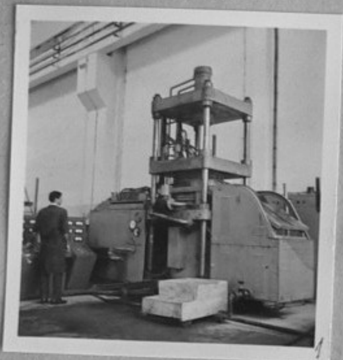
68-4012-1,2,3-Леене на метали с противовъздушно налягане по методите на проф. Балев. /Л. Чаръкчиев/ XII
