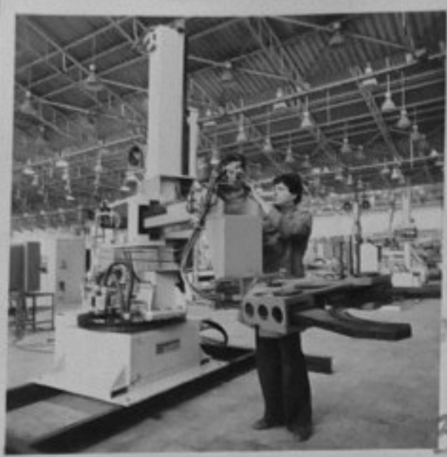
80-3503-3 РБ-234 пред- назначен за съвместна работа на два или повече различни видове машини с тегло на детайла 500- 800 кг. Ем.Богоев/МД
