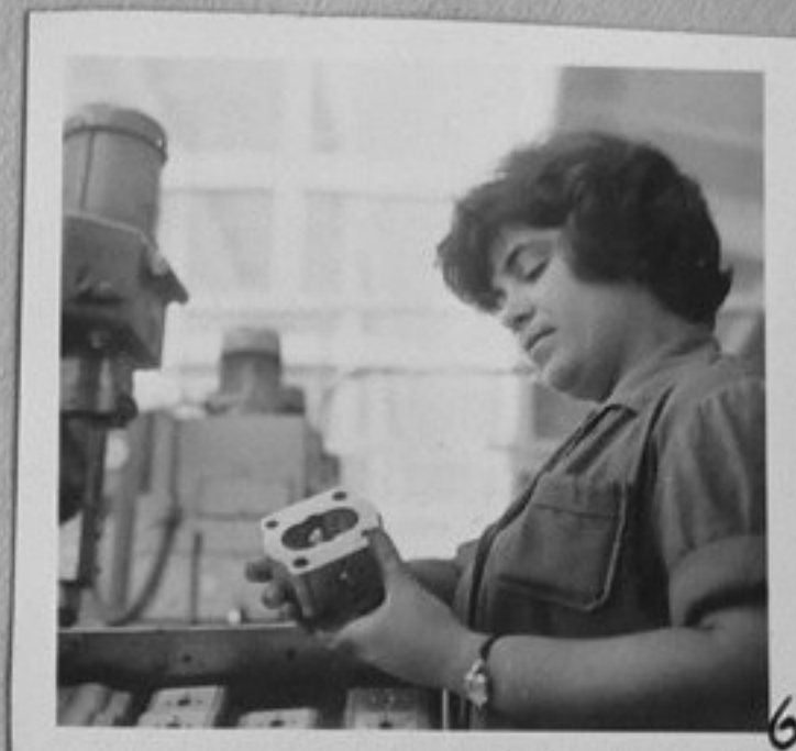
68-1933-3,4,6- На конвейера за производство на тела за зъбни помпи./Крум Арсов/СС
