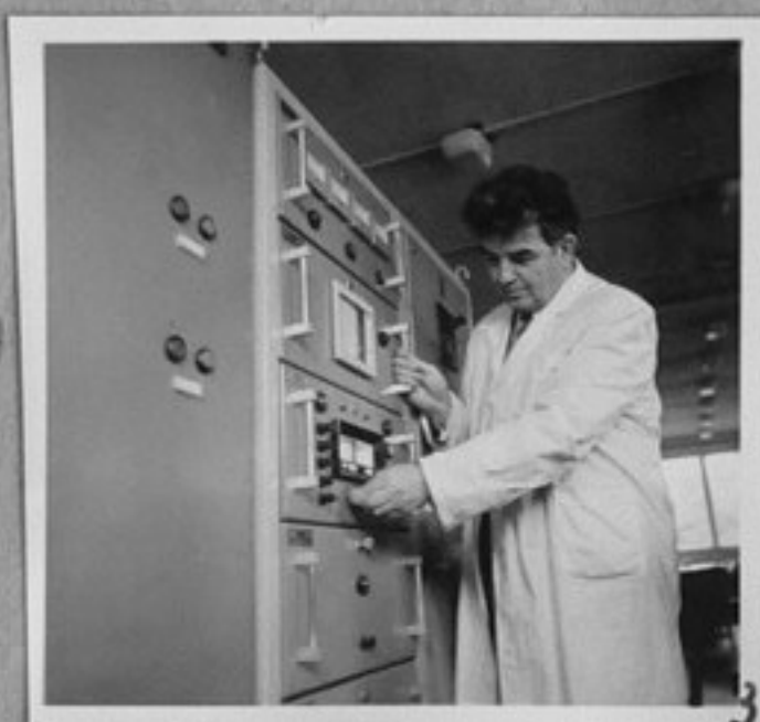
74-2699-3,5,10-Универсална индукционна уредба за оксидиране -създадена от авторски колектив с инж. Марков от НИИКИЕМ по електропромишленост. /А.Бояджиева/ТК
