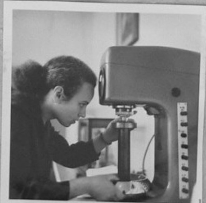
73-2076-2-Дипломантката Л.Алексијева измерва твърдостта на стоманата. /В.Иванова/МК
