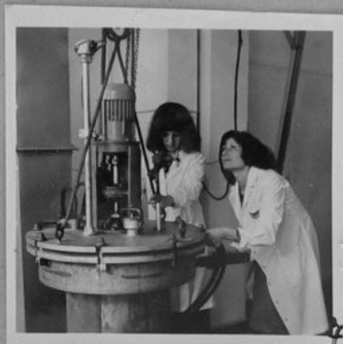
76-1660-5,7-Лаборатория за химико-термично обработване на металите - цех за нискотемпературно газово карбонитриране. /Р.Парушев/МК
