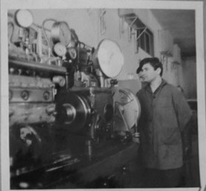
70-1694-11-Определяне хидравлическата характеристика на разпръсквачи на дюзи на дизелови двигатели в лабораторията по изпитване на двигатели. /Д.Рогев/ ИК
