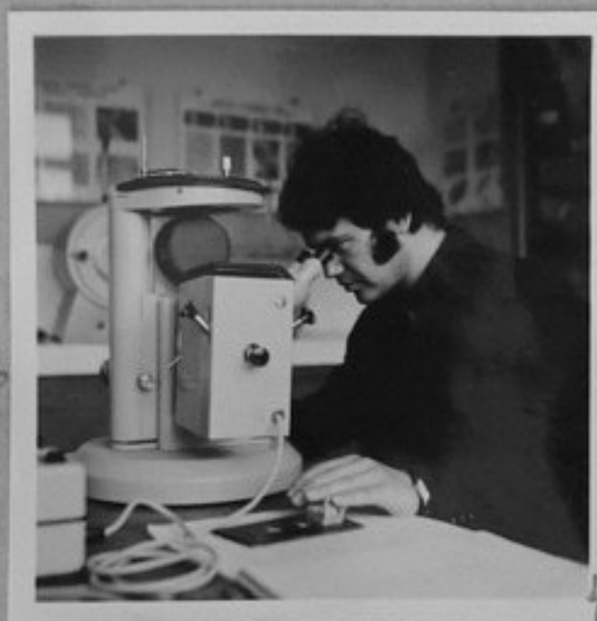
73-2076-4,5-Дипломантът Х.Тонков изследва карбидна нееднородност на стомана Р-18 във връзка с дипломната си работа. /В.Иванова/МК
