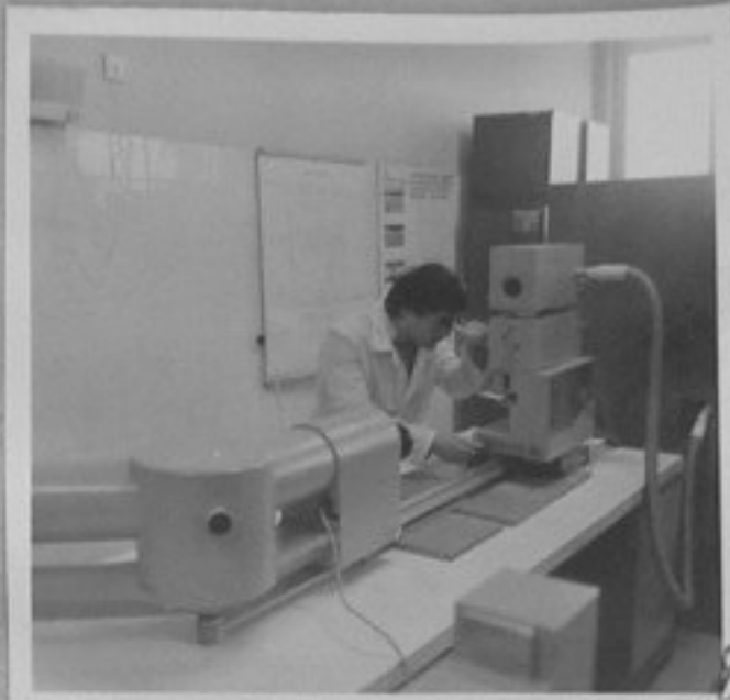
86-336-8-Лазарен микроспре- ктрален анализ./М.Топалова/ЛА
