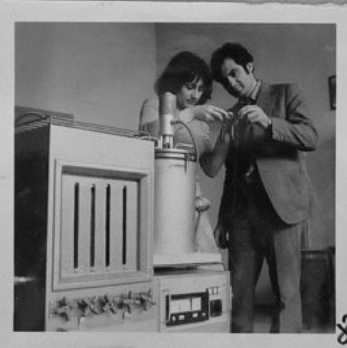
76-1661-6,8-Инж.Р.Русев и аспирант инж.Сл.Хари-занова при лабораторната уредба за комплексни нитридни процеси. /Р.Парушев/МК
