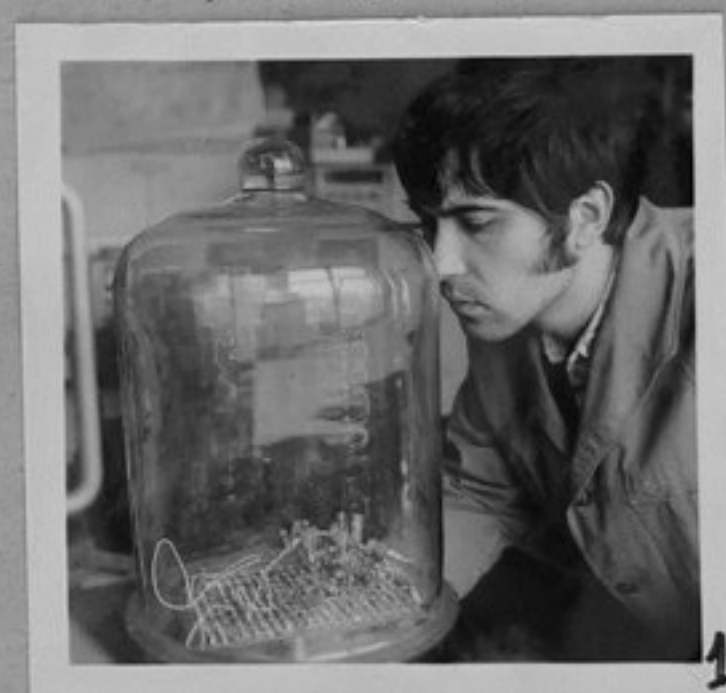
76-1663-6-Дипломантът В.Стоянов изработва релеен блок за комутация към автоматична справочно-информационна уредба за телефонни услуги/АСИУ-ТУ-18/. /Р.Парушев/МК
