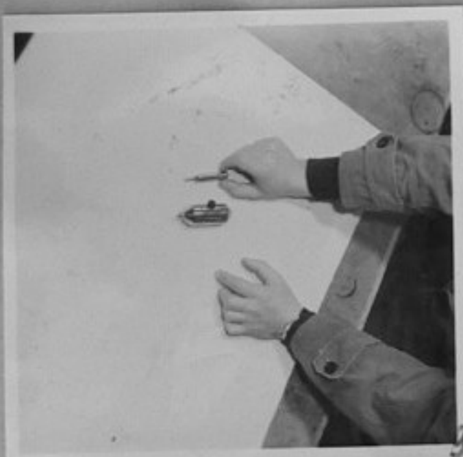
70-5798-9-Динамометър за измерване на сили при струговане. /Л.Златков/ XII
