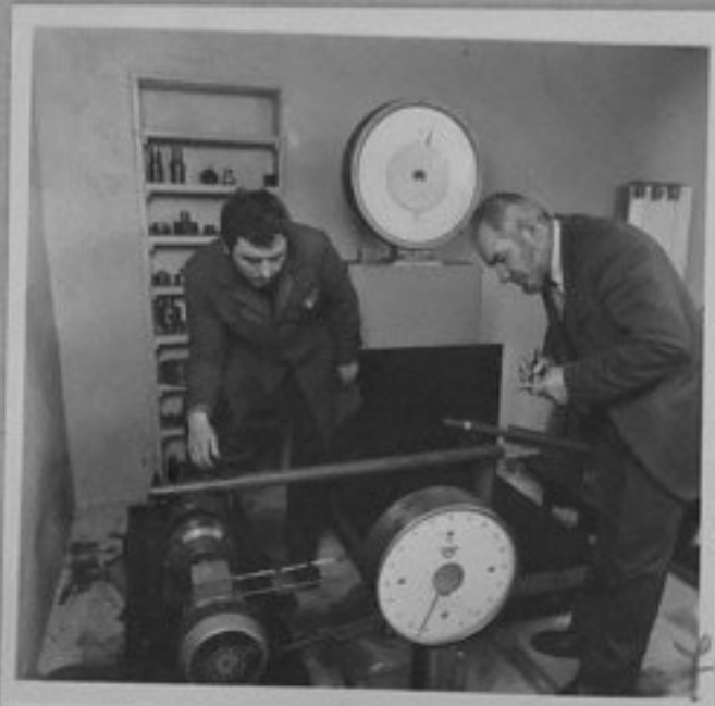
84-239-7-Висше техническо училище "А.Кънчев" - Русе. Проф.Димитров и н.с.Д.Иванов правят изпитание за надежност на вълнов редуктор. Е.Любомиров/ЛШ
