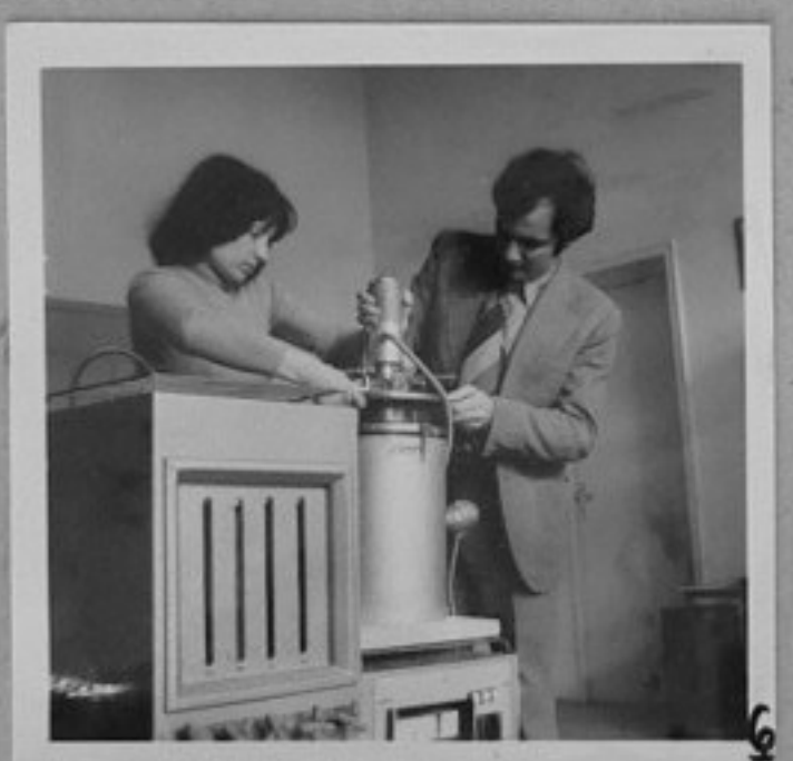
76-1661-6,8-Инж.Р.Русев и аспирант инж.Сл.Хари-занова при лабораторната уредба за комплексни нитридни процеси. /Р.Парушев/МК
