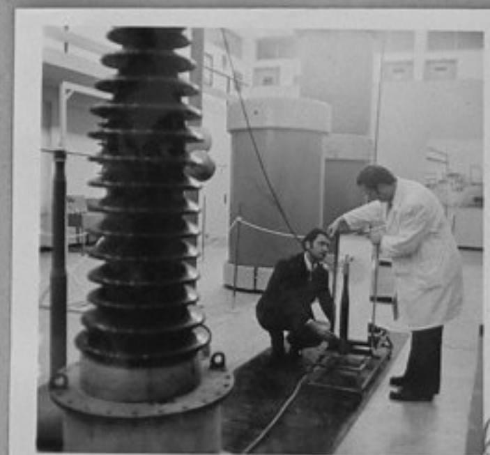
76-204-6-Георги Ушев - ст. асистент и Анг.Илиев - асистент подготвят изпитателната уредба 620 KV в лабораторията "Техника на високите напрежение" при института. /Р.Парушев/ИК
