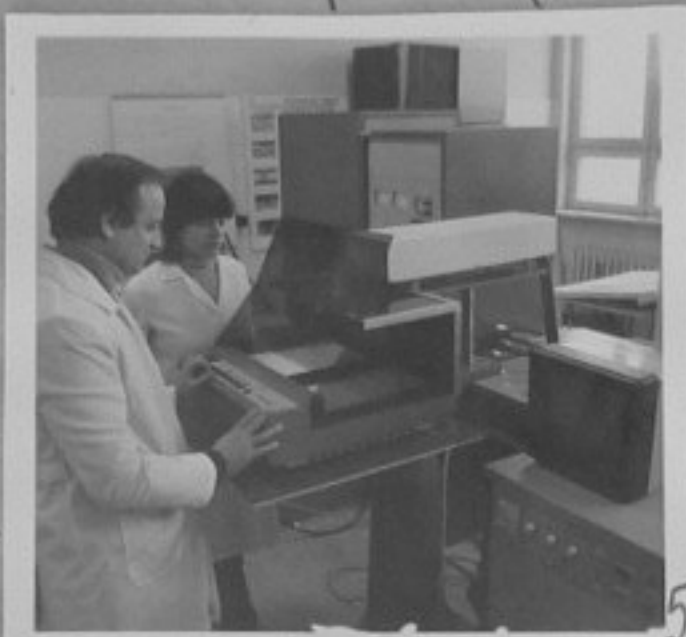
86-336-5-Лазерна технологична установка за маркиране. М.Топлаова/ЛА
