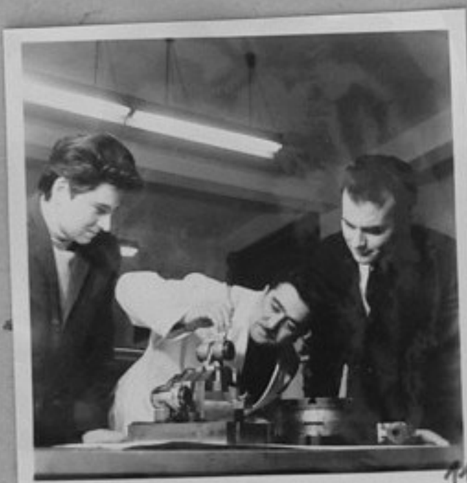
70-5798-11-Работа с динамометри за измерване на сили при свердловане и струговане. /Л.Златков/ XII
