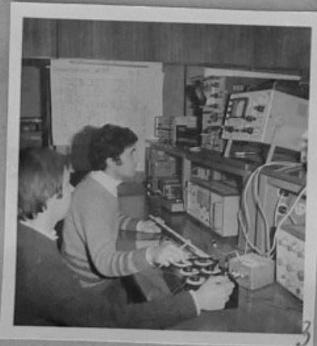
86-347-3-ВМЕИ-Габрово. Ком- плексно устройство за кон- трол и търсене на вътъка в тъкачните станове. М.Топалова/ЛА
