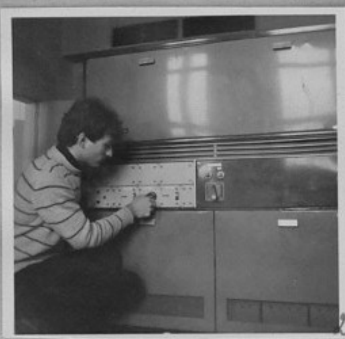
86-337-2-Високотемператур- на пещ за дифузия в полупро- водници. /М.Топлаова/ЛА
