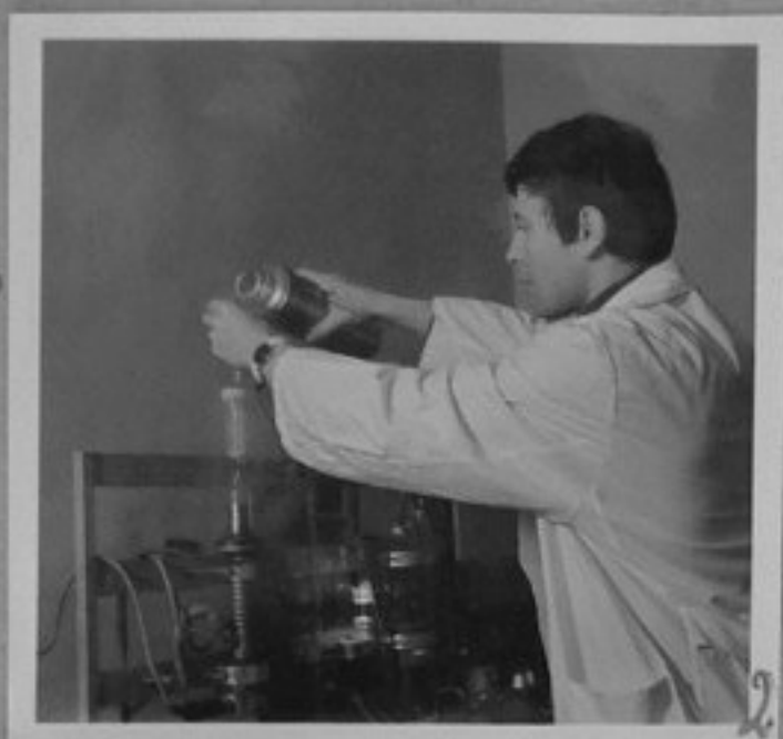
70-798-2-Младият специалист Колю Николов работи на установка за вакуумно дестилационно пречистване на кадмий. /Н.Чобанов/ ИК
