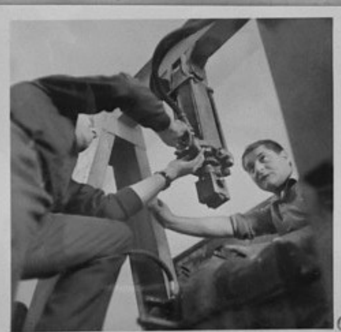
70-1695-9-Стенд за изпитване на материали за зъбни кола на контактна умора в лабораторията по технология на металите. /Д.Рогев/ ИК
