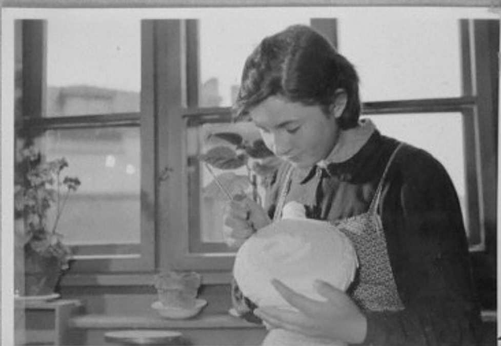
56/1017-2,3 - Техникум по керамика и стъкло. Нанасяне на цветна глазура и почистване на пластичната украса. /Страхинов/ ЕИ
