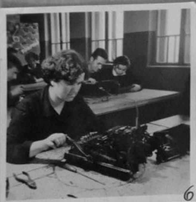
6 - Механотехникума, София. Поправка на събирателна машина "Райнметал".
