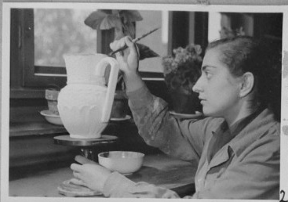
56/1017-2,3 - Техникум по керамика и стъкло. Нанасяне на цветна глазура и почистване на пластичната украса. /Страхинов/ ЕИ
