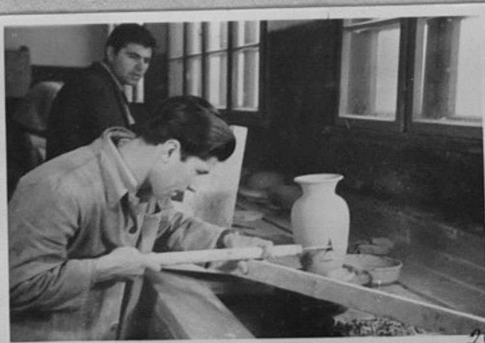
53/2914-Техникум по керамика и стъкло. /Здр. Добрев/ БИ 20 - Престъргване на вазач 24/36
