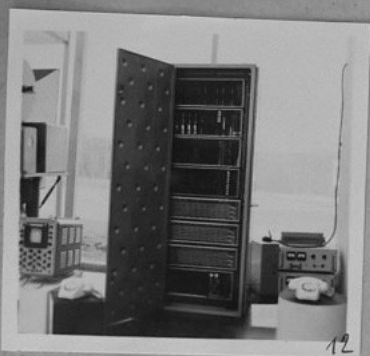
66/432-12 - Автоматична телефонна централа с електрическо управление.
