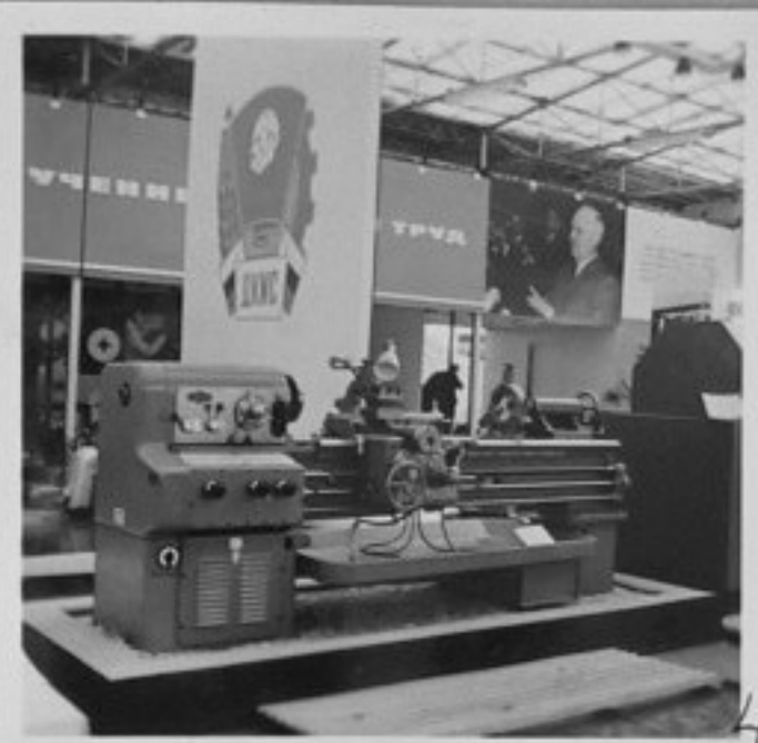
66/432 - Изложба на младежкото техническо творчество и майсторство - София. /Юскеселиев/ ЕИ 4 - Универсален струг С 11 М - нова конструкция.
