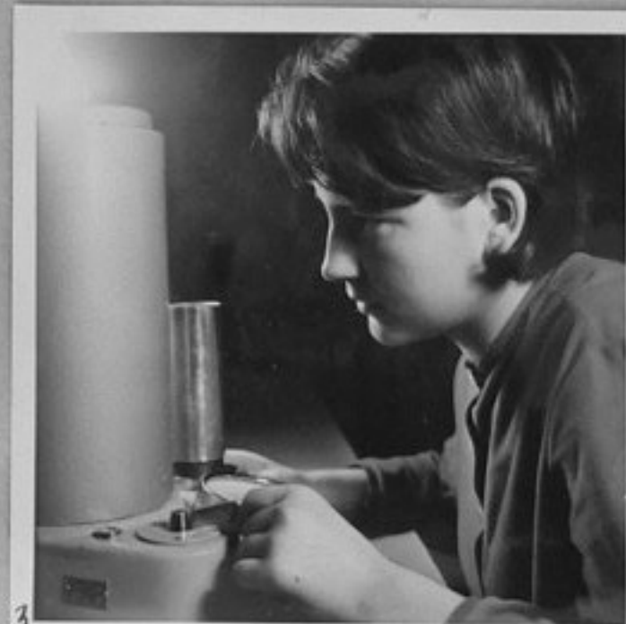
66/3493-3 - Венера Славчева от I-ви В курс работи на уред за изпитване на газопроницаемостта на сместа. /Чаръкчиев/ЕИ
