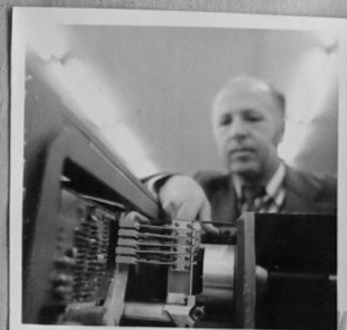
75-1334-3,10,11-Инж. Живко Паскалев прави настройка на плаващи магнитни глави с помощта на контролен дисков пакет. /Б. Юскеселиев/ТК
