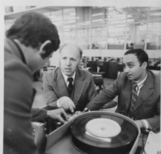
75-1452-10-Инж. Ж. Паскалев и инж. Ив. Иванов правят настройка на дискови за помнящи устройства с контролни дискови пакети. /Б. Юскеселиев/ИК
