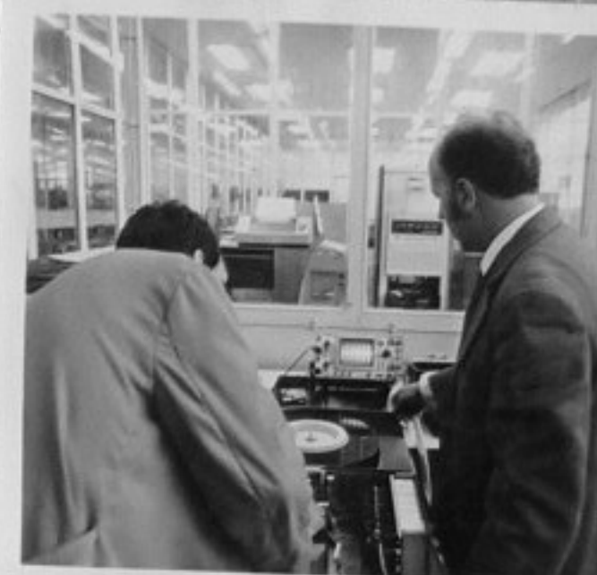
75-1452-7-Инж. Ж. Паскалев и инж. Ив. Иванов правят настройка на дискови за помнящи устройства с контролни дискови пакети. /Б. Юскеселиев/ИК
