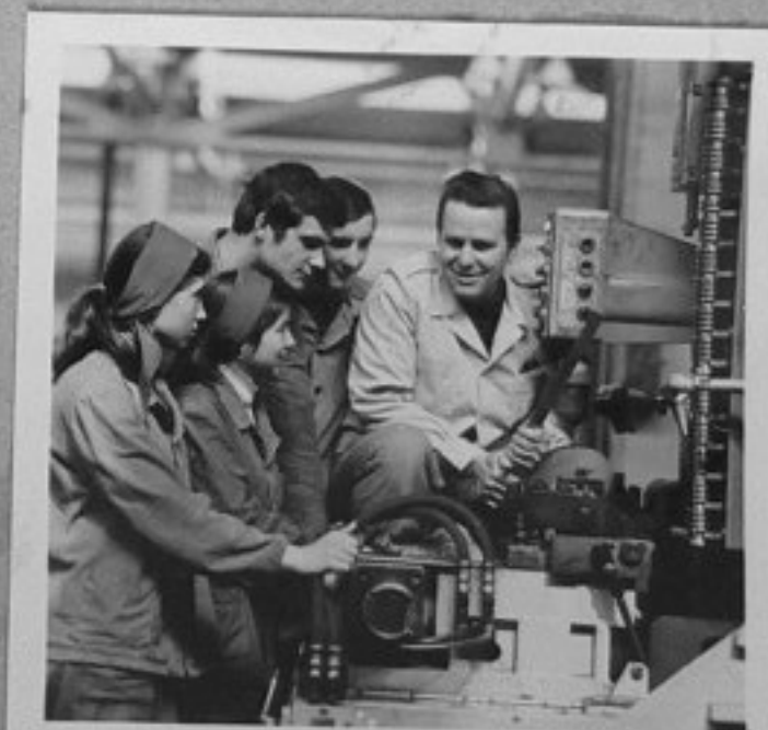
76-684-6-П. Брайков по време на работа на съветската протяжна машина за обработване биелите на двигатели "Перкинс". /Р. Парушев/ИК
