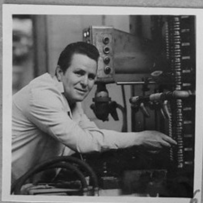
76-684-6-П. Брайков по време на работа на съветската протяжна машина за обработване биелите на двигатели "Перкинс". /Р. Парушев/ИК
