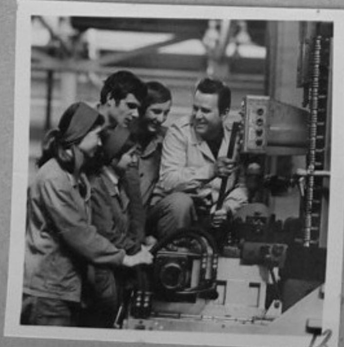
76-684-6-П. Брайков по време на работа на съветската протяжна машина за обработване биелите на двигатели "Перкинс". /Р. Парушев/ИК
