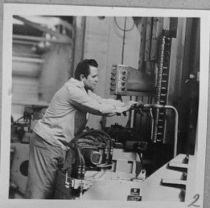
76-684-2,3,5-Петър Брайков - герой на социалистическия труд, работи на съветската протяжна машина за обработване биелите на двигатели "Перкинс" /Завод за дизелови двигатели "В. Коларов"-Варна/. /Р. Парушев/ИК
