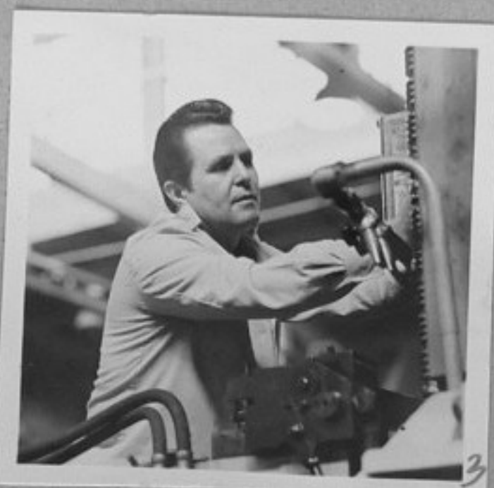
76-684-2,3,5-Петър Брайков - герой на социалистическия труд, работи на съветската протяжна машина за обработване биелите на двигатели "Перкинс" /Завод за дизелови двигатели "В. Коларов"-Варна/. /Р. Парушев/ИК
