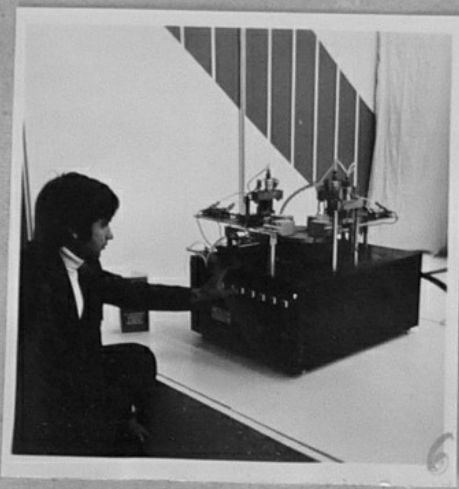
79-3899-6 Стенд за автома- тизация на монтажа. Служи за сглобяване на изделия с малки размери. Изработен от кол. с ръковод. проф. к.т. н. Вл. Гановски/катедра "Автоматизация на дискретно производство" Вес. Димитров/МД
