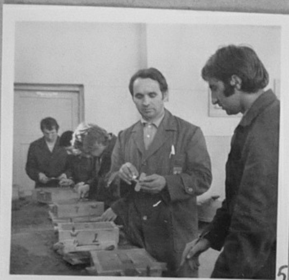
75-784-5,9-Курсисти от техникума с преподавател Л.Цоловски формоват модели с неправилна отделителна линия в леярната на техникума. Ботевград. /Н.Хлебарова/ИК 75-784-13-Преподавателят .Джам- базов контролира направа на радиоприемник "Чайка" в ел. работилницата на техникума.
