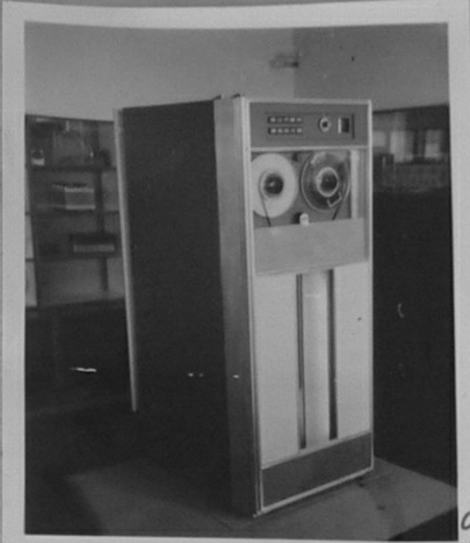
73-3884-9-Завод за запаметяващо устройство -външно запомнящи устройства на магнитна лента тип 5012М. /К.Узунова/ТК
