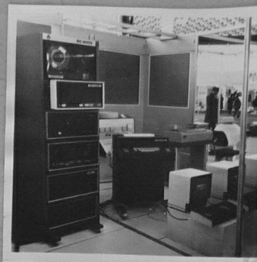
79-3900-12 Завод "Електроника" - многопултова система за изготвяне на данни върху магнитна лента Вес. Димитров/МД
