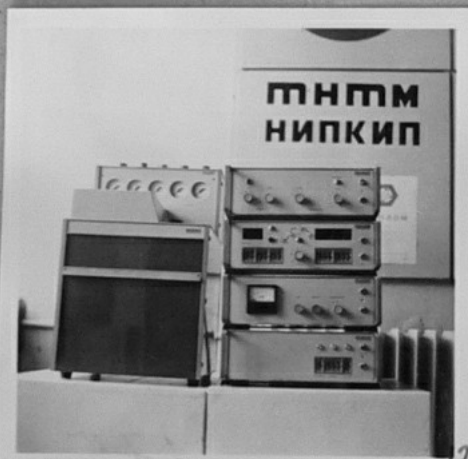
74-1606-12-Лабораторен газов хроматограф "Термохром" 23, дело на колектив с ръководител н.с. инж. Л. Стоев. /А. Цанков/ТК
