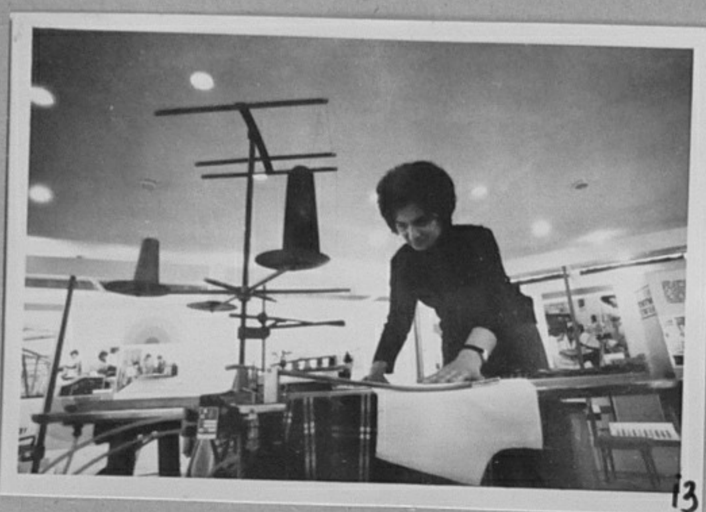
76-2027-13-Една от най-значимите рационализации на тазгодишната изложба на ТНТМ-Видин-автомат за зачистване на предници на мъжки ризи./Д.Стаматова/ЛА
