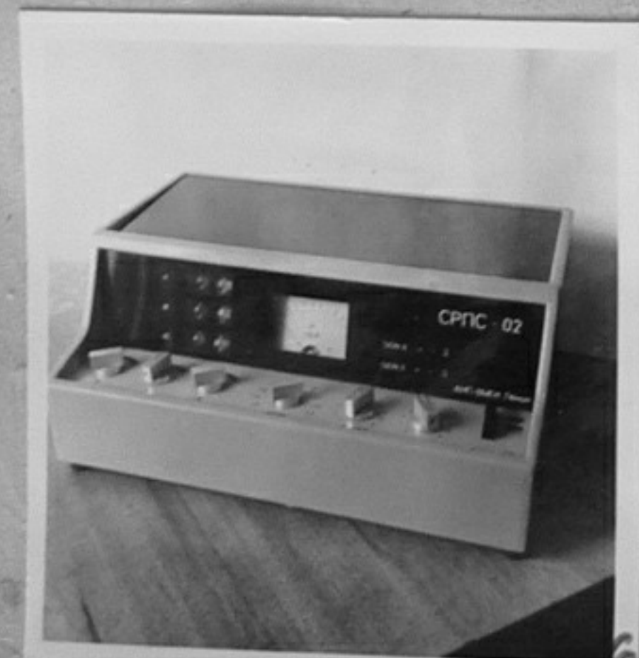
76-593-6-Статистически регулатор с променлива структура СРПС-02, разработка на колектив с ръководител доц.Цонков. /В.Иванова/ИК
