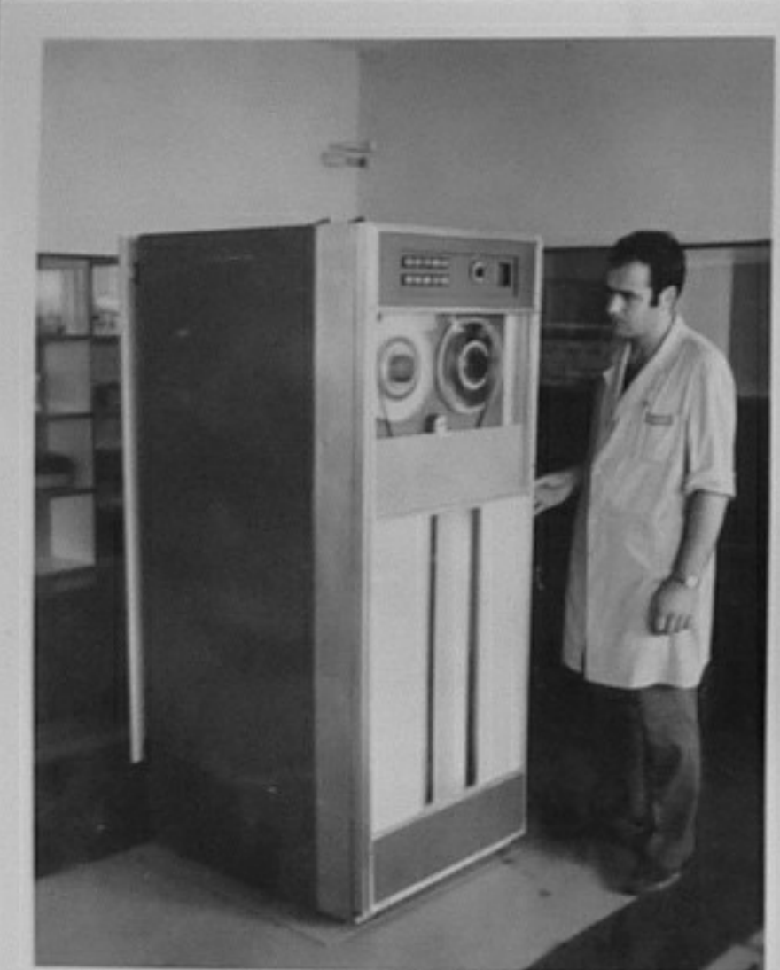
73-3884-10-Външно запомнящо устройство на магнитна лента тип 5012 М. /К.Узунова/ТК
