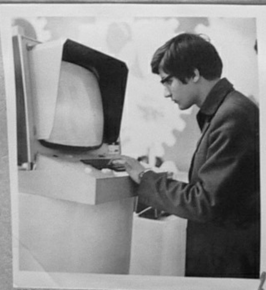
VII национална изложба на ТНТМ-Пловдив. 74-4764-2-Телевизионно- индикаторно устройство за цветна графическа информация. /Н. Чобанов/ТК
