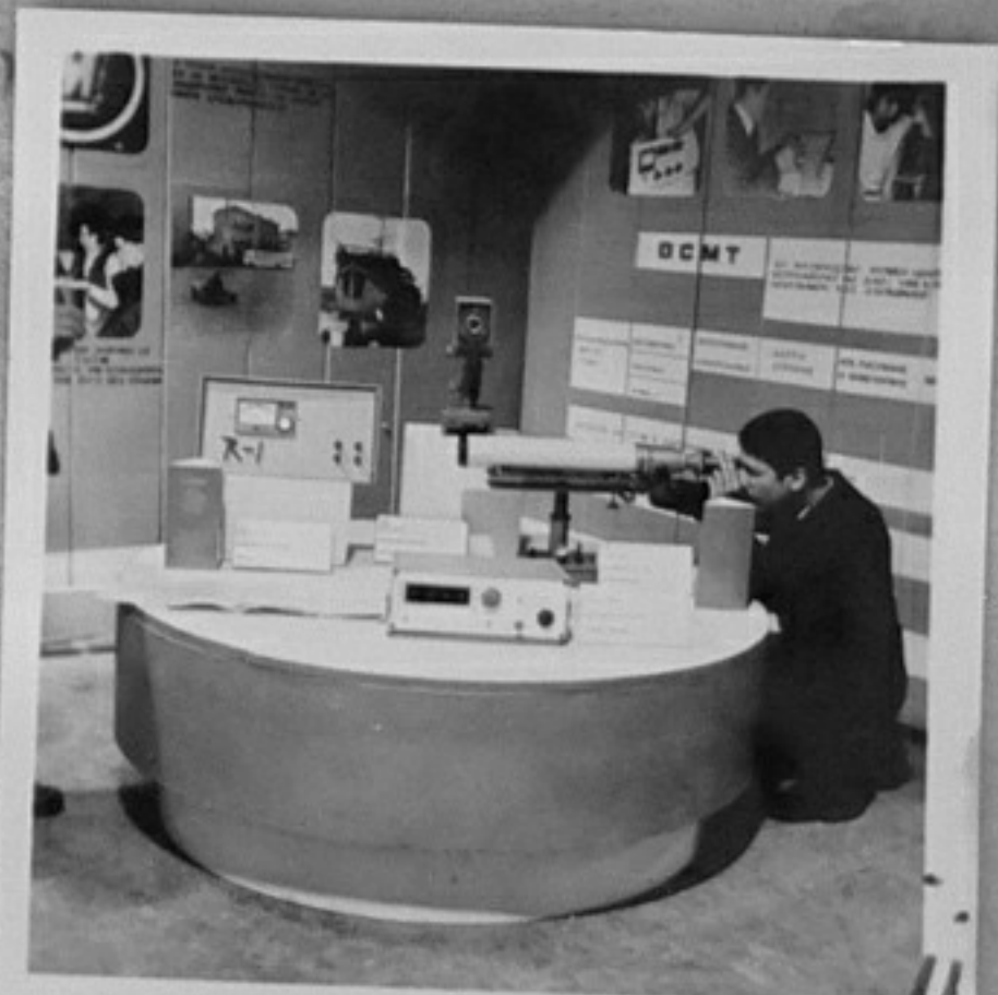
73-4807-11-Автокалиматор и апарат за ел.хим.редукция на газове.Авт.колектив ,инж.С.Пренева,ОСМТ,Бургас. /Нед.Чобанов/СС
