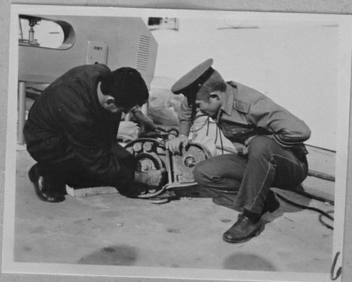
73-4767-6-Машина за почистване на метални платна и бетонни плочи;авт.колектив с ръковод.- Желю Андонов./Н.Чобанов/СС
