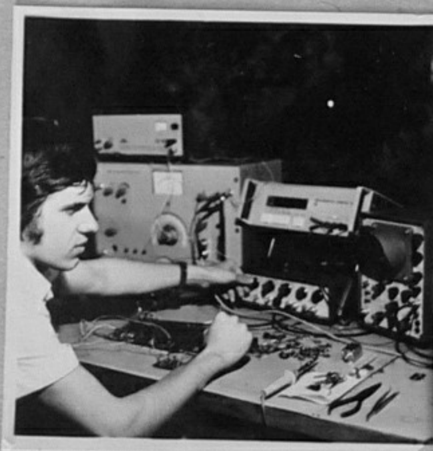
79-2257-2,3-Студентът Кирил Мечков от III курс, носител на многобройни награди за самостоятелни рационализации и изобретения. В момента извършва проверка на блока за индикация на виброизмерителна система. /В. Димитров/АШ
