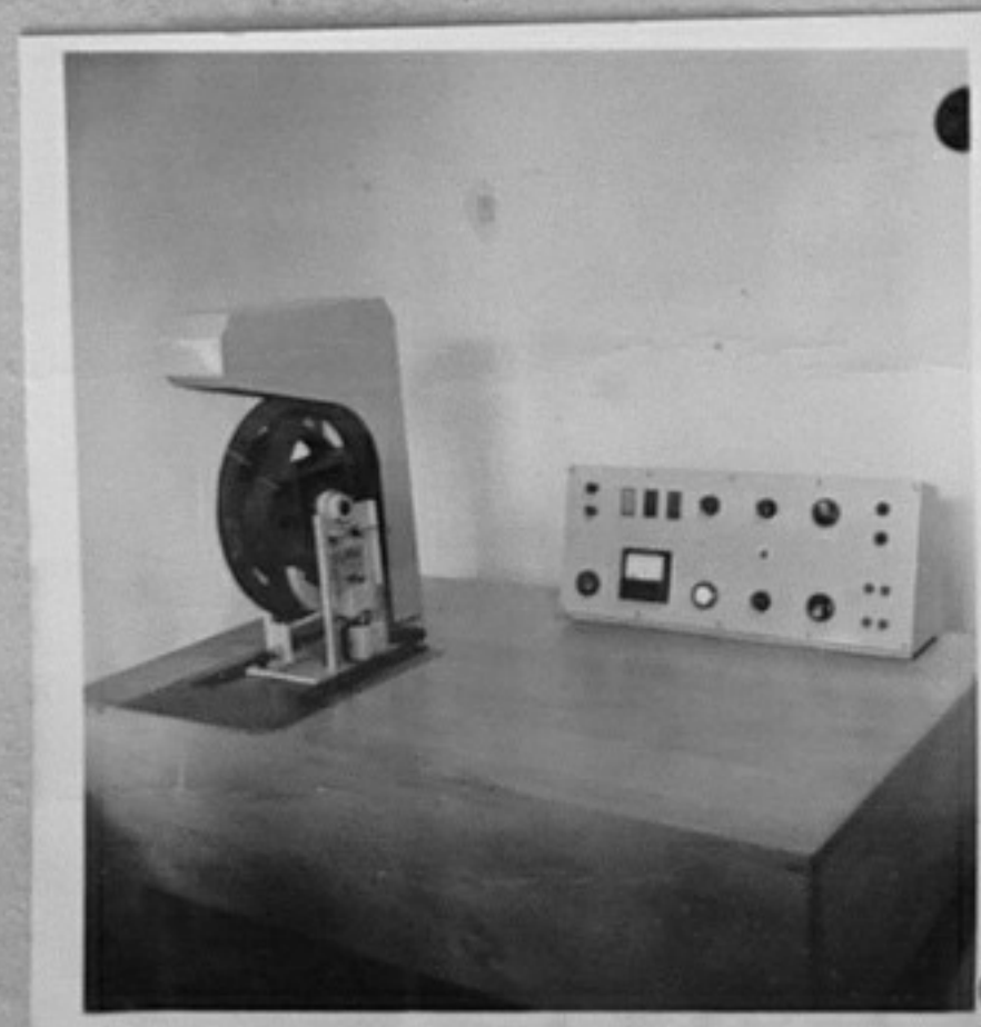
76-591-9-Стенд за произ- водствен контрол и на- стройка на ограничителя на скоростта за асансьори разработка на гл.ас.Д. Камбуров./В.Иванова/ИКа
