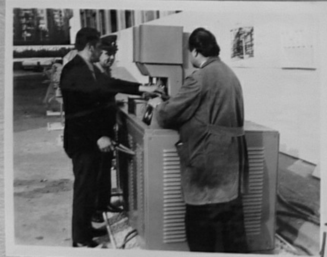
73-4767-1-Машина за челна ел-заварка с хидравлично задействие.Ръковод.-майор Ал.Матев, под.30-20,Пловдив. /Нед.Чобанов/СС
