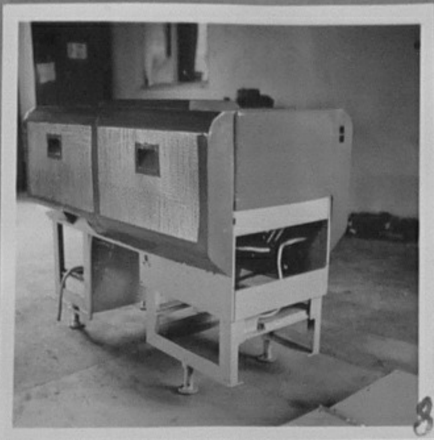
Клуб на ТНТМ при ДСО "Океански риболов" - гр.Бургас. /П.Божков/ИК 75-2204-2-К.Петров-техник, 75-2204-8-Рибочистачна 75-2204-12-Инж.Стоян Ива- майстор на научна апаратура, машина с хидротрансмисион-нов. разработва нови технологии но задвижване, създадена за получаване на рибни про- от машинно-конструкторска дукти. група при клуба.
