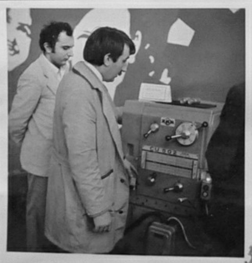
74-4764-3-Електромехани- чна затегателна система с механизмиран спирало- челюстен патроник. /Н. Чобанов/ТК
