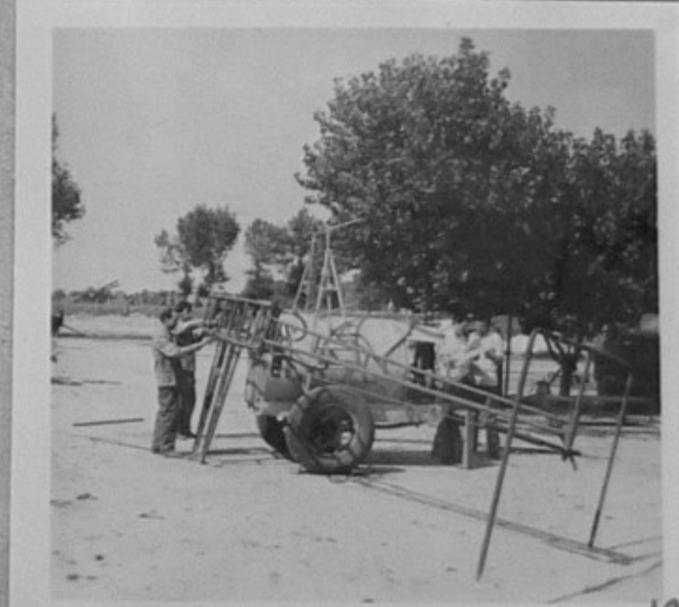
73-3377-13-АПК-Тракия - пръскачка за широредови лозя, пръска всички фази на развитието на лозето. /К.Узунова/ТК
