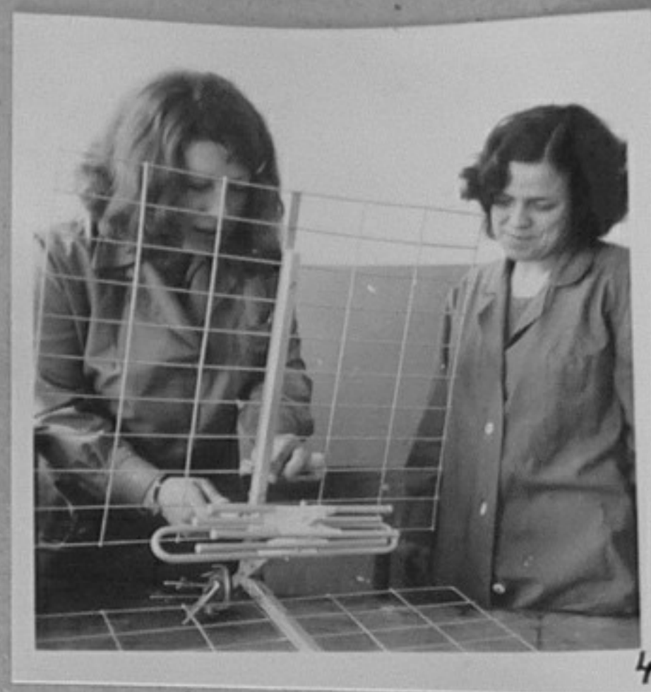
Обекти за окръжната изложба на ТНТМ-гр. Годеч, ЗПИ "Ком". /Н.Хлебарова/ИК 76-1334-12-МКТБ - разра- 76-1335-3-Конструирани на уред за проверка на кабели - съединителни. ботва инструменти за сечене и сгъване на съединители за телевизионни антени. 76-1335-4-Изработване на външни телевизионни антени за 39 канал.
