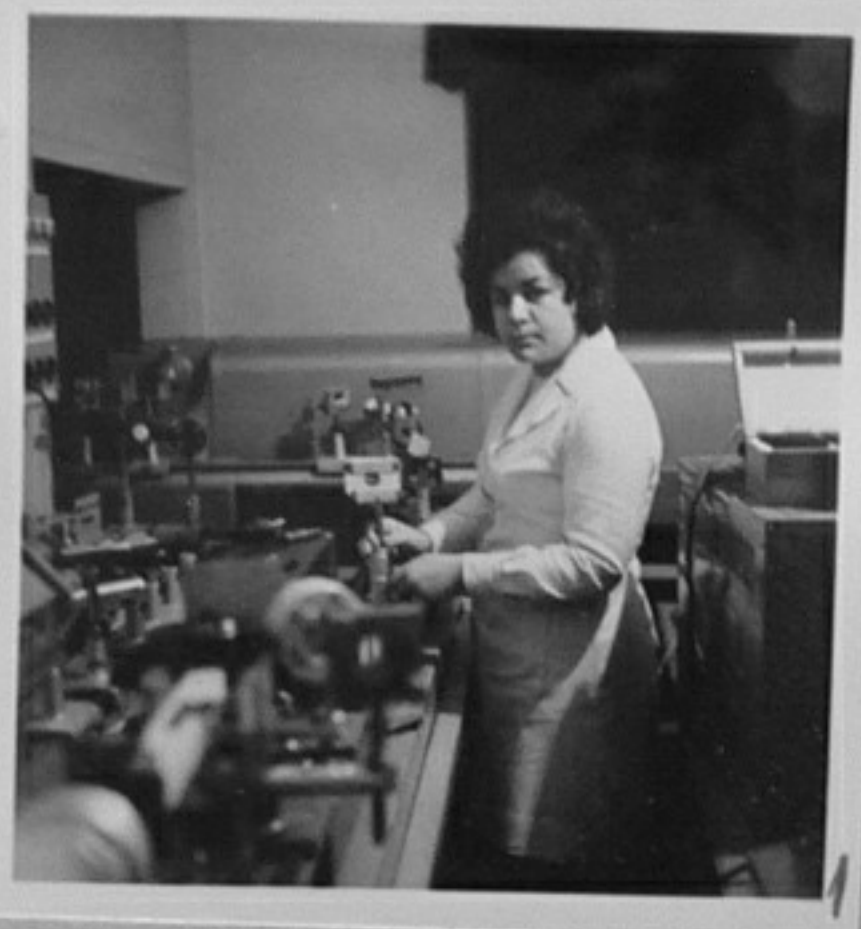
СУ-Физически факултет - групи по ТНТМ. 74-1533-1-Неодинова лазерна установка за изследване в областта на нелинейната оптика. /Р. Атанасова/ТК
