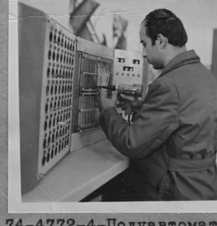
74-4772-4-Полуавтомат за навиване на вътрешно-касетен връзки, дело на колектив с р-л инж. Т. Кърджиев от Завода за изчислителна техника-София. /Н. Чобанов/ТК
