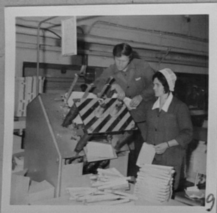
Обекти за изложба на ТНТМ. 76-1225-9-Машина за сгъване на кутии, същата е внедрена преди 1 г. и е с икономически ефект 60 хил. лв. Ян.Лозанов и Р.Иванова по време на работа.
