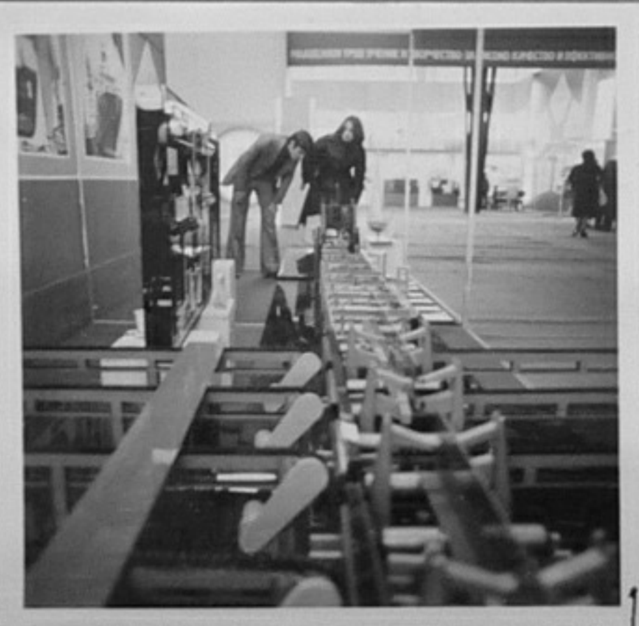
77-3305-1 Полуавтоматизирана линия за съставен набор, разработка на колектив от ККЗ "Ив. Димитров" - Русе Д. Стаматова/МД
