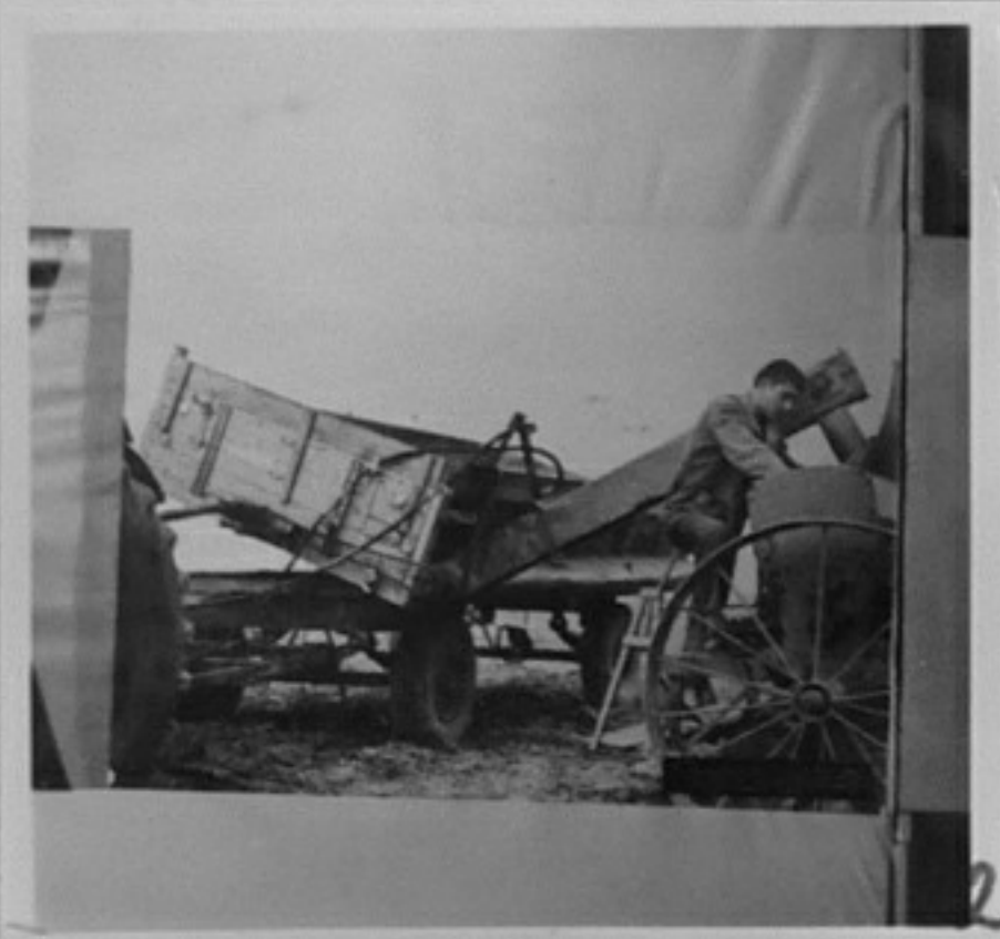
73-3854-2-Приспособление към самосвално рамкиране за зареждане на редосеялките, Варна. /Р.Парушев/
