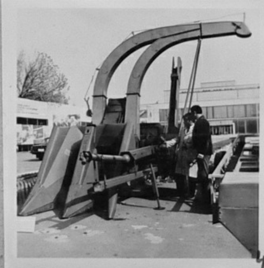
73-4810-4-Приспособление към царевичен комбайн КЦ-2 за нарязване и прибиране на нискоствелена маса. Авт. колектив с ръковод. инж. Н. Николов, АПК, Исперих.
