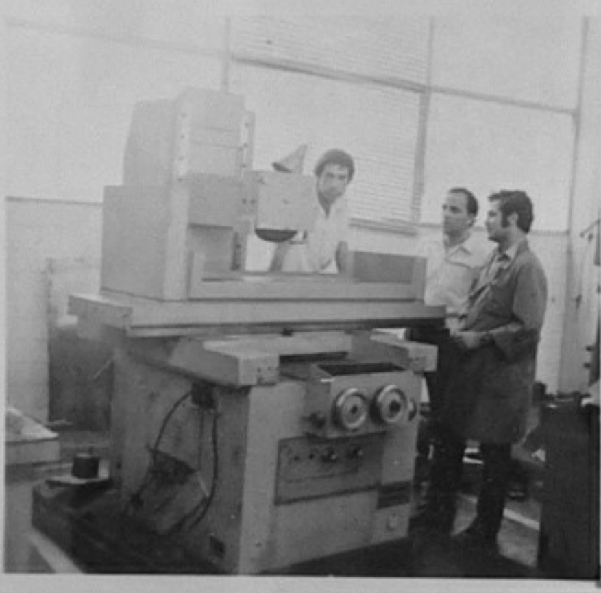
73-3377-5-Машина за шлифване на плоски и фасонни детайли, изработена от ТНТМ-Асеновградското на лозето. /К.Узунова/ТК
