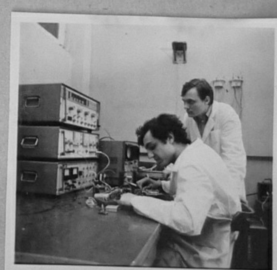
74-1238-10-Инж. Руси Котев и констр. Димитър Белишки изпробват генератор за 50 часа. /Хачик Румян/ЕИ
