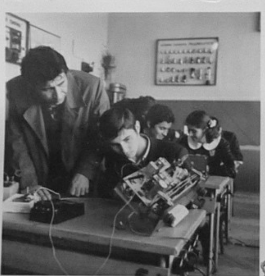
Обекти за окръжната изложба на ТНТМ-Ботевград. ТМЕ 76-1214-3-Ученици от IV курс изработват приспособление за изпитване на валове, ръковод. Н.Тодоров.
