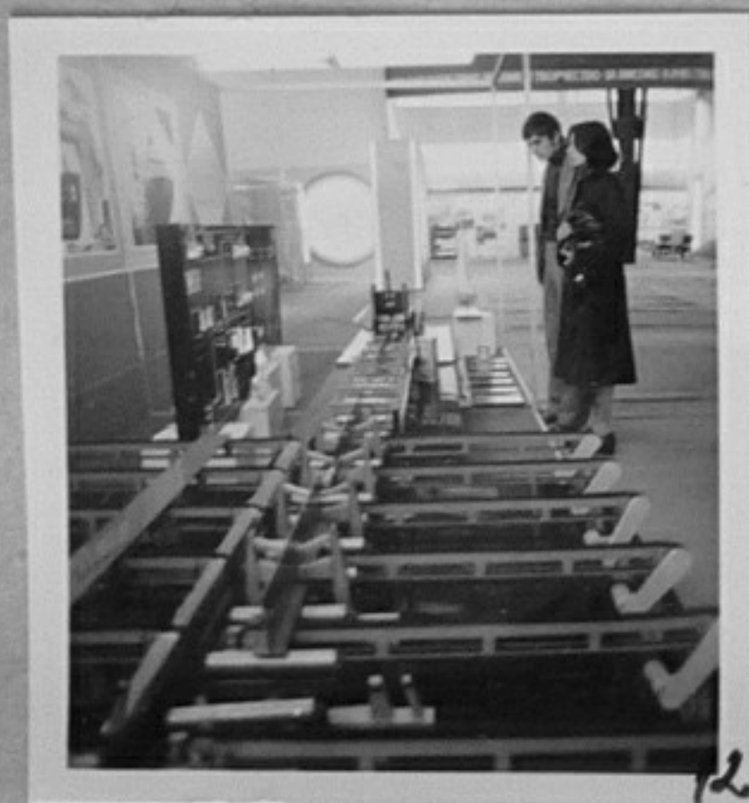
77-3304-12 Полуавтоматизирана линия за съставен набор. Разработка на ККЗ "Ив. Димитров" - Русе Д. Стаматова/МД
