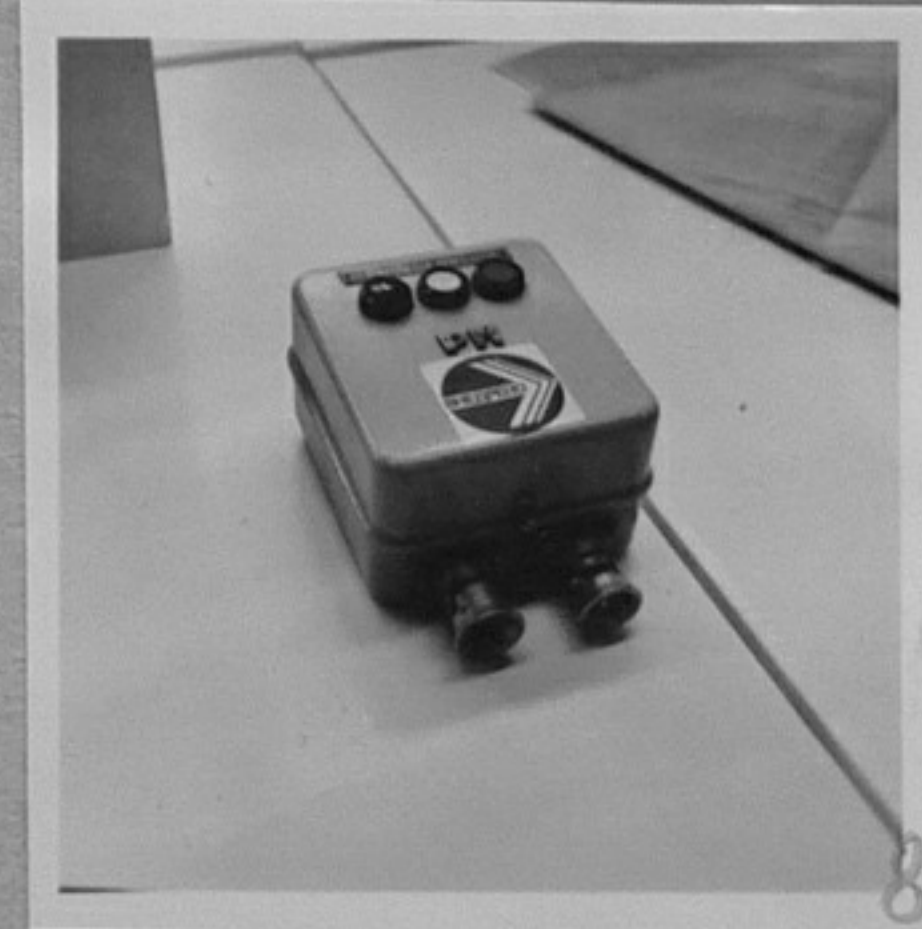
79-3898-8 Висш минно-геоложки и-т. - апарат за защита от утечки/АЗУ/ за руднични мрежи с напрежение 220 волта. Вече е внедрен в мините Вес.Димитров/МД
