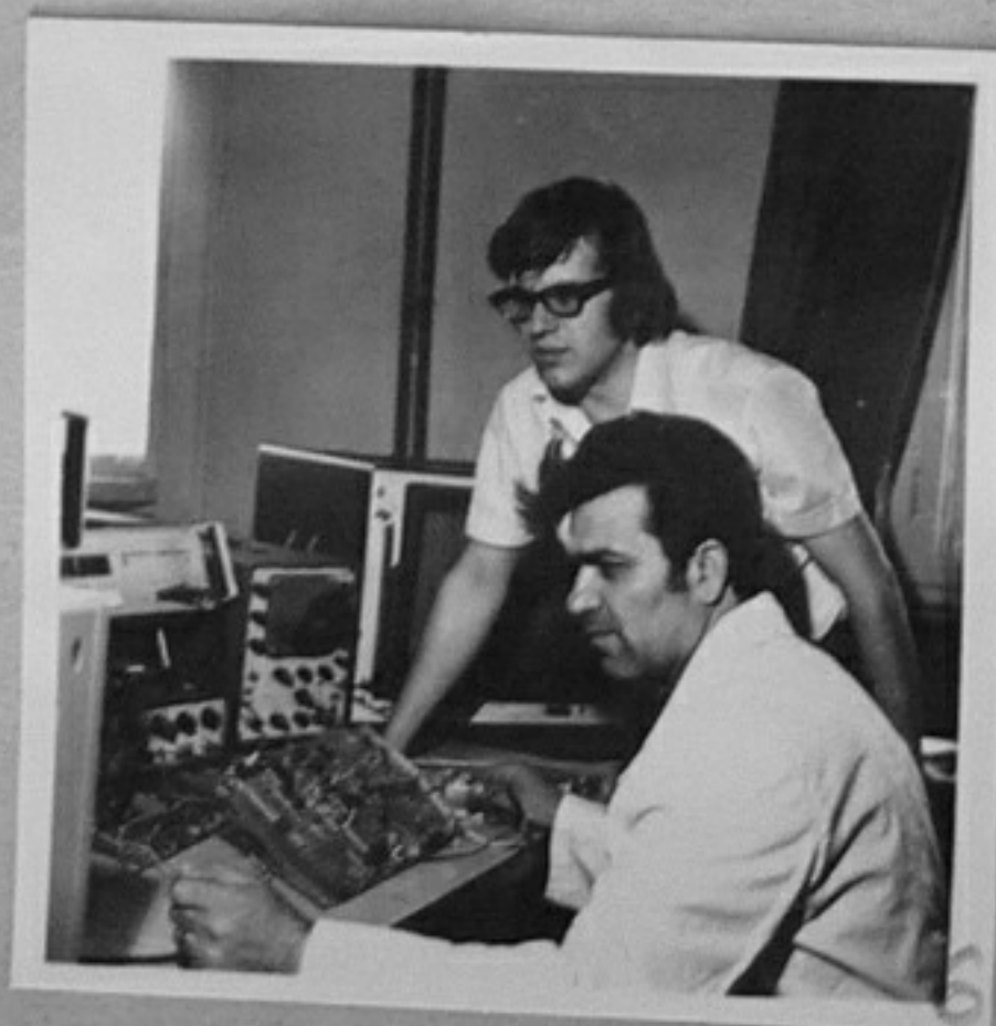
79-2257-2,3-Студентът Кирил Мечков от III курс, носител на многобройни награди за самостоятелни рационализации и изобретения. В момента извършва проверка на блока за индикация на виброизмерителна система. /В. Димитров/АШ
