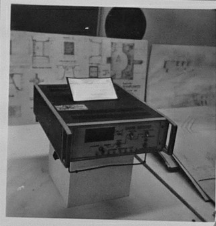
79-2350-2-Уред "Цифров оборотомер" на клуба за ТНТМ при ВМЕИ "Ленин". /В.Димитров/АШ
