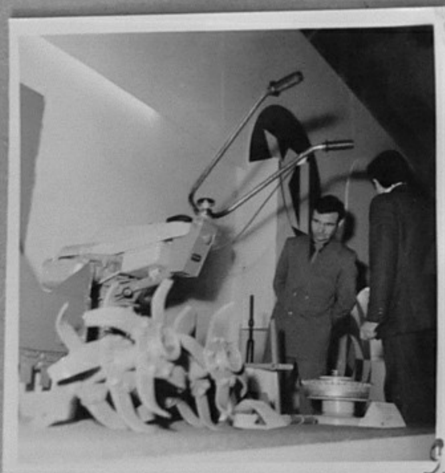
VIII национална изложба на ТНТМ - гр. Пловдив. /Х. Румян/ИК 75-4068-9-Машина за окопаване на зеленчукови култури, за валиране на царникова почва. Автори М. Стоянов и П. Странчански-МВР.
