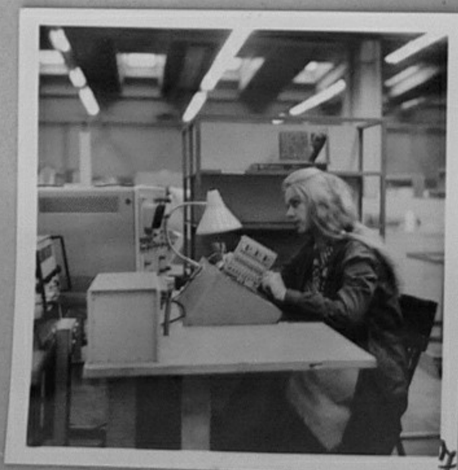
76-1766-9-Красимир Цанев на работното място на автоматичен стенд за информационна проверка на възел дешифратор с карта./Кр.Арсов/ЛА
