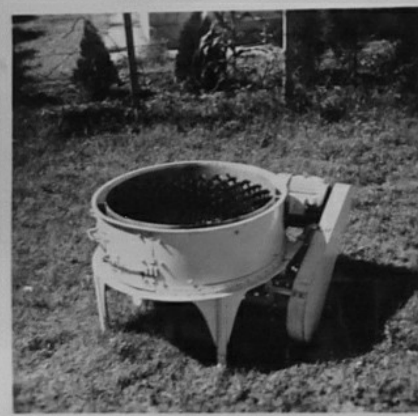
73-4095-3 - Машина за скубане на пилета изра- ботена от младежки колектив към АПК Бургас. /Ханджиев/ТК
