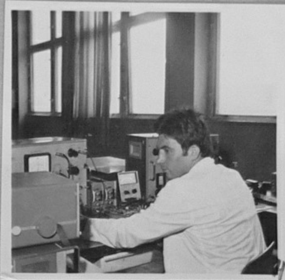
78-1721-4 Настройчикът Игнат Стоянов извършва настройка на блокове от 300-канална радиорелейна апаратура, разработена от младежка констр.технологична бригада с ръковод.инж.Леполд Клайн Вес.Димитров/МД
