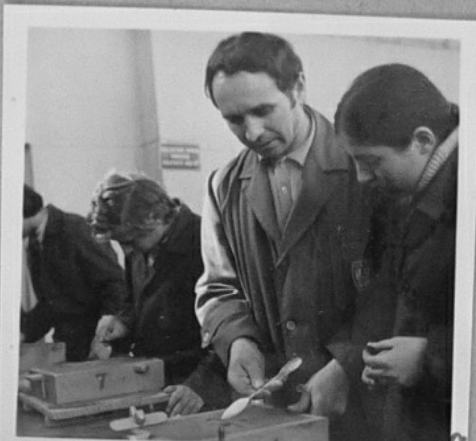
75-784-5,9-Курсисти от техникума с преподавател Л.Цоловски формоват модели с неправилна отделителна линия в леярната на техникума. Ботевград. /Н.Хлебарова/ИК 75-784-13-Преподавателят .Джам- базов контролира направа на радиоприемник "Чайка" в ел. работилницата на техникума.
