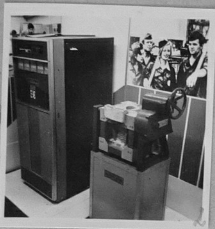
79-3899-2 ВМЕИ - София - висококачествен тиристорен инвертор с индукционна пещ. Предназначен е за научно-изследователска дейност и за малко серийно производство. Дело на сту- дентски колектив с рък. к.т.н. Мария Бобчева Вес. Димитров/МД
