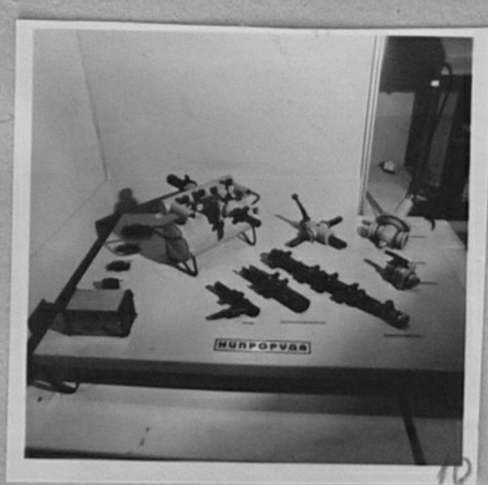
79-3847-10-Клуб на ТНТМ при Нипроруда, изработил гама от регулируеми маслѝонки. /Е.Богоев/АШ
