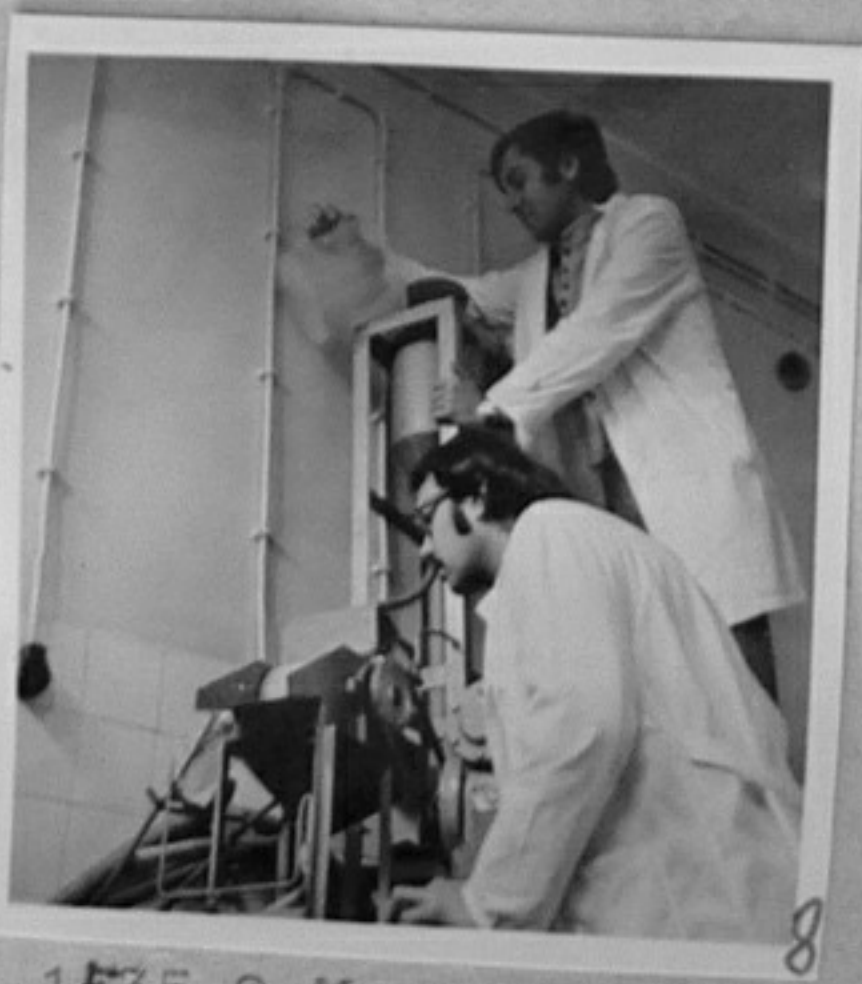
74-1535-8-Машина за флотация с отделно образуване на контакта. Работят инж. Д. Николов и инж. И. Нишков.
