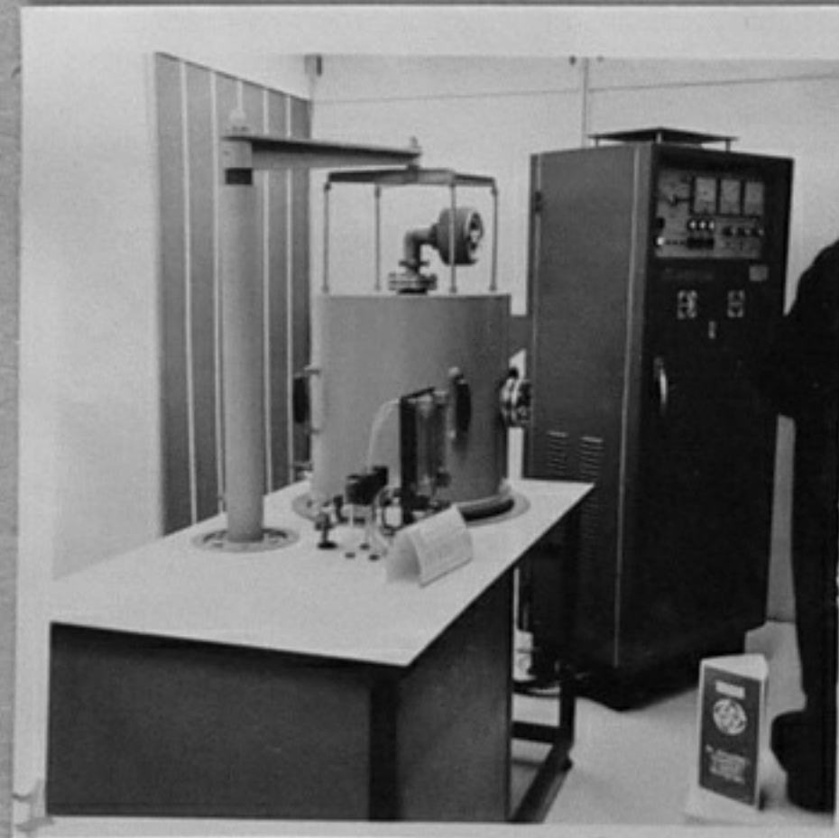
79-3898-7 Десета нац. изложба на ТНТМ - Пловдив/ВМЕИ "В.И.Ленин" - инсталация за химико-термична обработка в ел.тлеещ заряд "Ион-15" Вес.Димитров/МД
