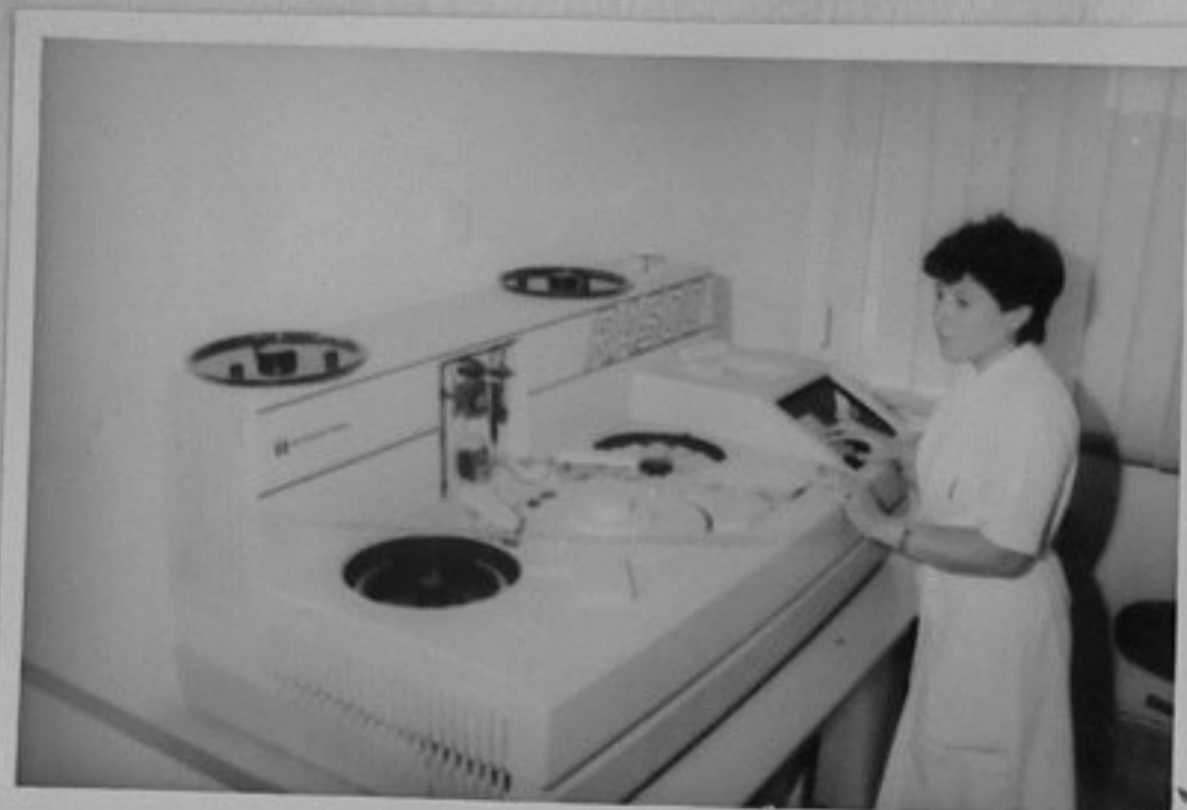
87-770-17-13-II-ра градска болница. Клинична лаборатория. Многоканален автоматичен анализатор за определяне на различни биохимични показатели. /М. Георгиева/ЛА
