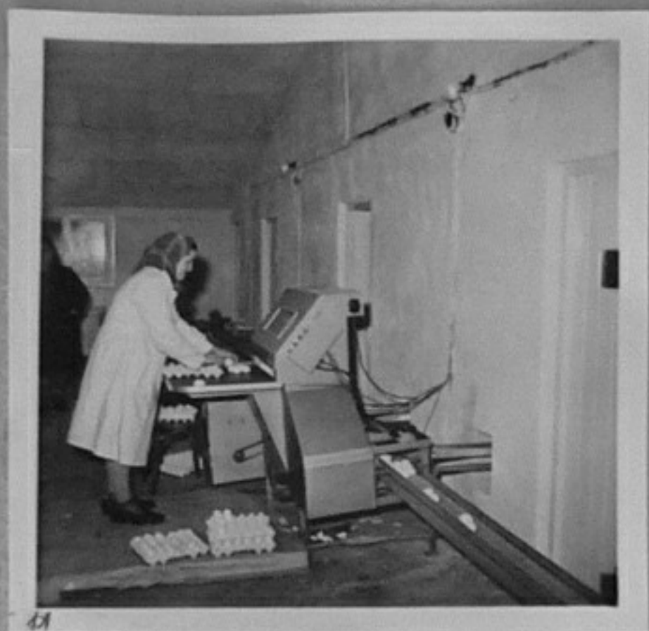
67-4304-11, 12- Яйцесъбирачна машина. Яйцата се събират чрез автоматична транспортна лента. /Т. Симеонов/ /СС/
