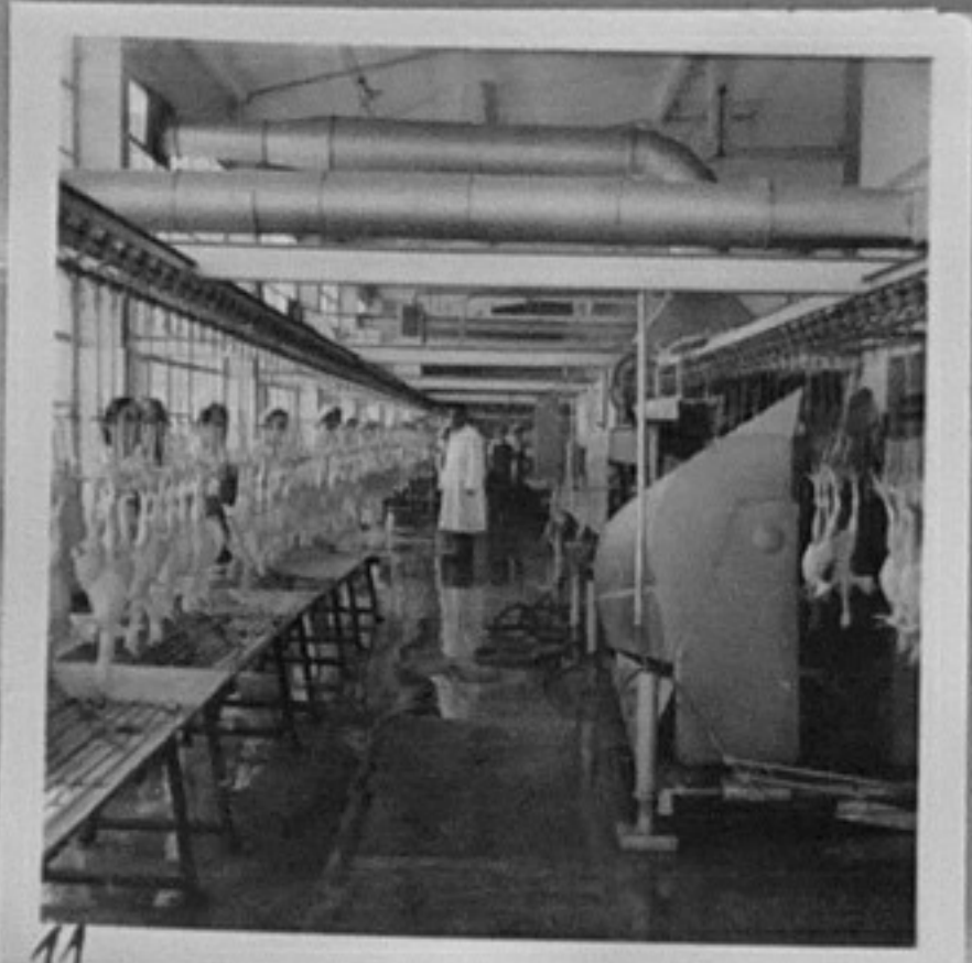
67/1213 - В птицекомбината край Костинброд. /Любомир Чаръкчиев/СС. 1 - Автоматично отмерване грамажа и разпределяне на пакетите с бройлери. 5 - Амбалиране. 11 - В птицекланицата с капацитет 3,500 пилета на час.
