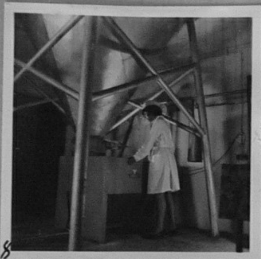
67/1202-8- Автоматична машина за разпределяне на хран. смеси в производств. сграда/Л-Чаръкчиев/СС
