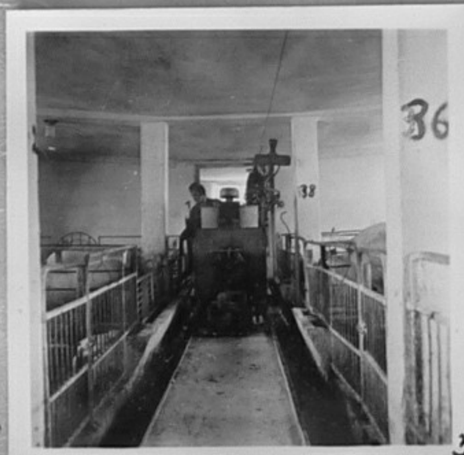
68-1231-9- Както кадър 4. 68-2301-3,4-Машина за хранене на свинете майки в свинефермата в Попово. /Д. Сибирски/ ХП
