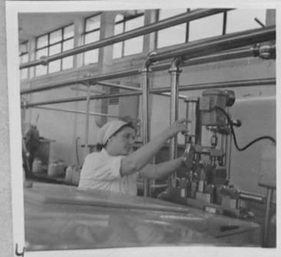
67-3421-4- Регулиране на налягането на хомогелизатора от Анка Вучкова, работничка в млекоцентралата.
