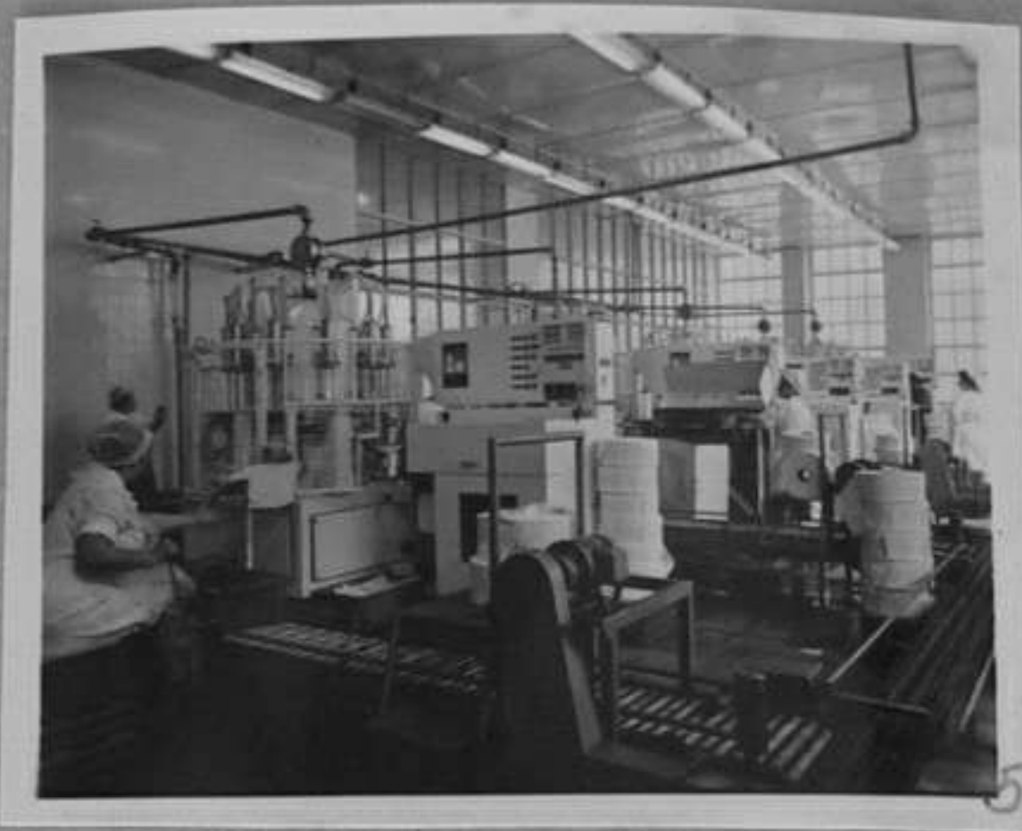
73-2829-5-Машина за разфасовка на извара в млекокомбинат "Сердика"/Т. Симеонов/ТК
