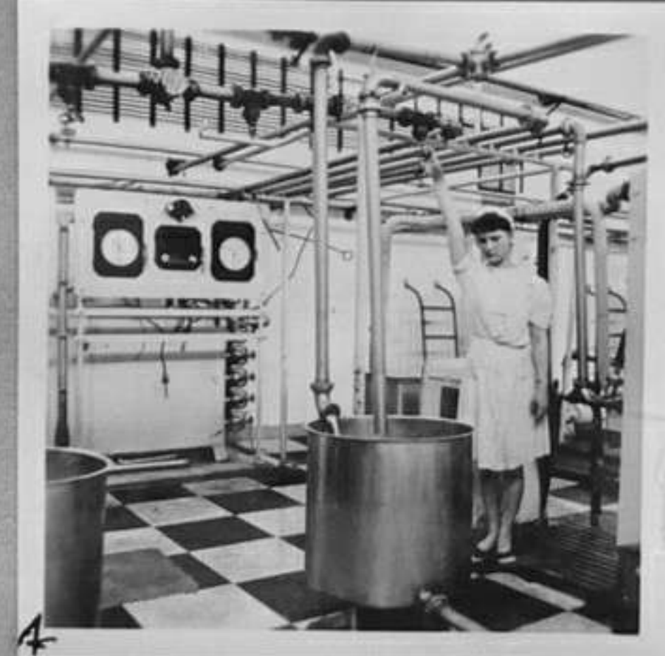
4-Регулиране на притока на мляко от ваните в машините.
