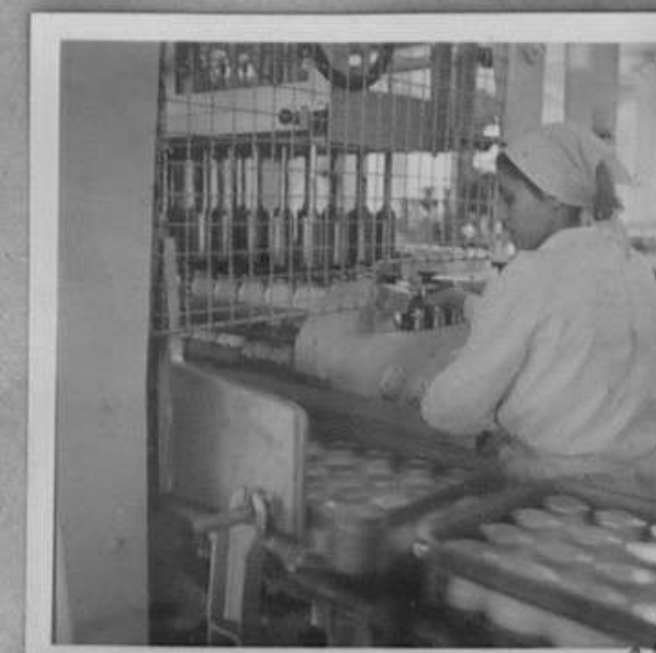
67-3422-10-Крейтер-автоматично поставяне на бурканите в касетките.
