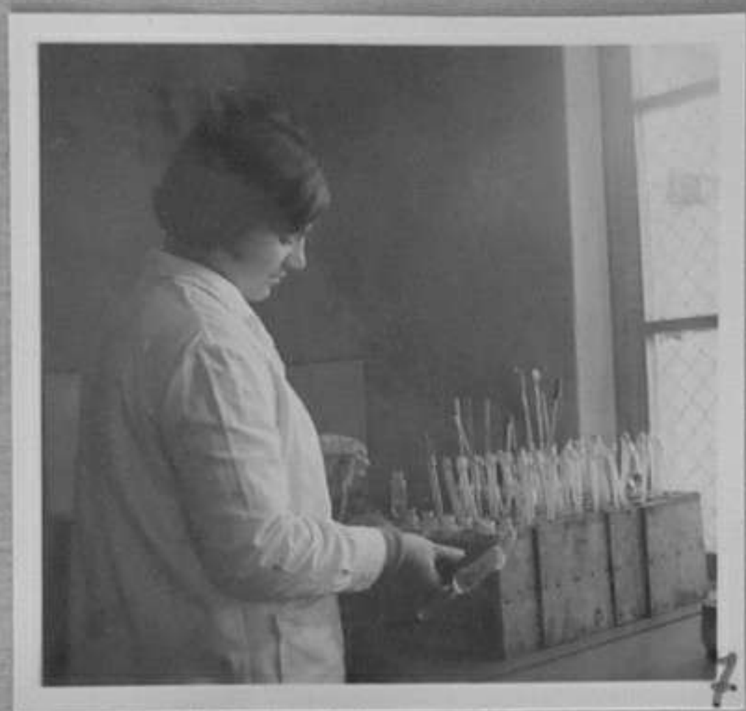
69-4557-7-Вземане на млечни проби и изследване маслеността на млякото. /Нед. Чобанов/ XII
