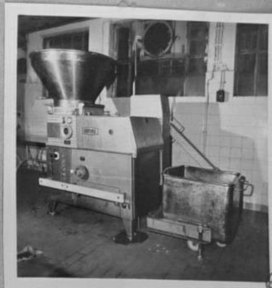
84-32-6-Разфасовъчна машина за топен млечен пастет в четири асортимента.Машина от фирмата "Веаг"-ФРГ. Е.Богоев/ЛА
