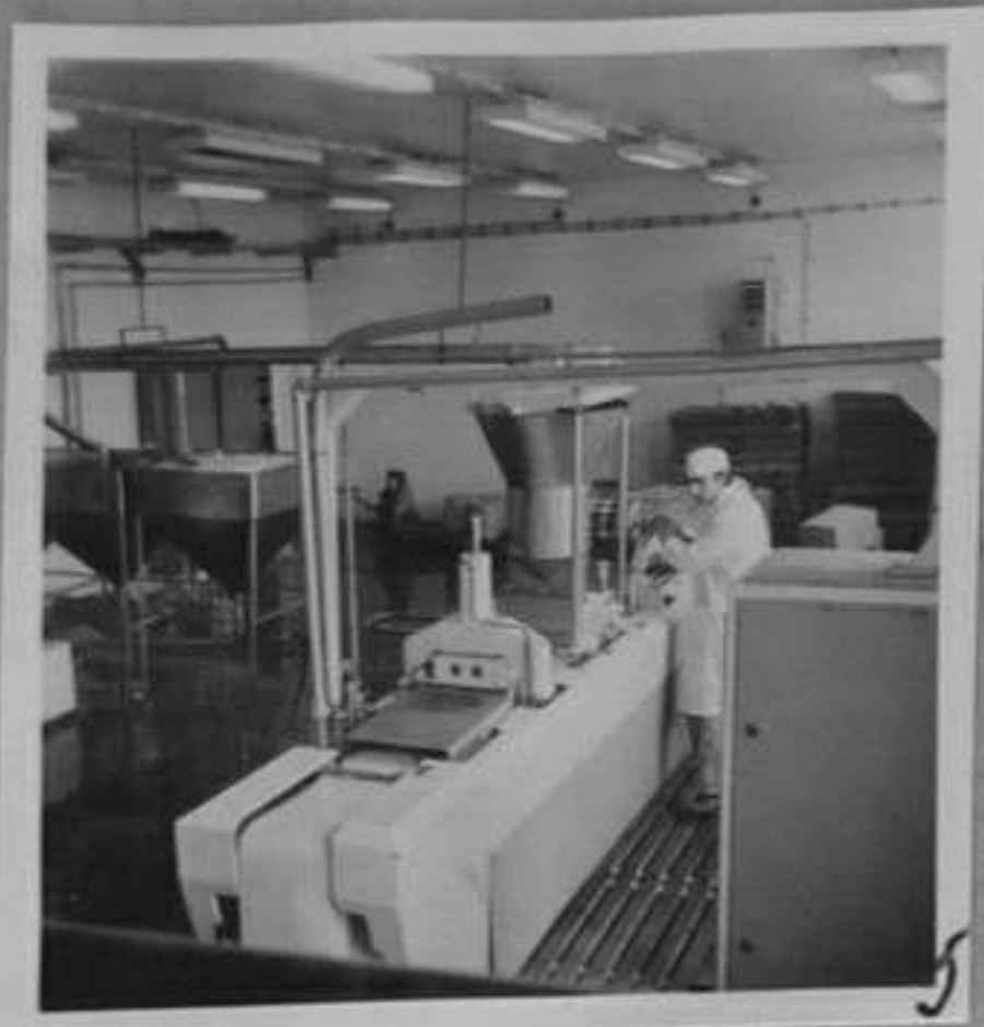
73-2829-5-Машина за разфасовка на обезсолена извара в млекокомбинат "Сердика"/Т. Симеонов/ТК
