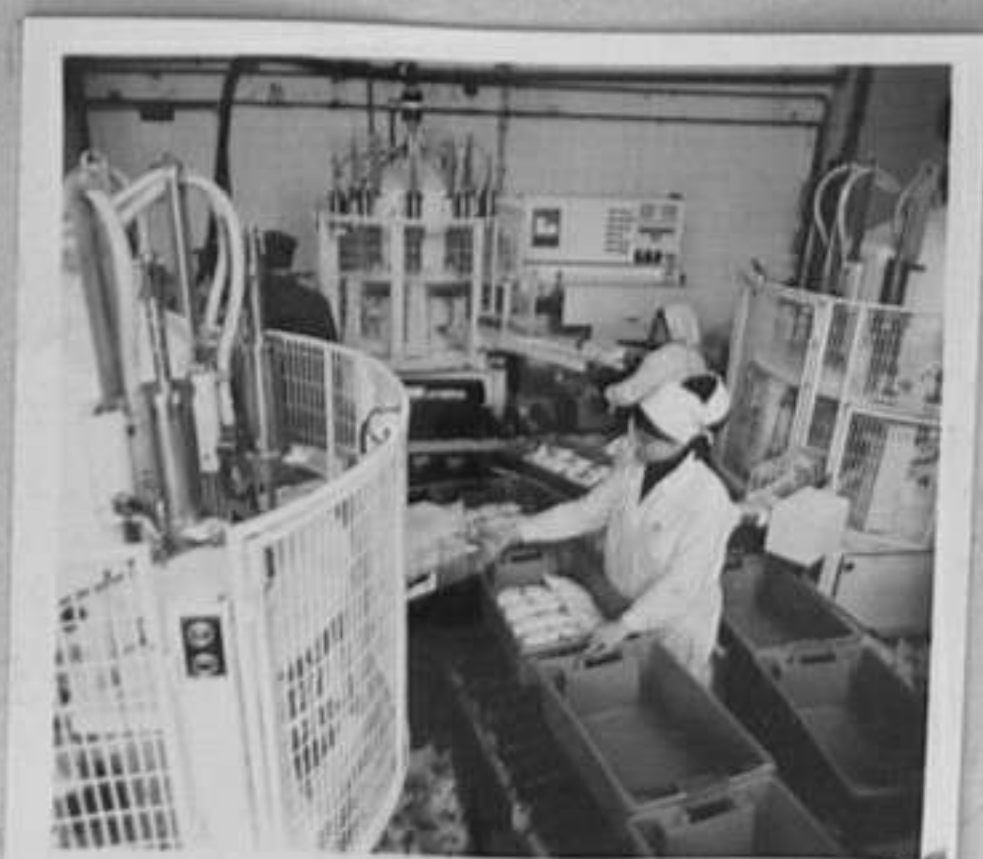
71-1050-11,12-Три високопроизводителна машини пакетираат за едно денонощие около 90 тона прясно мляко в пластмасови пликосе.
