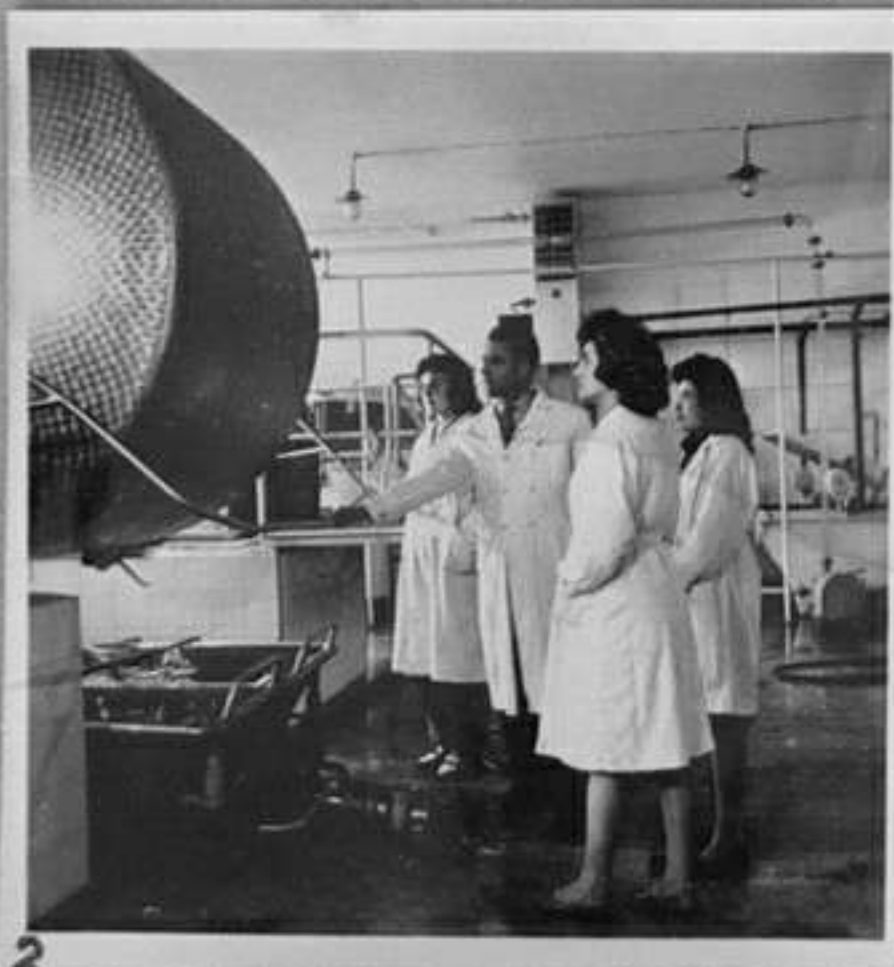
2- Главният инженер на млечозавода Георги Костадинов обяснява на курсистите от II курс при селско-стоп. техникум "Хр. Гюлеметов"-Плевен устройството и действието на метал. безвалцов буталкогнет. /Чаръкчиев/.
