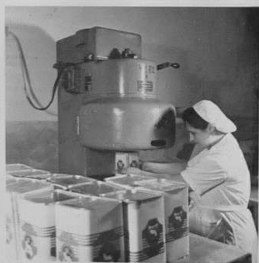
67-4167-10-Автоматично затваряне на кутии със сирене.
