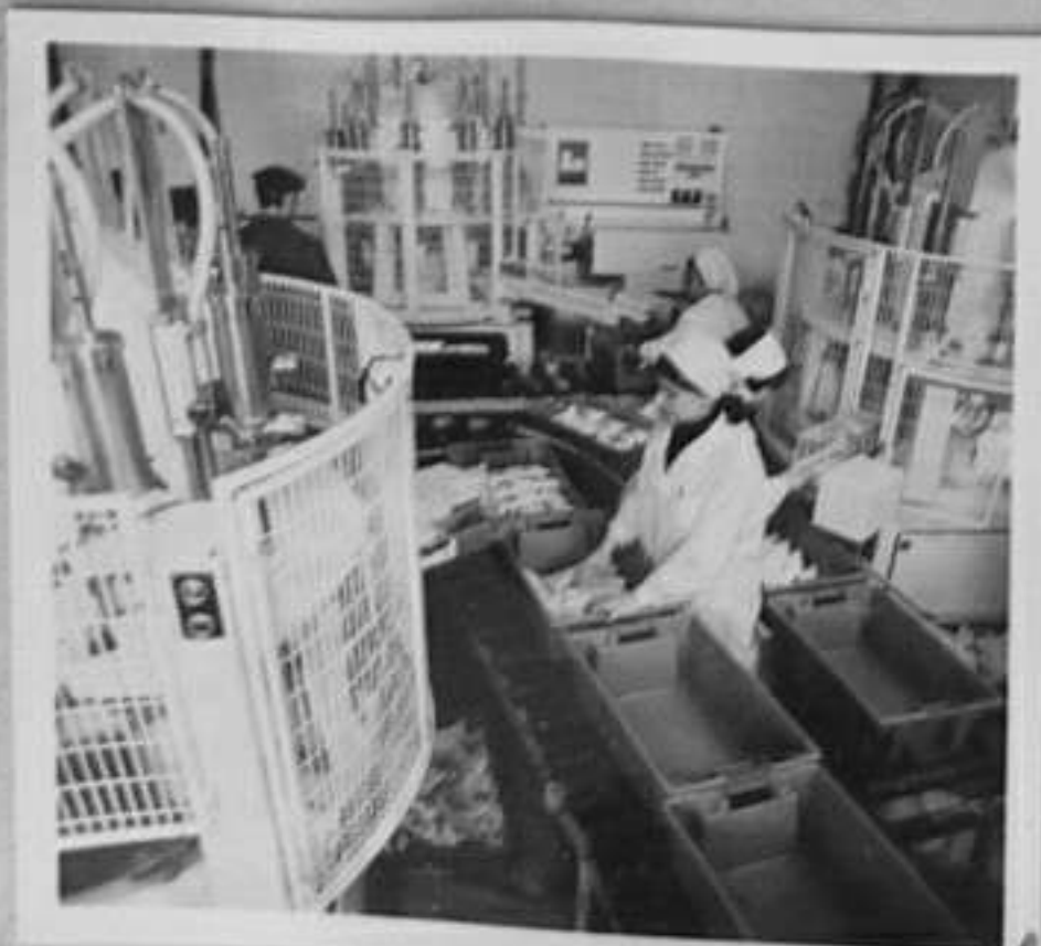
71-1050-11,12-Три високопроизводителна машини пакетираат за едно денонощие около 90 тона прясно мляко в пластмасови пликосе.
