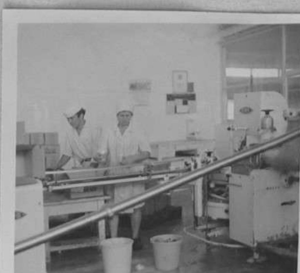
71-4461-10,12-Производство на масло с маслоизготвители по непрекънат метод и опаковане на същото с машини по 25 гр. и 125 гр. /Л.Георгиева/ XII
