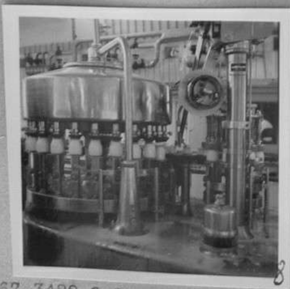
67-3422-8-Затварачна машина затваря бурканите с алуминиево фоли.
