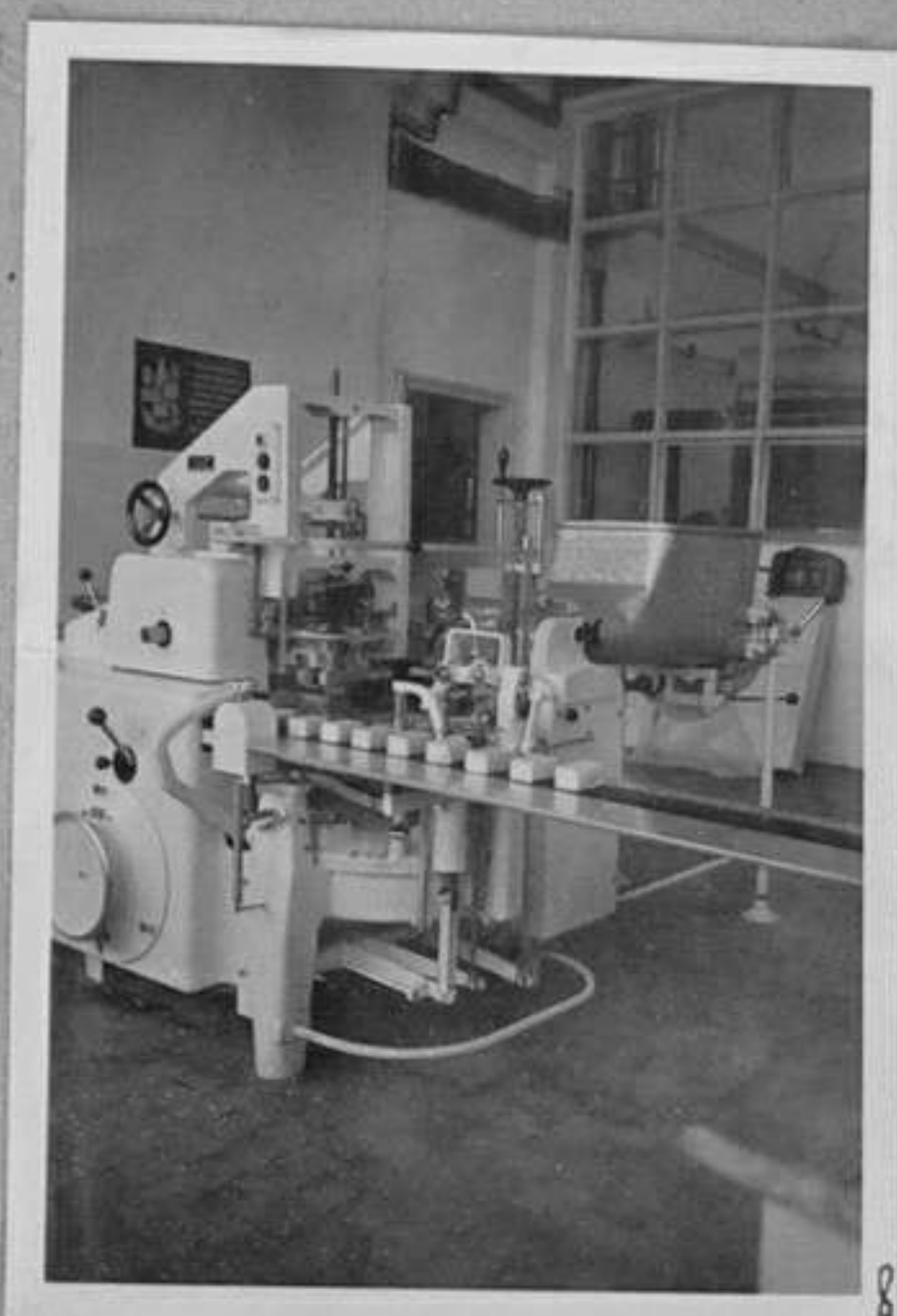
8-Автоматична опаковачна машина на маслената продукция.
