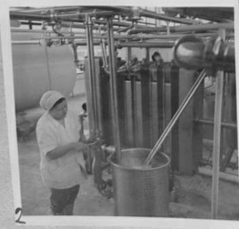
67-3421-2-Казанче за регулиране на млякото за машината. Раб. Анка Вучкова следи нивото на млякото в казанчето за регулиране на млякото за машината.
