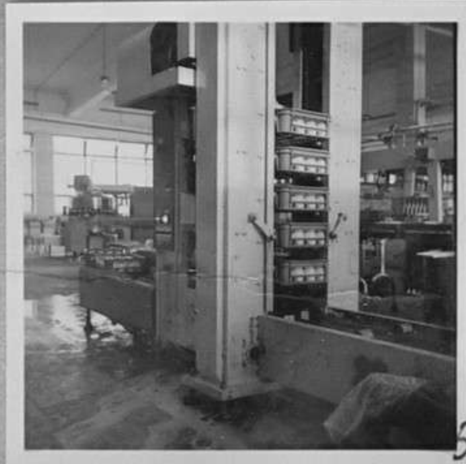
67-3422-5-Стифатор-подрежда касите една върху друга. /Здравка Минчева/СС
