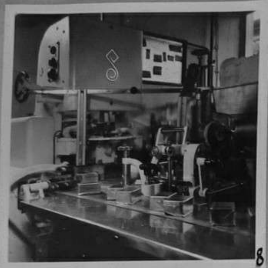
67-4173-8-Автоматична машина за пакетиране на масло./Л.Чаръкчиев/СС
