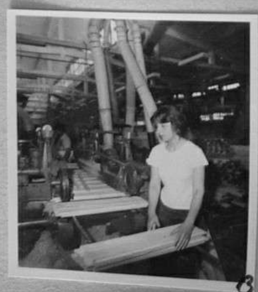
78-1733-6 Механизирана линия за фалцване и изработване гнезда за обков на крила за прозорци и балконски врати Ан.Цанков/МД
