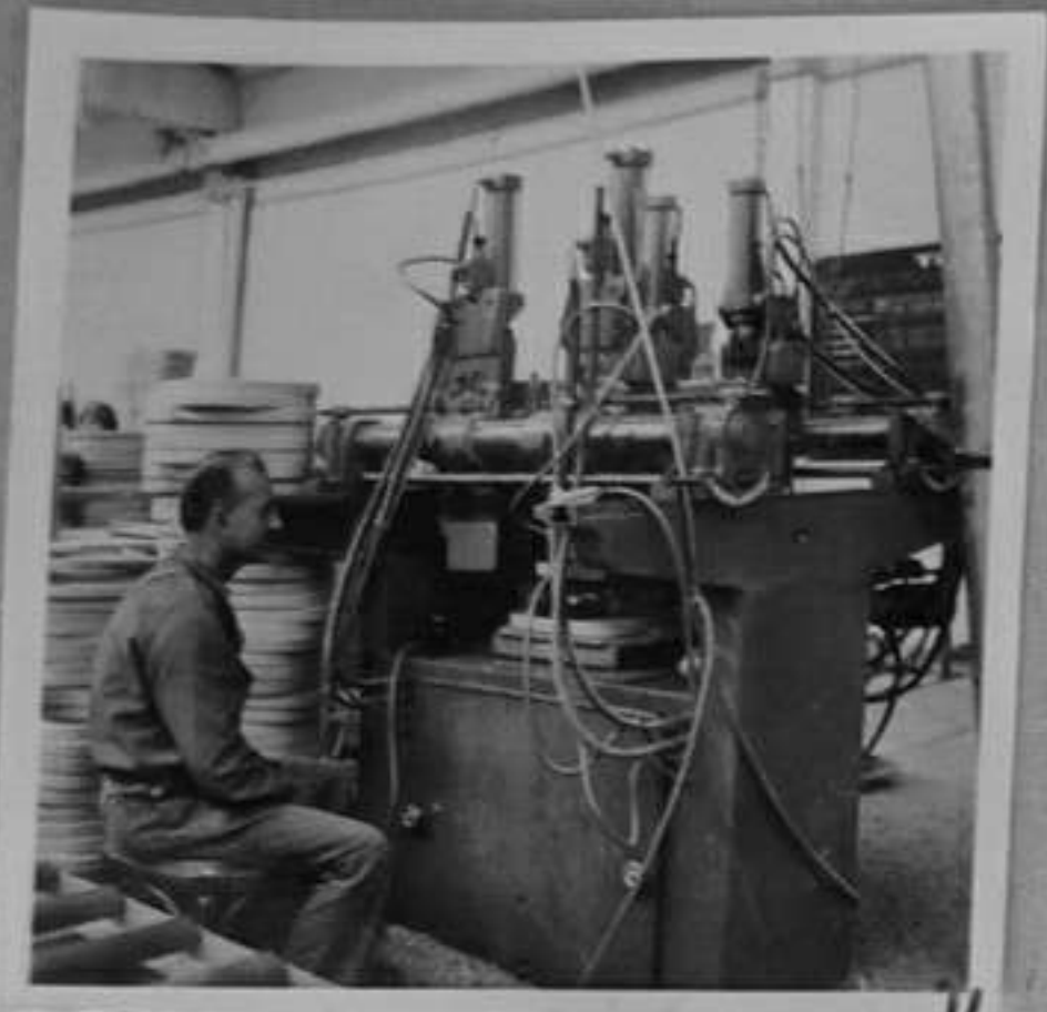
73-3056-11- Многоопера- ционен агрегат за комби- нирано пробиване и шлайфа- не на детайли. /В.Иванова/ТК
