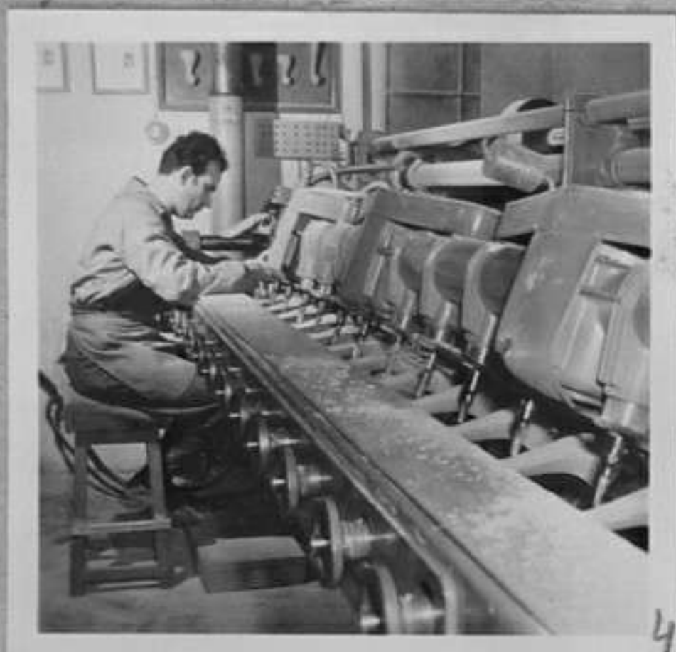
74-145-4-Ненко Симеонов работи на обемна копираща работилница на стилните крака на спалния модел 031. /Р.Марукян/ТК
