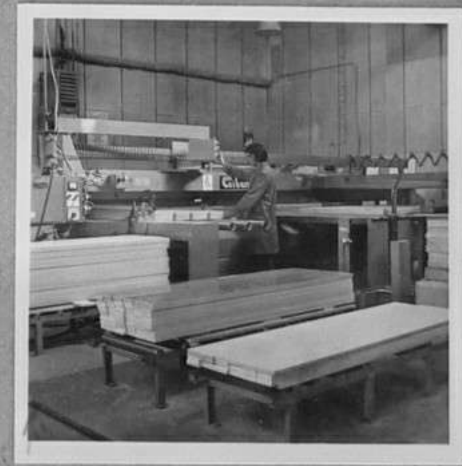
80-2444-1 Илия Иванов Керин работи на разкриващ циркуляр за плоскости от дървесни частици-ламинирани Р.Марукян/МД
