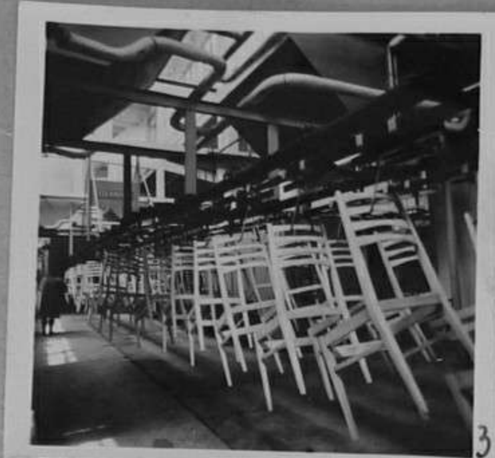
73-3057-3,6- Поточна линия за лакиране на столове в завода за столове "Хемус" -Троян. /В.Иванова/ТК
