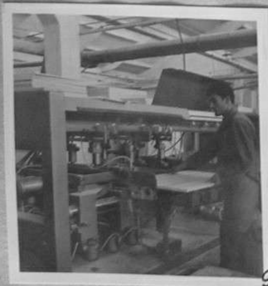
68-4613-9-Многошпинделов бор- агрегат за пробиване на плоскости. /Д. Рогов/ XII
