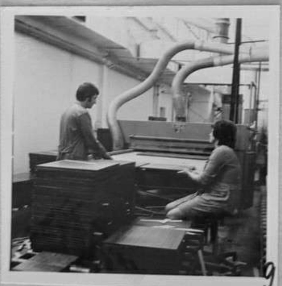
77-2322-9-Автоматична линия за полиране на плоскости за секционни мебели. /Р.Марукян/ЛА
