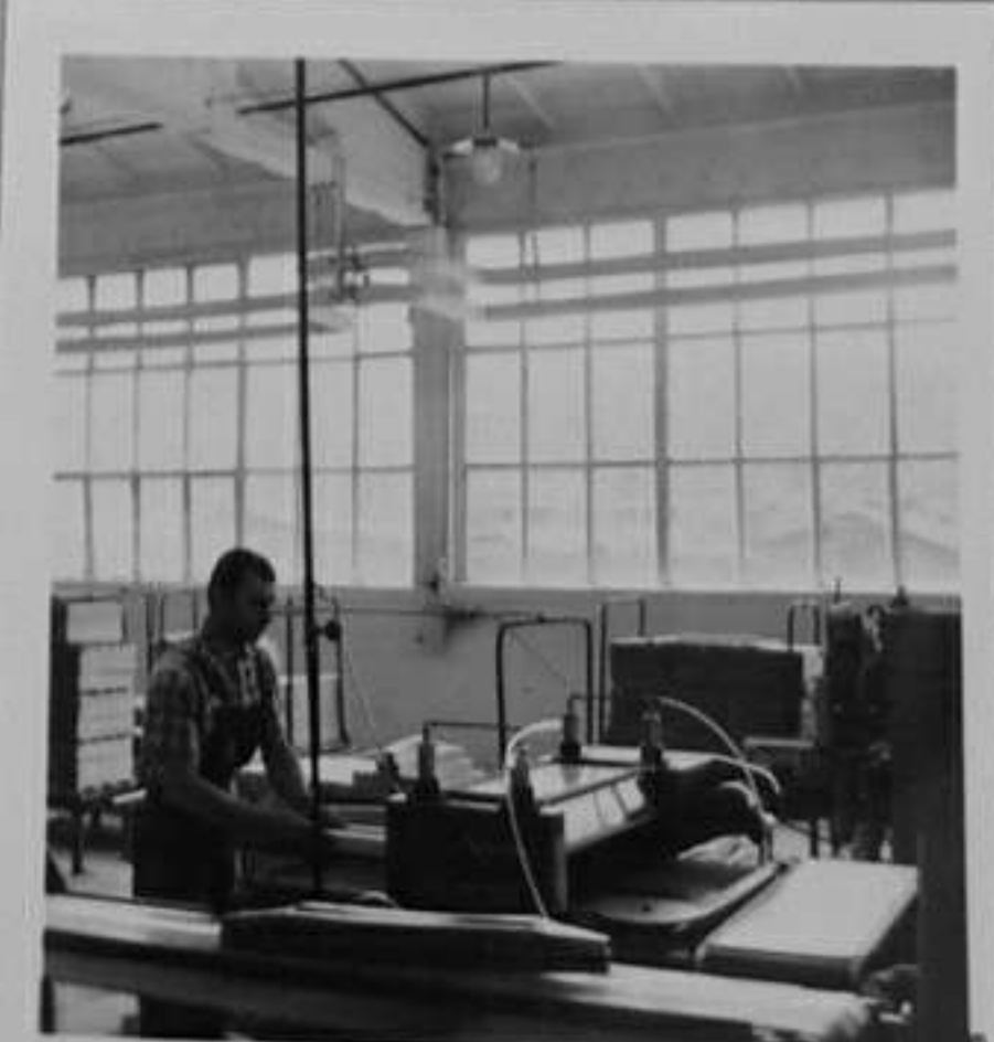
73-3056-9-Полуавтоматична копирфреза за надлъжно и проходно фрезование на детайли
