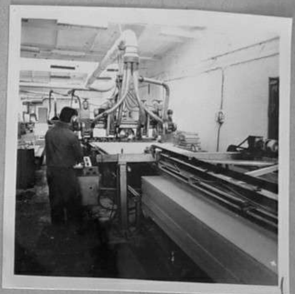
72-5549-1-По време на работа на тристраннообразващ циркуляр за разкриване и даване на точна дебелина. / Чобанов / ИК
