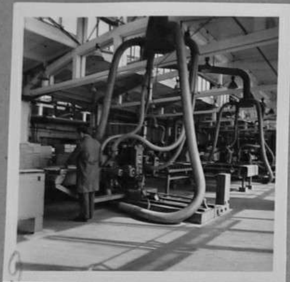
80-2444-9 Линия за обработка на плоскости от дървесни частици-ламинирани Р. Марукян/МД
