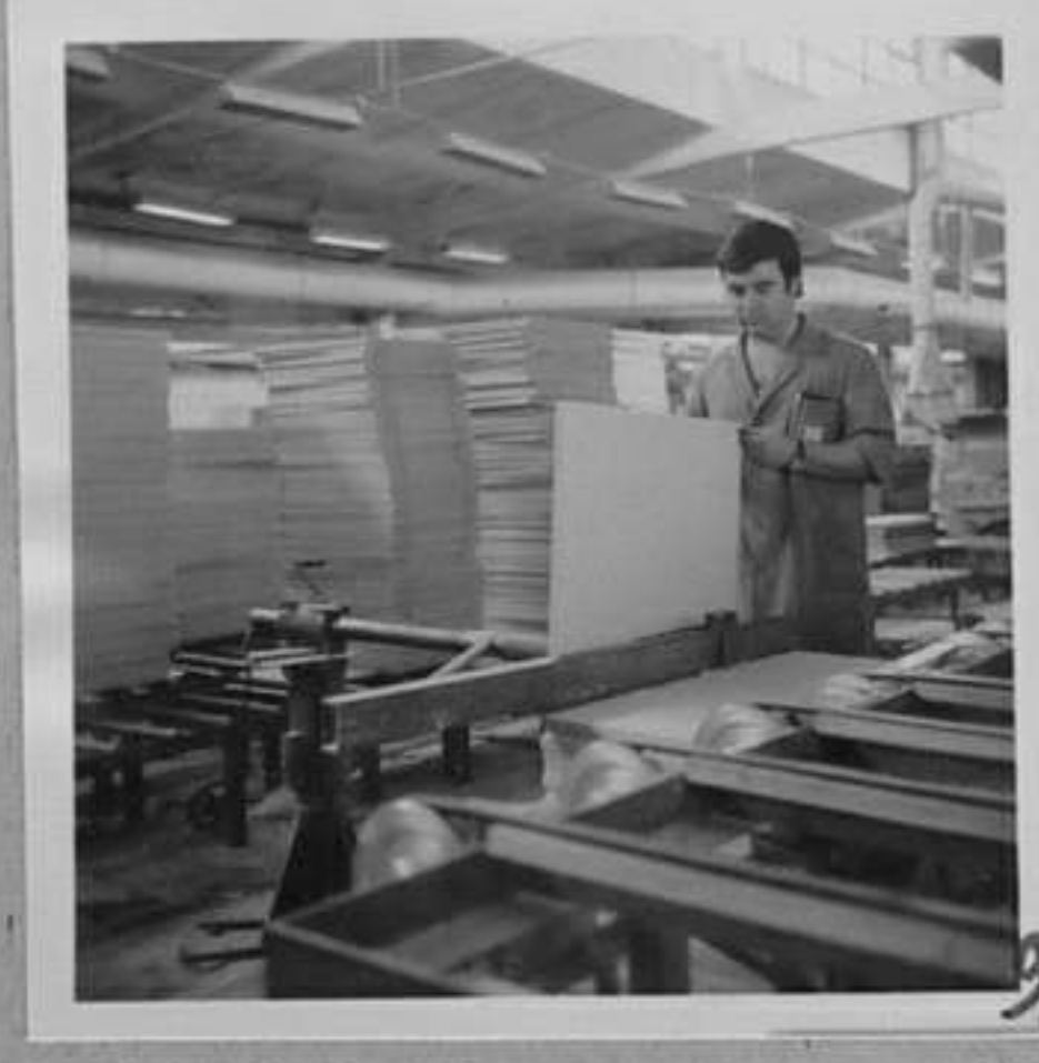
76-2813-9-Измерване дебелината на ПДЧ /готови площи/. /П.Божков/, ИБ
