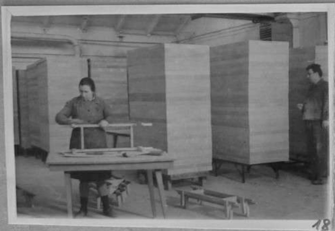
70-856-18,19-Комплексно внедрена система на палети в поточното производство в завода - икономия на място, опазване на материалите, голям капацитет на складиране, чист под, лесно почистване. /П.Божков/ ИК
