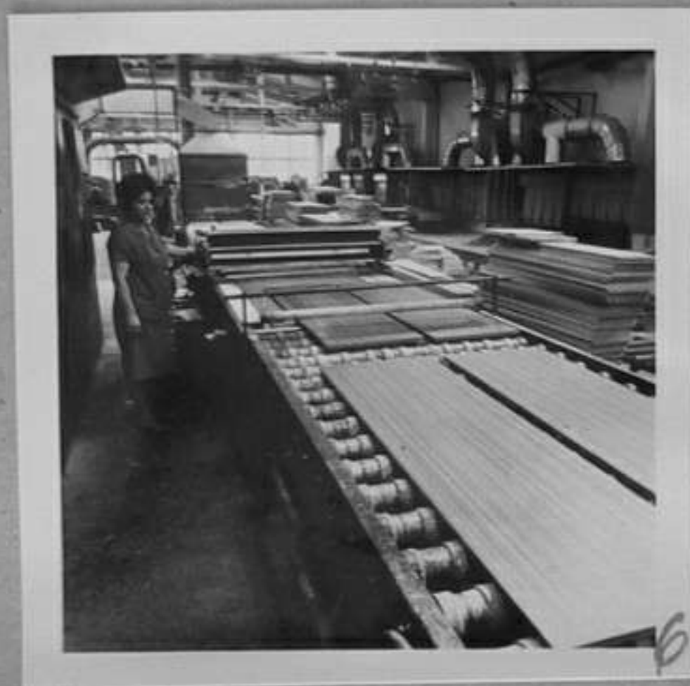
83-1387-6-Виолета Янкова работи на лакозаливаща линия за секционни плоскости. Е.Киров/ЛШ
