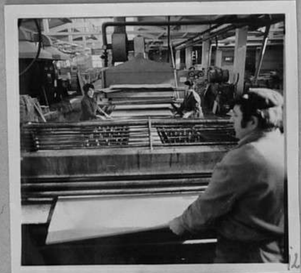
74-150-8,12-Едноетажна преса за залепване на фурнир върху дървесни плоскости. /Р. Марукян/ТК
