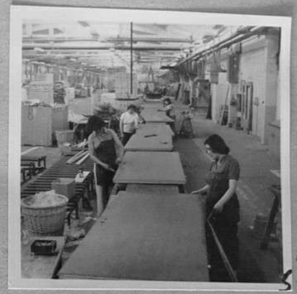
78-1733-5 Конвейер за монтаж за обков и остъкляване на крила за врати Ан.Цанков/МД
