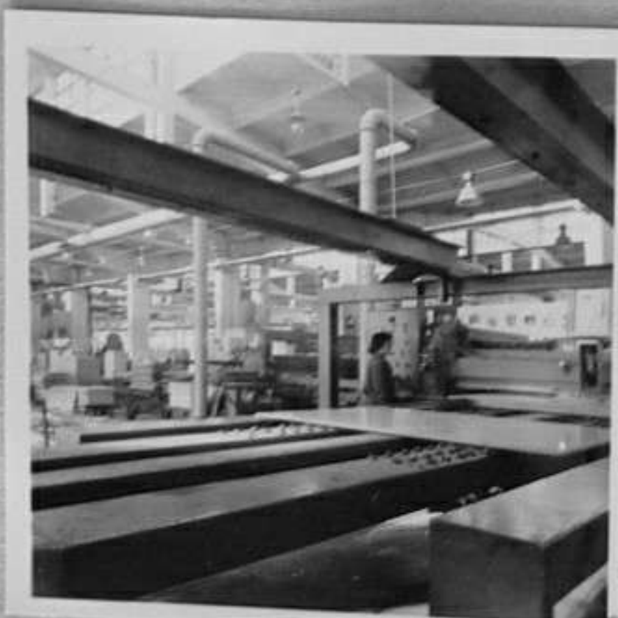
78-3870-12-Разкройващ аг- регат за ламинирани плочи. /Х. Румян/ АШ
