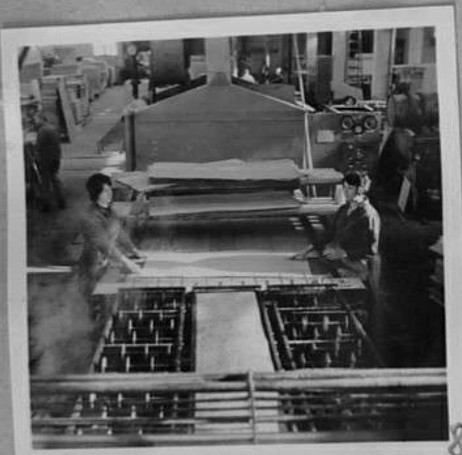
74-150-8,12-Едноетажна преса за залепване на фурнир върху дървесни плоскости. /Р. Марукян/ТК
