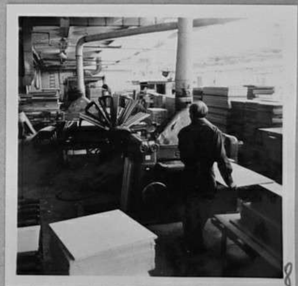
72-5549-8-По време на работа за двувалови шлайфмашини за калиброване. / Н. Чобанов / ИК
