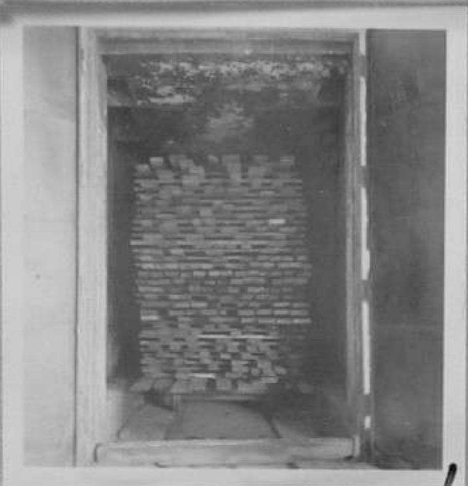
68-4612-1-Камера за сушене на материала с наситена пара при 90°. /Д.Рогев/ XII
