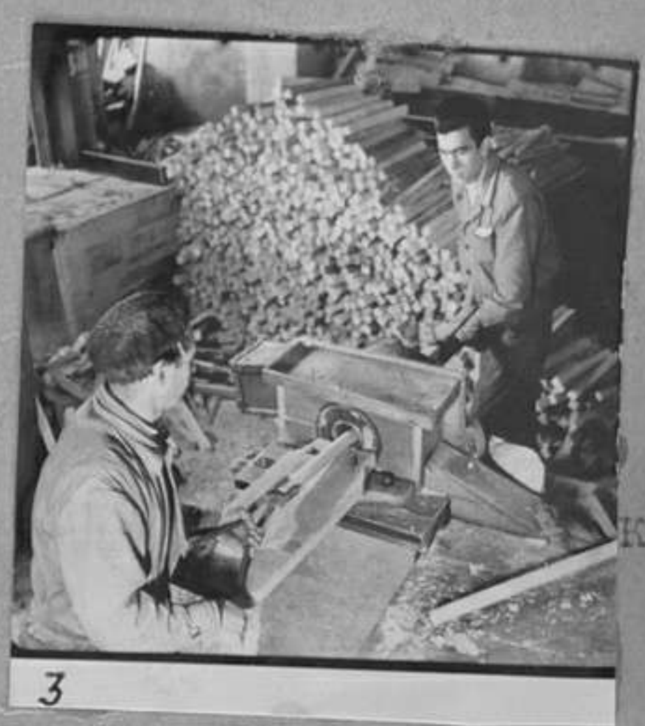
3-Обикновена бусола- за кръглени части на столове, обслужвана от двама души.
