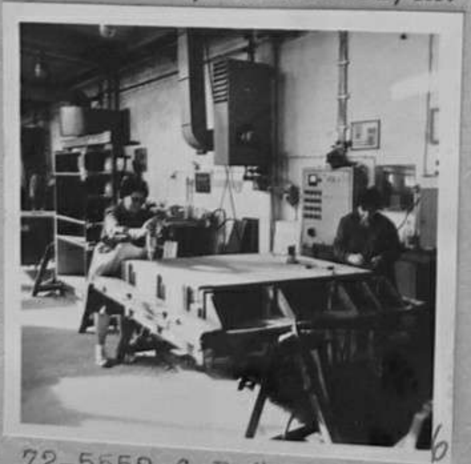
72-5552-6-Вайма за събиране на детайли в мебелно изделие. /Н. Чобанов/ИК
