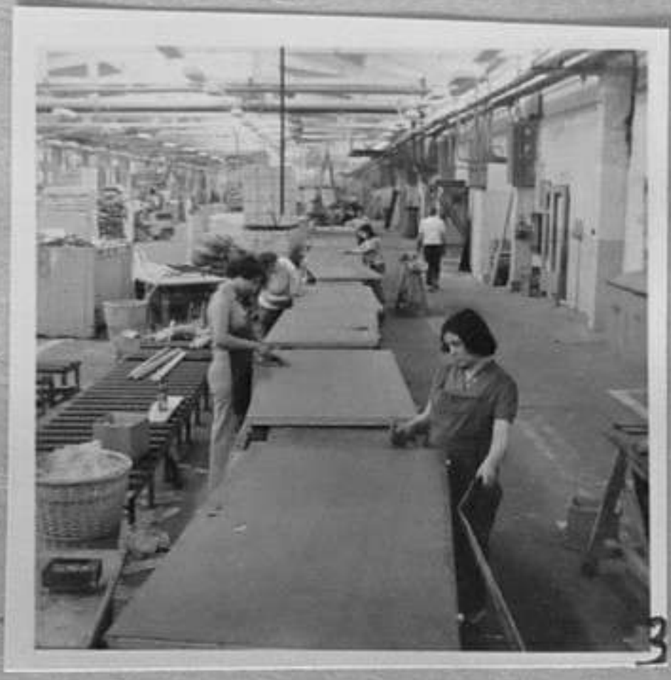
78-1733-3 Конвейер за монтаж на обков и остъкляване на крила за врати Ан.Цанков/МД
