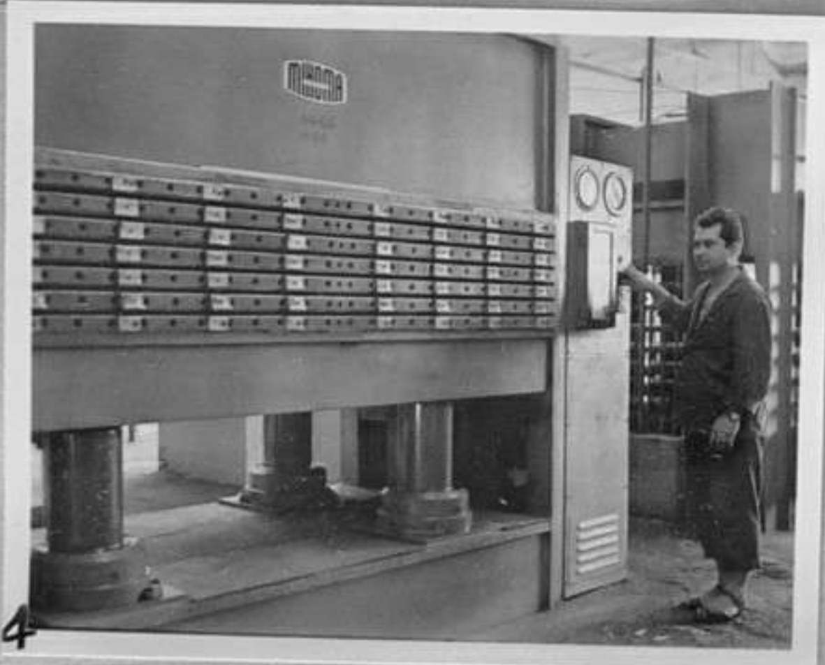
67-2737-4-Преса за залепване на фурнира към талашитовите плоскости. /Димитър Сибирски/СС
