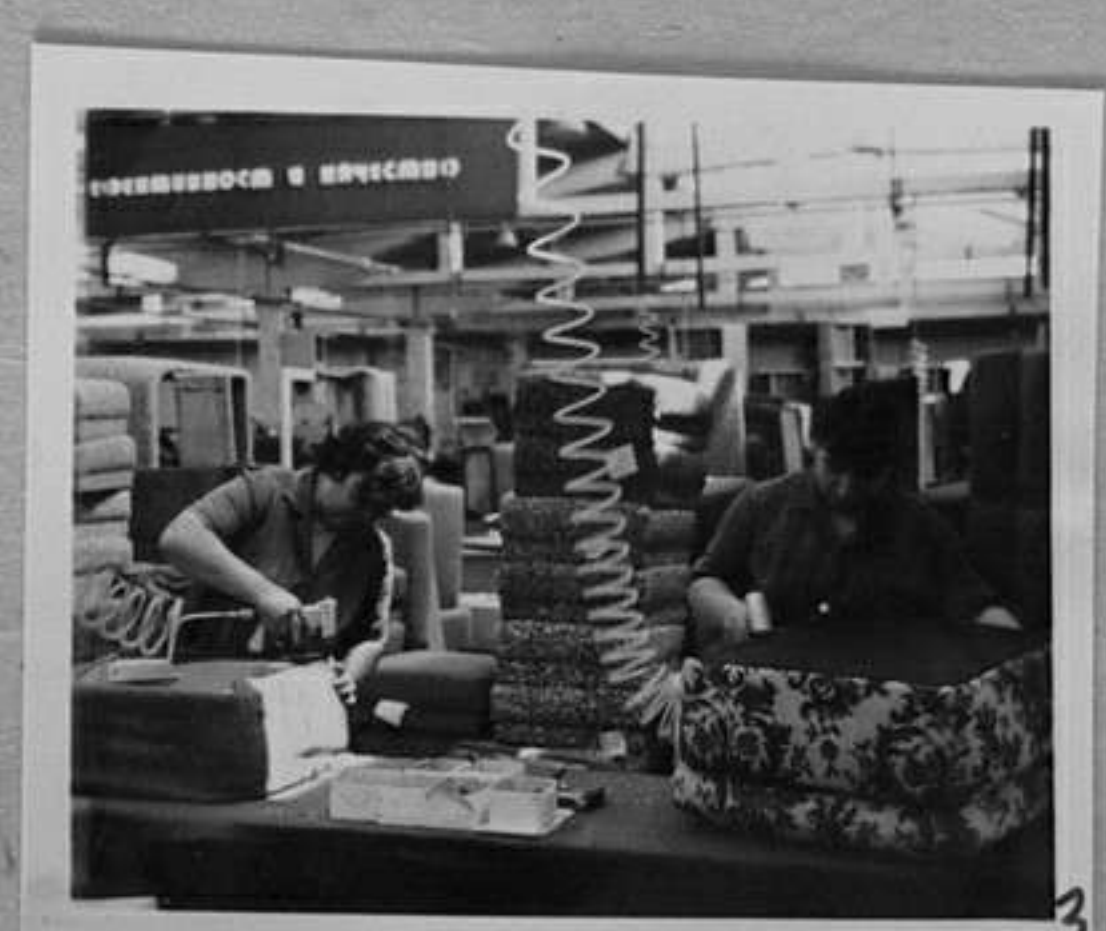
78-1917-2,3 Линия за тапициране и обличане на възглавниците на фотьойлите В.Балевска/МД
