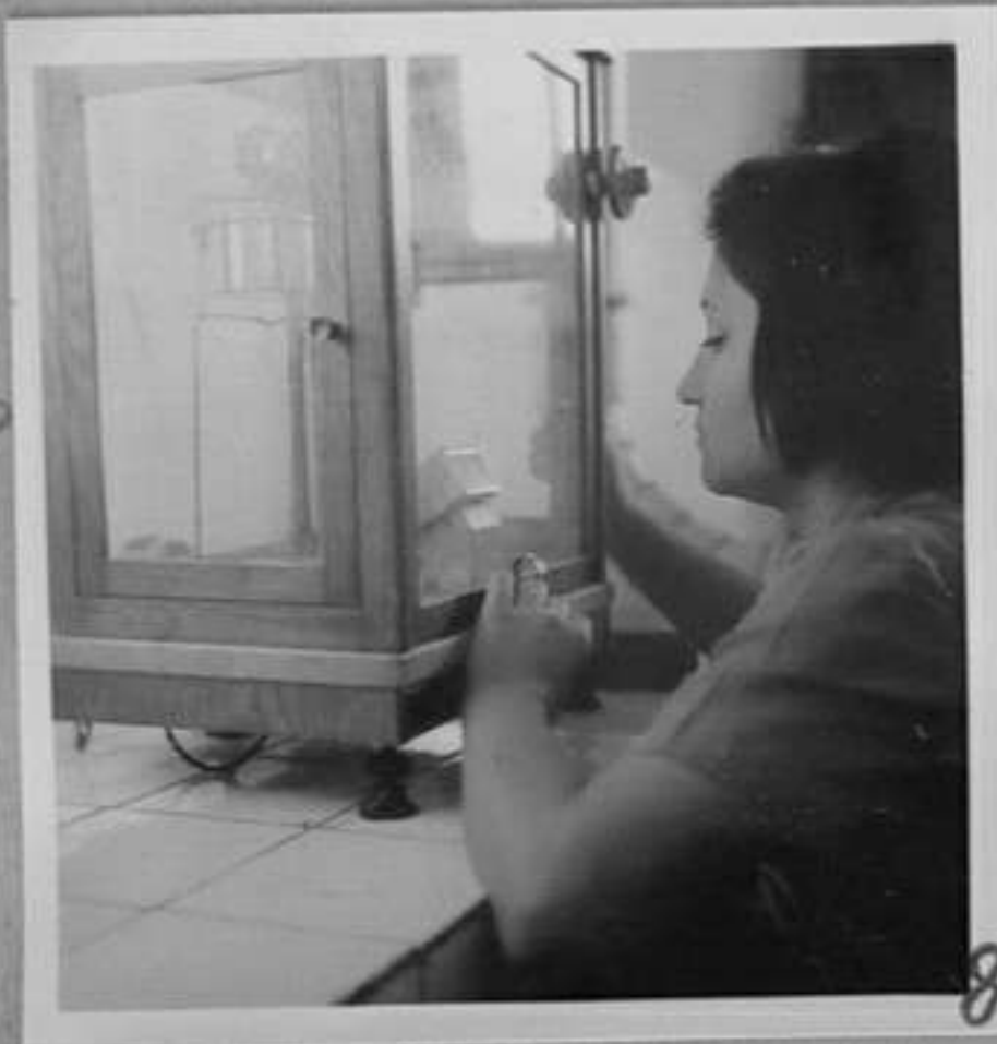
76-2813-8-В химическата лаборатория на завода: входящ контрол на лакове, чи от дървени частици/ лепила и байцове. /П.Божков/, ИБ
