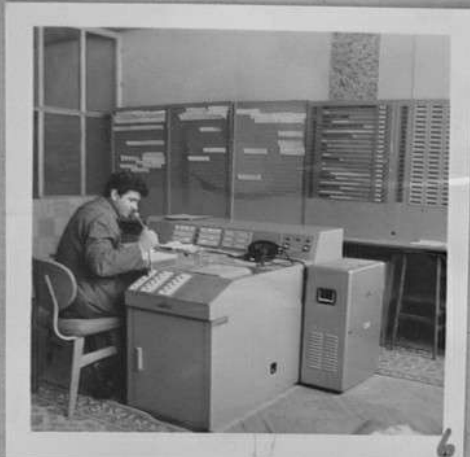
70-1-6-Продуктограф /дис-печерска уредба/ от която А.Бешков получава данни от машините за произведената продукция. /В.Иванова/ ИК
