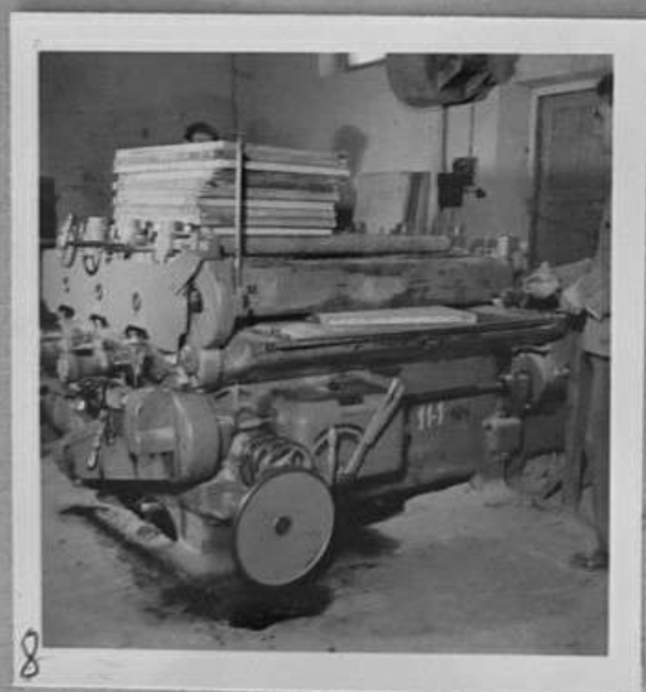
61/4211-8-Тривалова шлайф-машината за дървени плоскости /марка Михома-ГДР/. /Божков/
