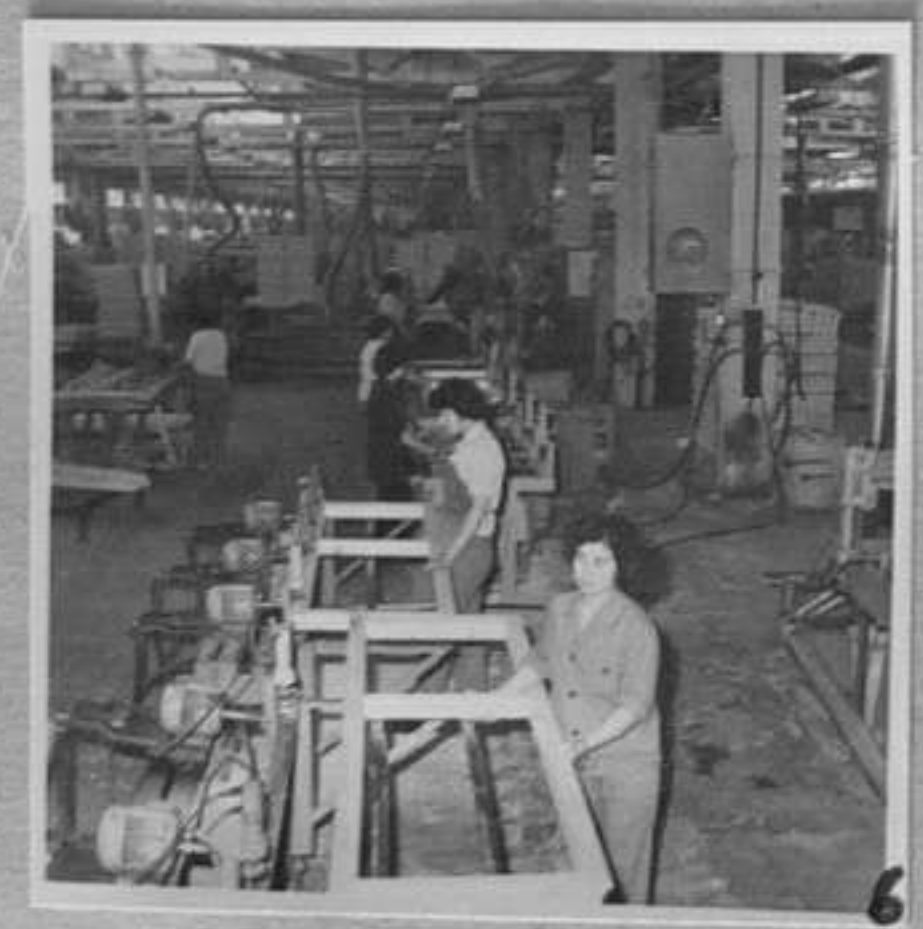
78-1733-6 Механизирана линия за фалцване и изработване гнезда за обков на крила за прозорци и балконски врати Ан.Цанков/МД
