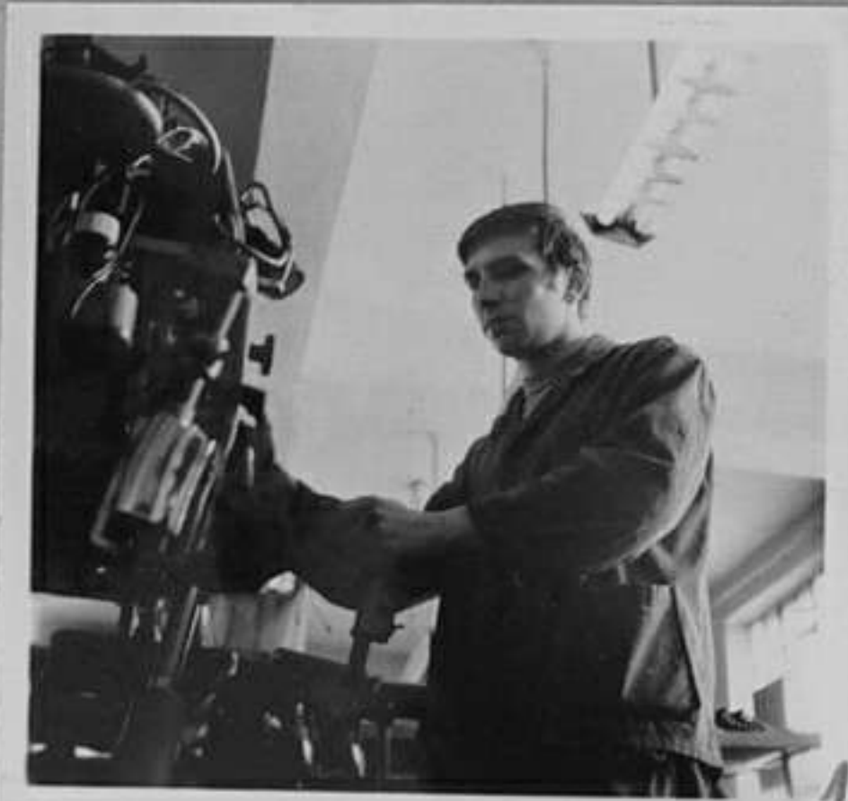
74-1632-1-На патавтомата Г.Петров, натегля обувката в петата. /А.Цанков/ТК
