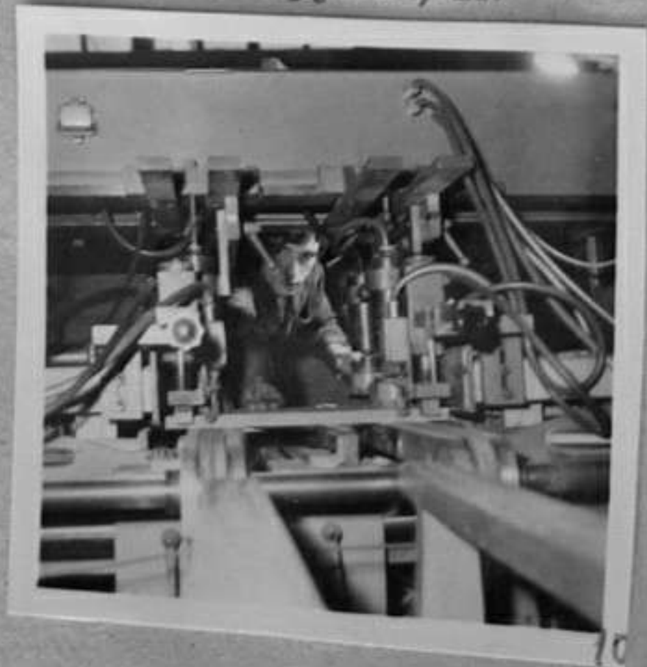
74-145-10-Тристанно-окрайчващ циркуляр за разкрояване на плоскости от дървесни частици. /Р.Марукян/ТК
