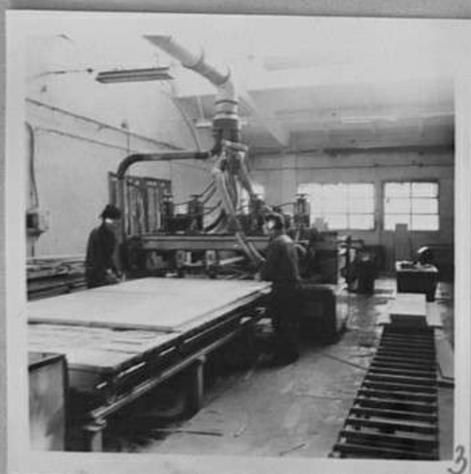
72-5549-3-По време на работа на тристраннообразващ циркуляр за разкриване и даване на точна дебелина на материала. / Н. Чобанов / ИК
