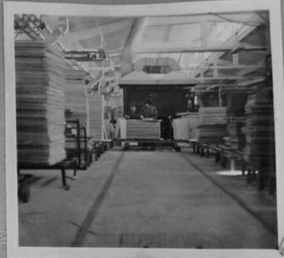
74-150-6-Шестетажна преса за залепване на фурнир върху дървесни плоскости. /Р. Марукян/ТК
