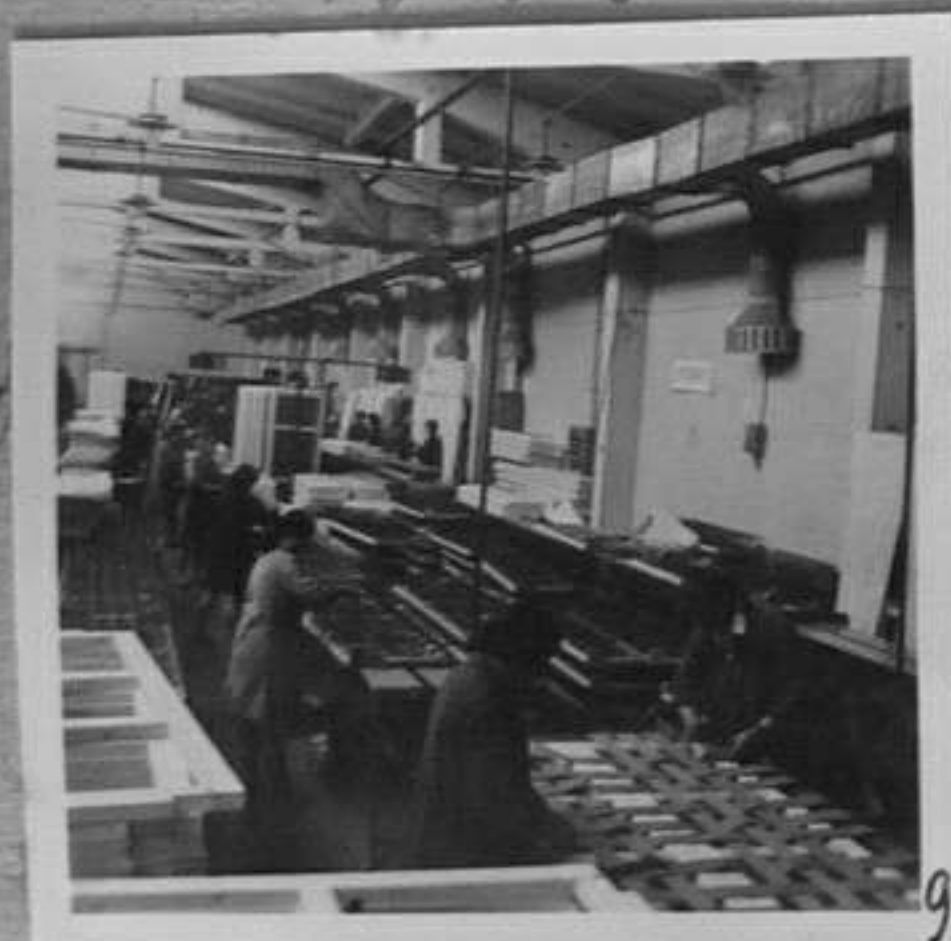
73-3063-9-Конвейрна линия за каналета. /В.Иванова/ТК
