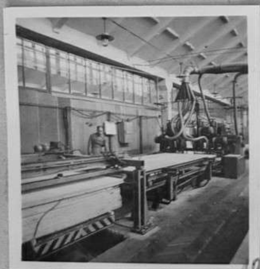
74-145-10-Тристанно-окрайчващ циркуляр за разкрояване на плоскости от дървесни частици. /Р.Марукян/ТК
