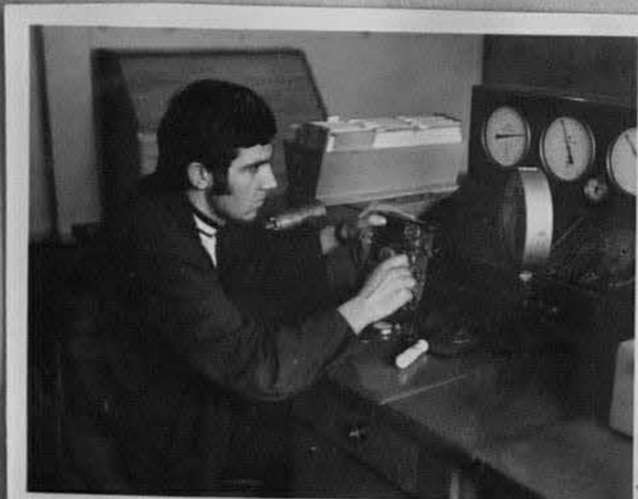
73-657-3-КИП и А-лаборатория авто- матика. Шлосерът по автоматика нас- тройва регулатор ПР 3-21. /Н. Чобанов/МК
