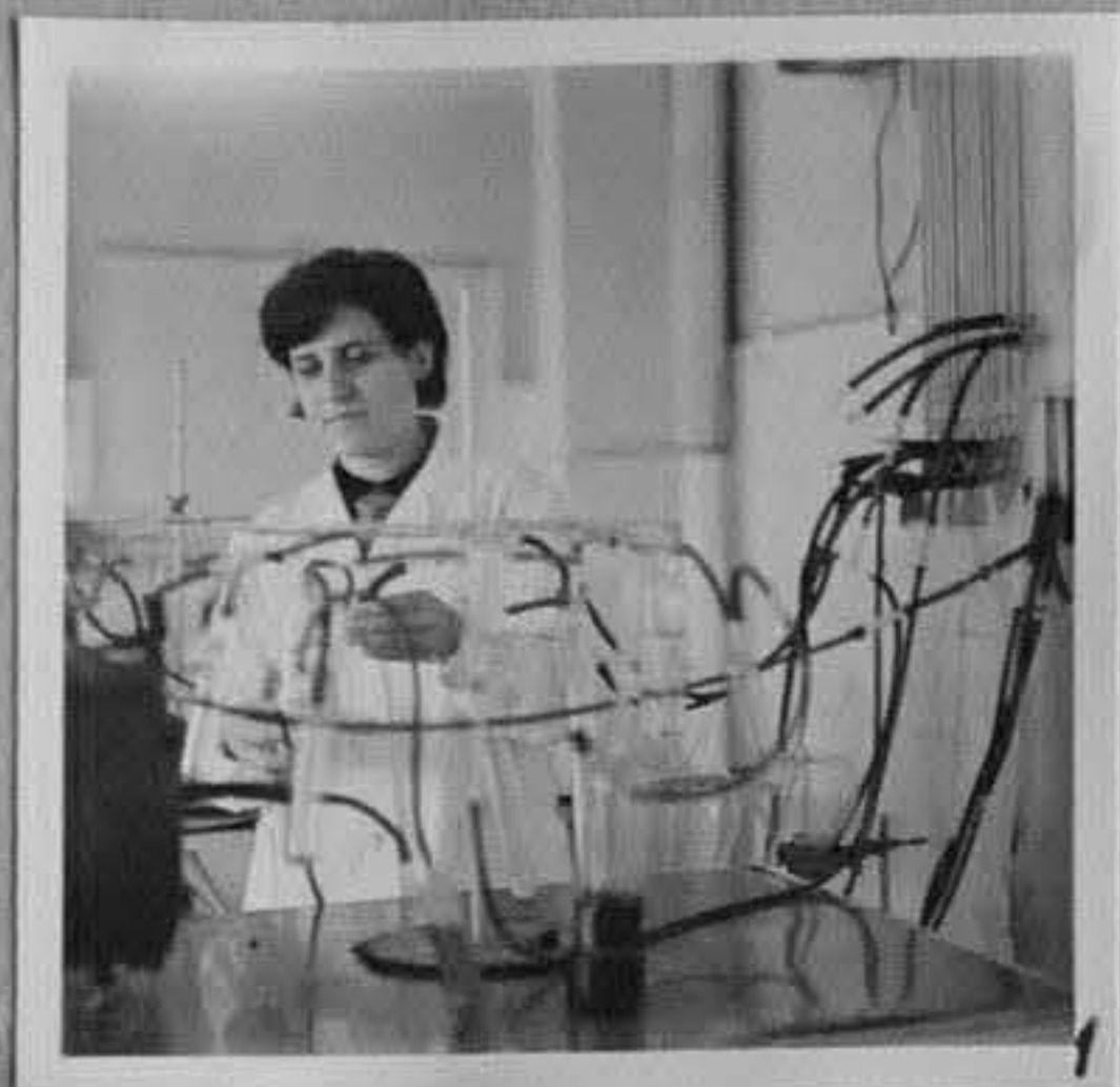
68-4862-1,2,3-Комсомолката З.Георгиева на работа при инсталацията за определяне на азотни окиси в газа пред камините. /К.Арсов/ XII
