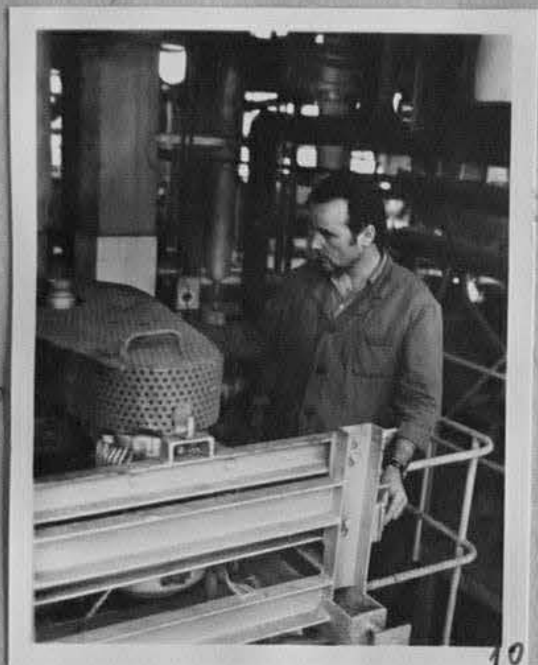
73-656-10-Цех "Капролактан" - отделение за дестилация и реак- тификация. Апаратчикът Стою Га- нев пуска изпарител на капро- лактан. /Н. Чобанов/МК
