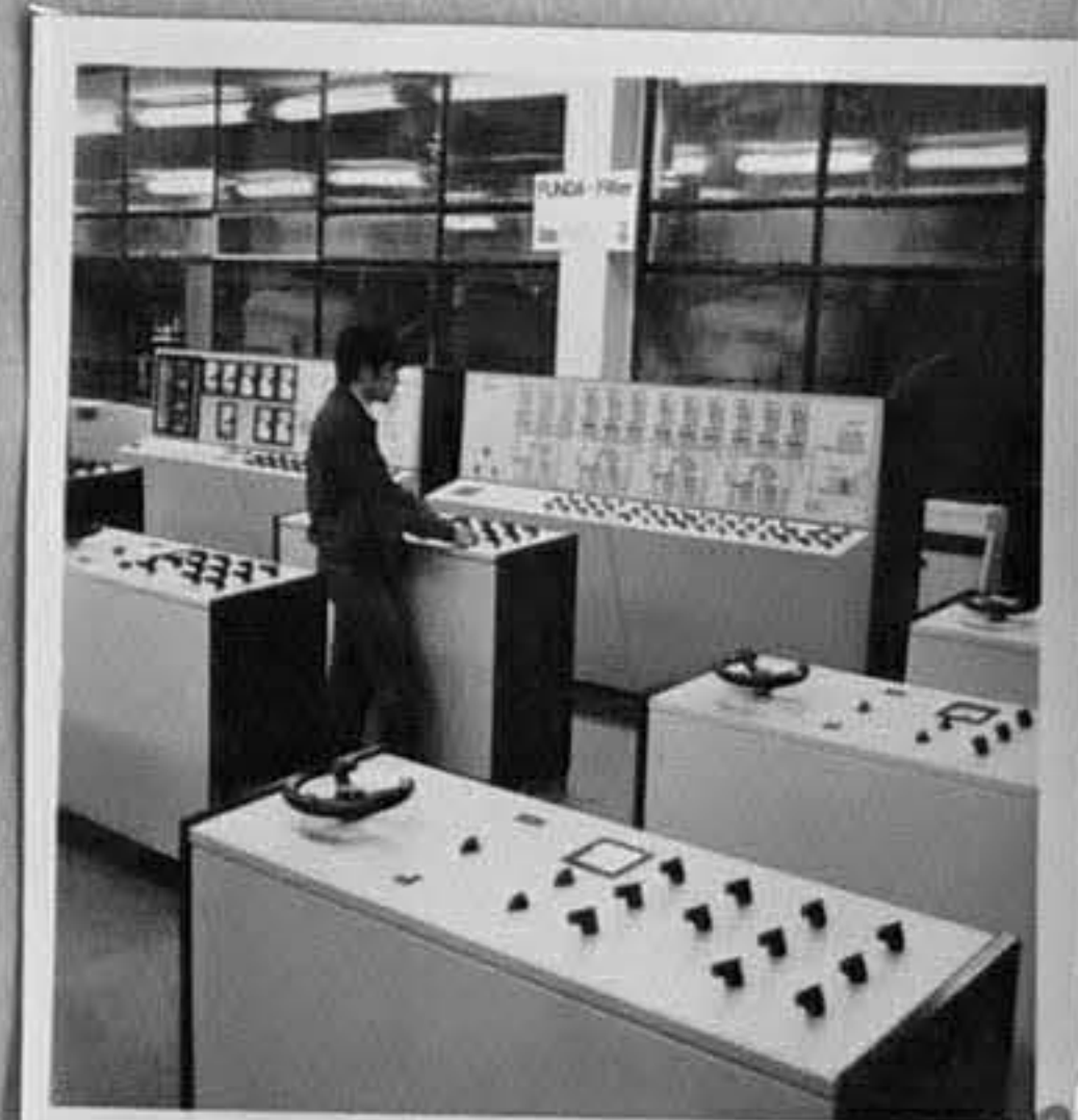
73-4845-10-В командната зала с частично програмно устройство на вискозното отделение. /Т.Хорисан/ТК
