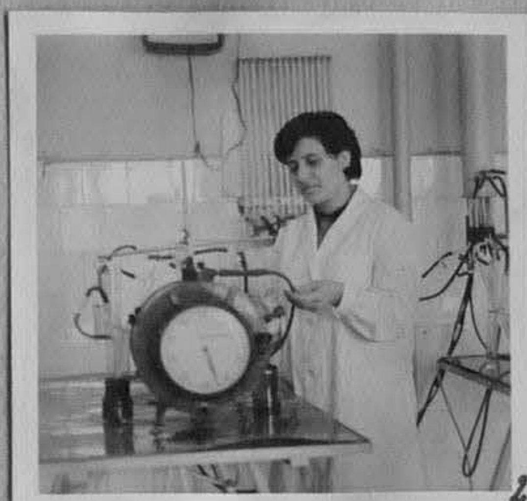
68-4862-1,2,3-Комсомолката З.Георгиева на работа при инсталацията за определяне на азотни окиси в газа пред камините. /К.Арсов/ XII
