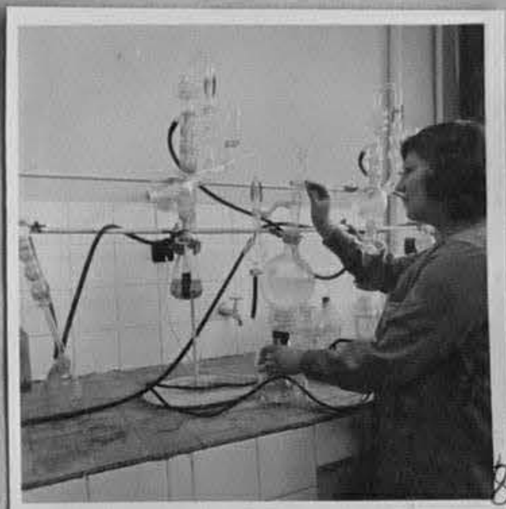
78-362-8 Лаборантката Величка Господинова изследва количеството на амоняка в промишлените води с апарата на Парнас-Вагнер
