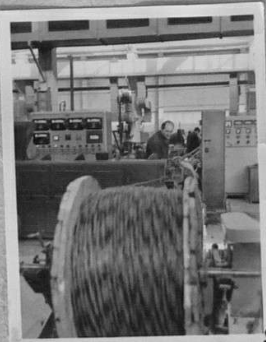
69-60-9-Екструдор за изоли- ране на проводници с ПВС. На машината работи Бойчо Бойчев. /Б.Юскеселиев/ XII
