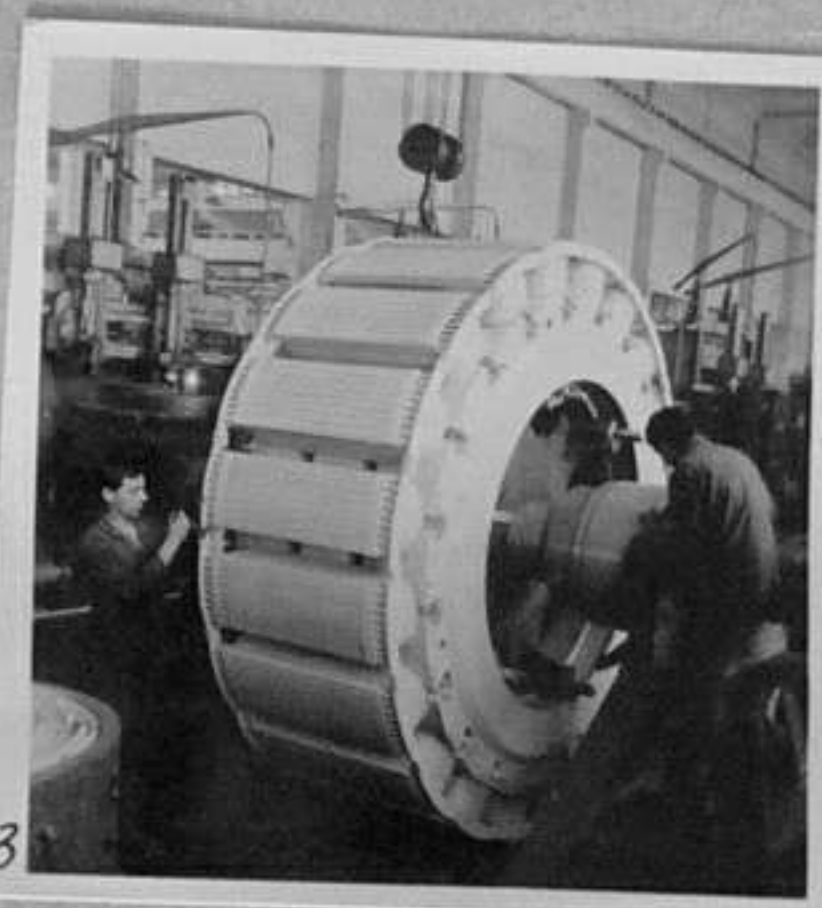
64/2457-3-Производство на ротори за новите 60-тонни генератори, произведени от завода. /Ангелов/ ММ
