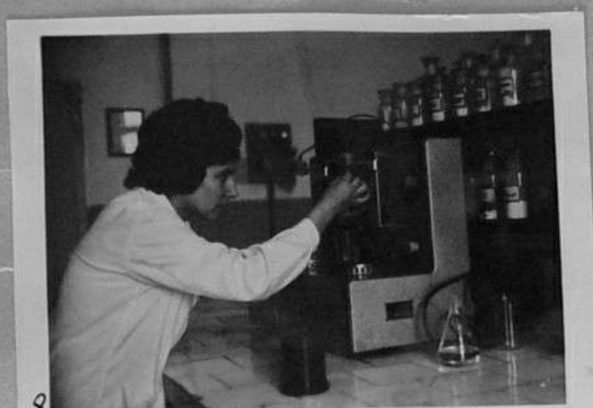
64/374-8-Лаборантката Василка Цветкова - определя мед в месинг чрез електролиза. /Янев/ ЕЧ
