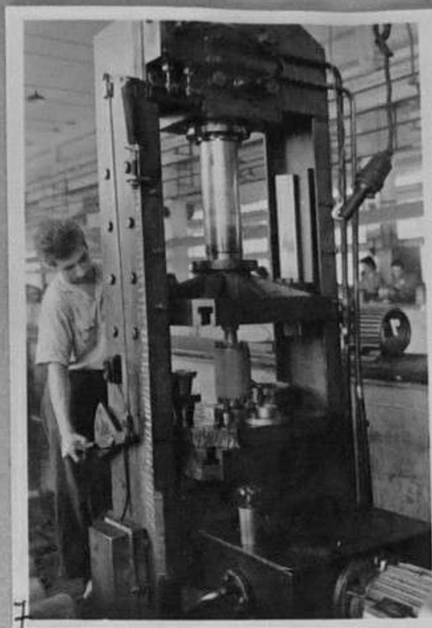
7- Пресборът Атанас Пайчовски работи на хидравлична преса за набиване валовите на роторите.
