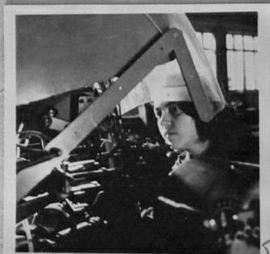
72-5534-3,4,5-Даринка Вастева работи на автомат за бобиниране на котви за ръчна бор машина. /Л.Чаръкчиев/ИК
