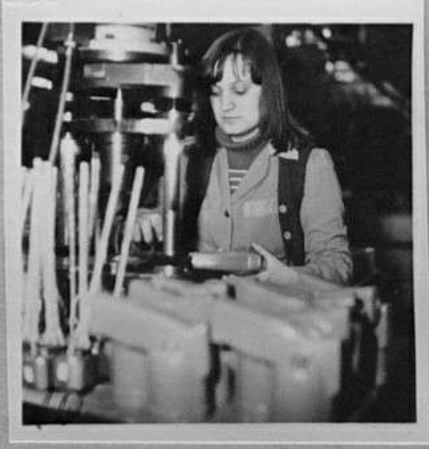
82-358-2 Поглед към цех "80" - монтажнен участък П.Донев/МД 82-358-6 Тотка Цветкова, партийна секретарка на първична парт.организация П.Донев/МД 82-358-10 Валентина Дончева Димитрова от цех "80" - монтажнен участък.Набиване на статорни пакети П.Донев/МД
