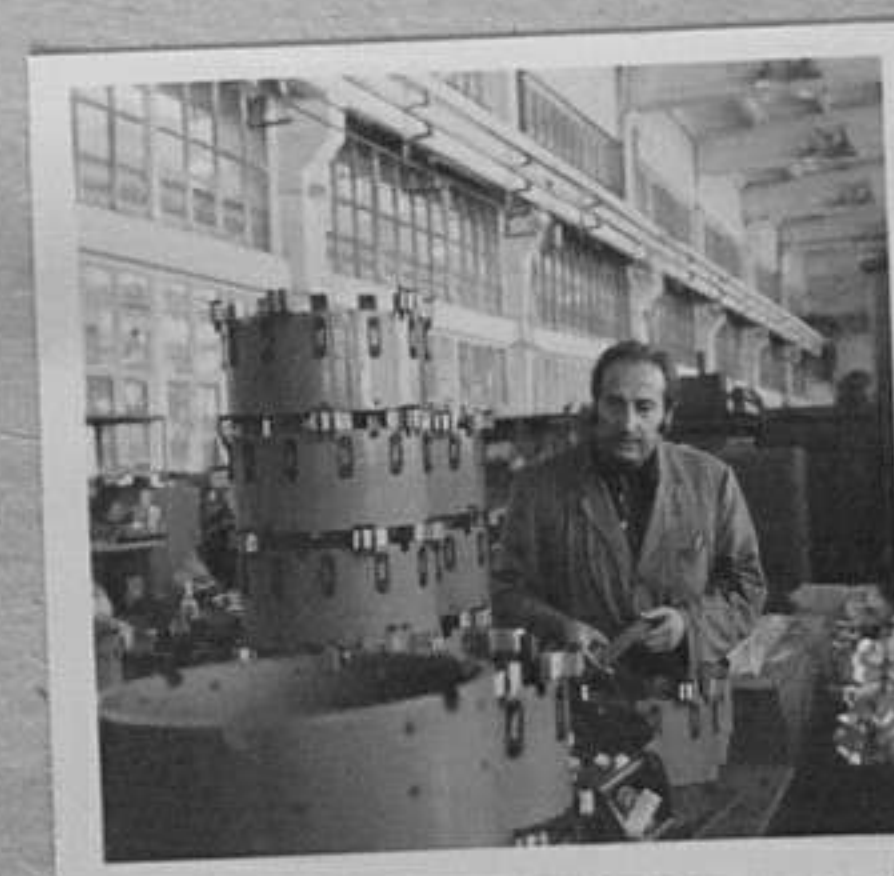
77-3205-10, 12 Инж. Константин Коцев работи върху кон- такти за мощен превключвател за стъпални регулатори 200 А Кр. Узунова/МД
