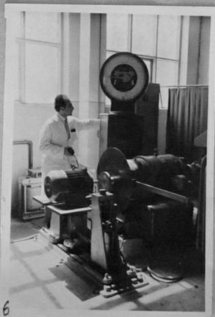
6-Изпитване на електродвигатели от 4 и 5 габарит с механично натоварване.
