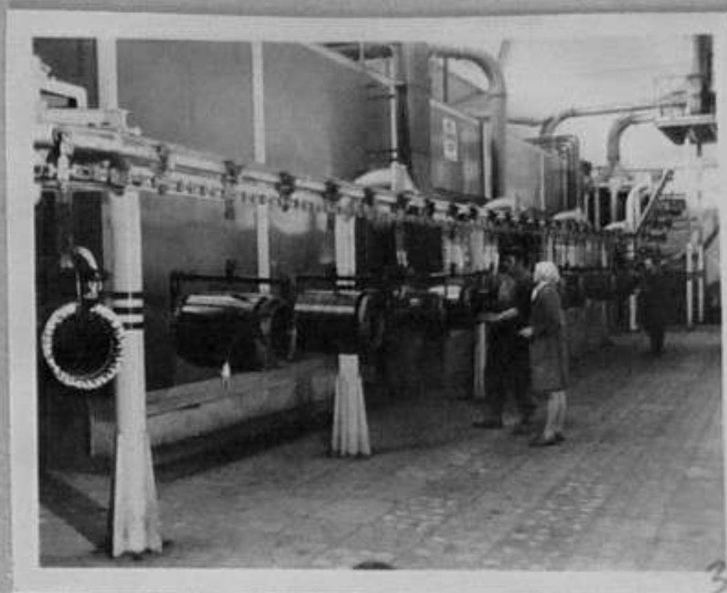
72-5511-3 - Автоматизирана уредба за импрегнация на статорни пакети за електро-двигатели. /Е.Любомиров/ЕИ
