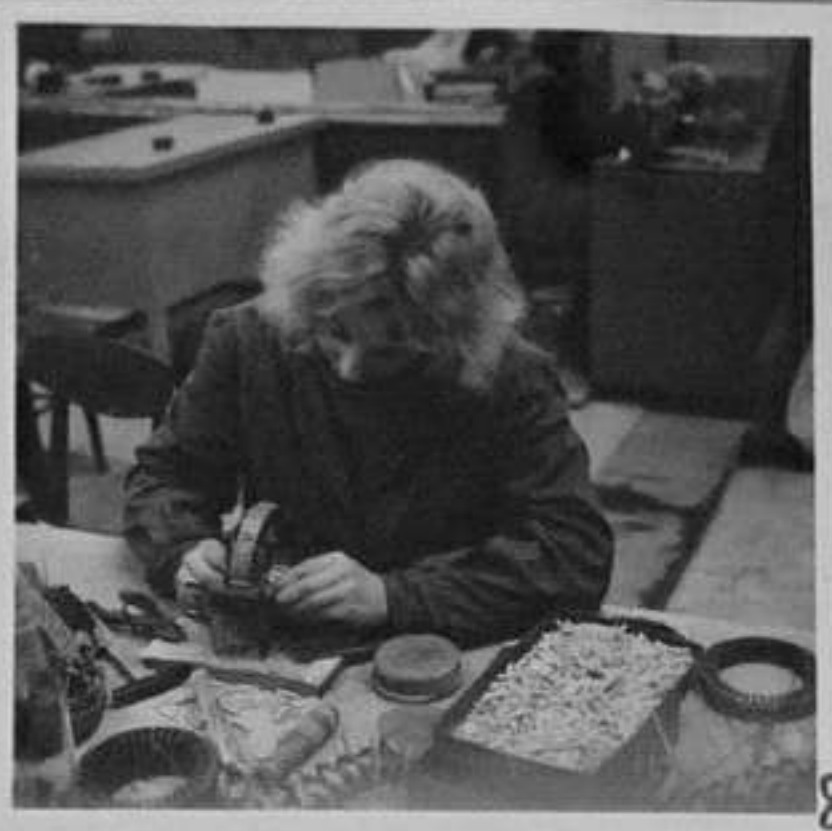
71-6410-8-Н. Тодорова изв. бобиниране на стартери на генератори. /Н. Чобанов/ МК
