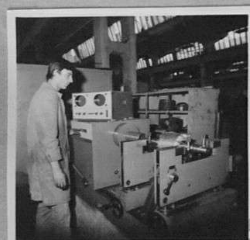
80-2332-3 Баланс машина за балансиране на ротори П.Найденев/МД
