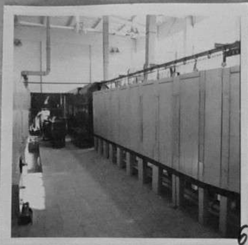
77-2341-6-Линия за електро- форезно грундиране корпуси на ел.двигатели. /В.Балевска/ЛА
