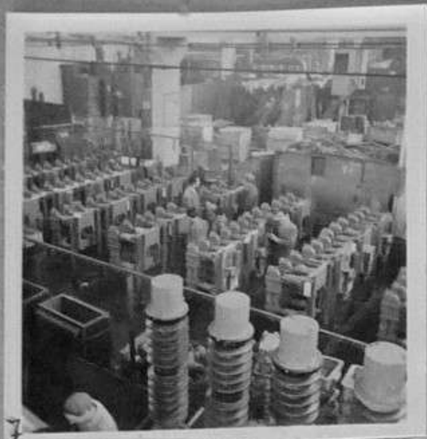
62/799-7- Стотици маломаслени прекъсвачи от 10 и 20 киловолта с външно подобрено задвижване биват подложени на последна кач. проверка преди да напуснат завода. Маломасл. прекъсвачи намират отличен пласмент в чужбина. /П. Божков/
