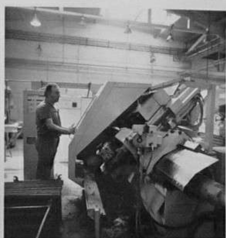
82-1490-8 Ив.Паскалев из- вършва обработка на вал за високомоментен двига- тел за металорежещи ма- шини В.Балевска/МД
