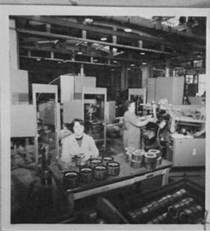
83-763-7 Автоматично бобиниране на статорен пакет на автоматична пералня В. Балева/МД
