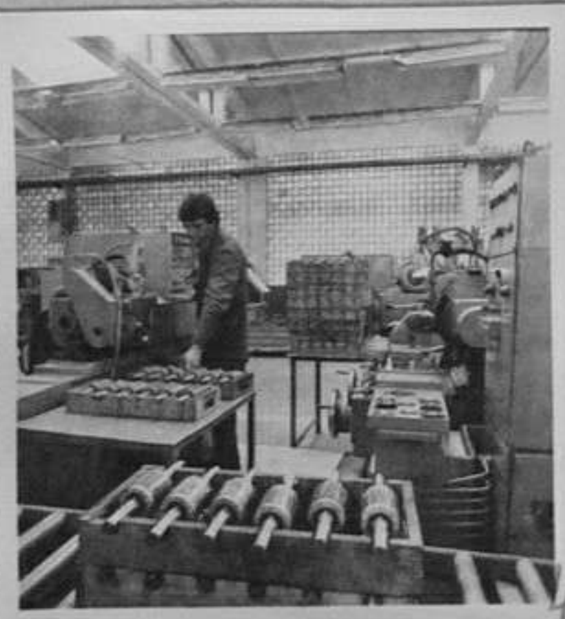
84-1597-4,5-Митка Стоянов, шлайфист, извършва шлайфане на вал-ротор. /В.Балевска/ЛА
