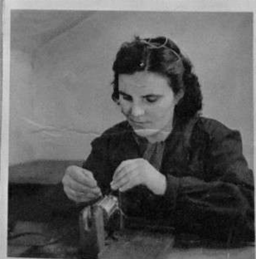
12-Изработване на полупроводни- кати за моторахлечи и телодина- мо.
