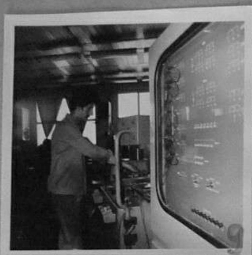
81-2255-9-9-Струг с програмно устройство "Пионер" за механична обработка на алуминиеви детайли. Ем. Богоев/АШ
