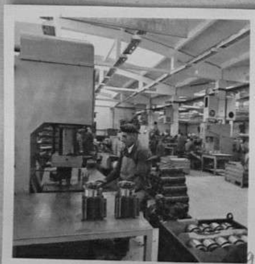
84-1593-9-Хр.Меев набива пила и пакет на електромотор. В.Балевска/ЛА
