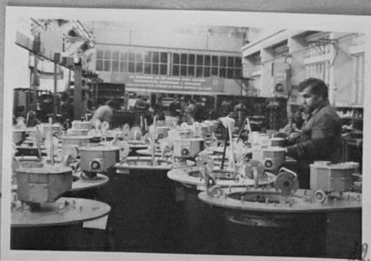
83-726-12-Монтьорът Цанко Василев - монтаж на маслен съд на стъпален регулатор. Г. Чакърян/ЛШ
