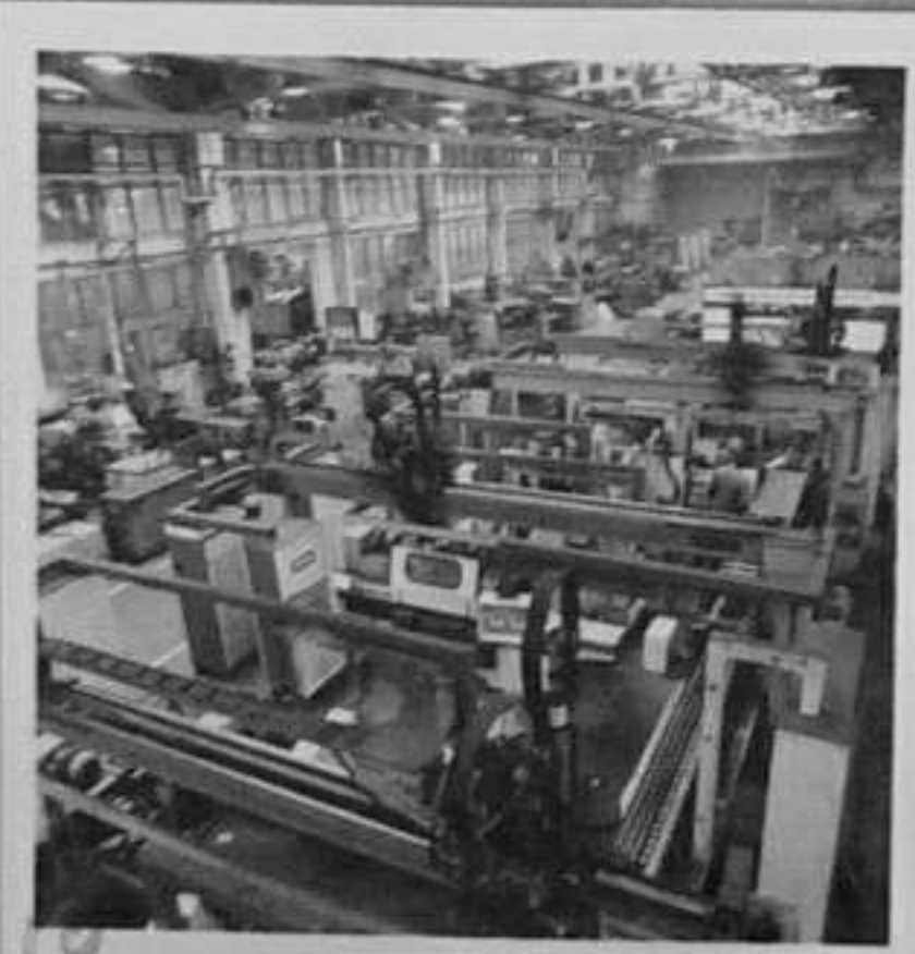
80-3545-10 Система ПИРИН М-78 четири портални манипулатора от лек тип, четири автоматични шлайф машини, като една от тях 011 е с ЦПУ/цифрово програмно управление/ Ем. Богоев/МД
