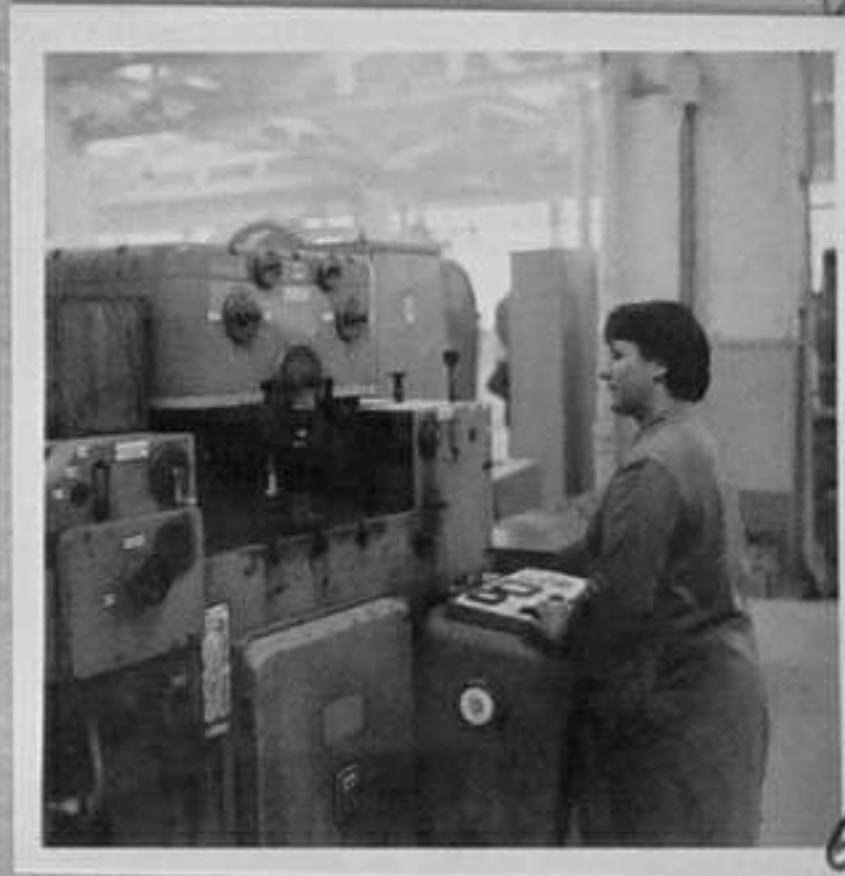
71-6409-6-П. Иванова пресова на преса РА 0-40 пакет на ротор на стартера. /Н. Чобанов/ МК
