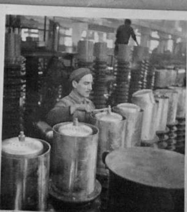
10, 12-Големи накомаслени кондензатори за 110 кило-волта в монтажния цех, където са подложени на постоянна проверка и зареждане с масло.
