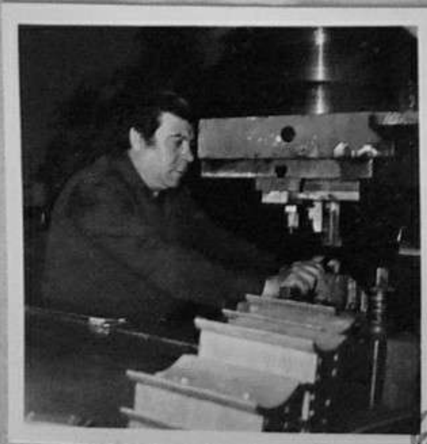
80-3545-10 Система ПИРИН М-78 четири портални манипулатора от лек тип, четири автоматични шлайф машини, като една от тях 011 е с ЦПУ/цифрово програмно управление/ Ем. Богоев/МД
