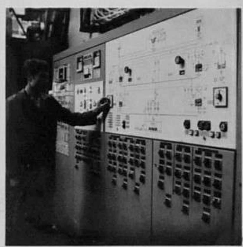
83-1439-3-Команден пункт на инсталация за леене на епоксидна смола. Е.Любомиров/ЛШ
