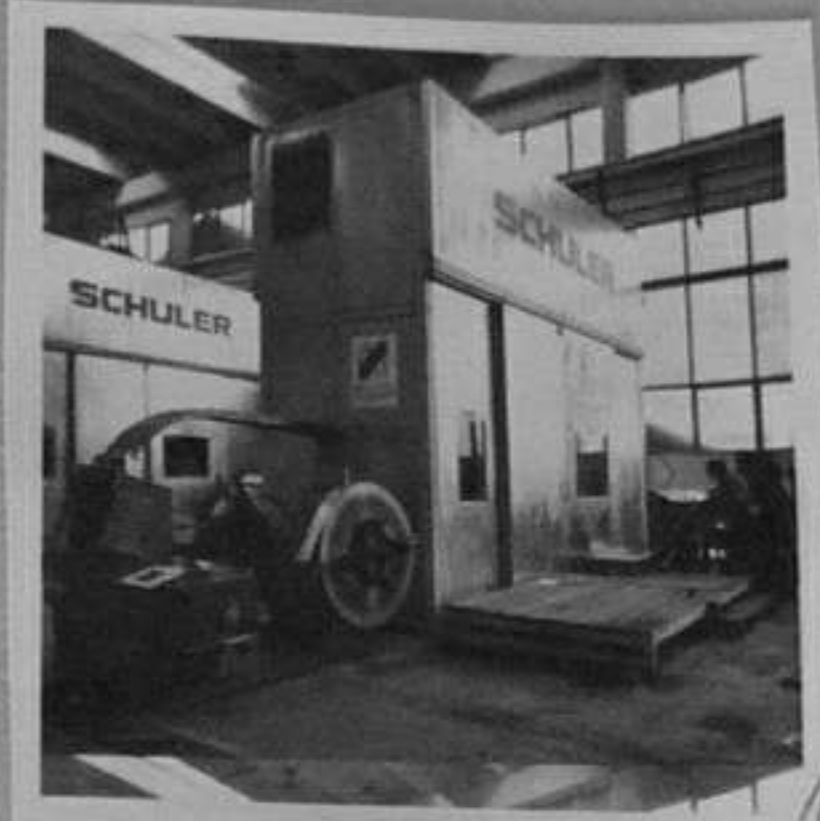
83-826-1 Автоматична пре- са за щанцване на ротори и статори Е.Любомиров/МД
