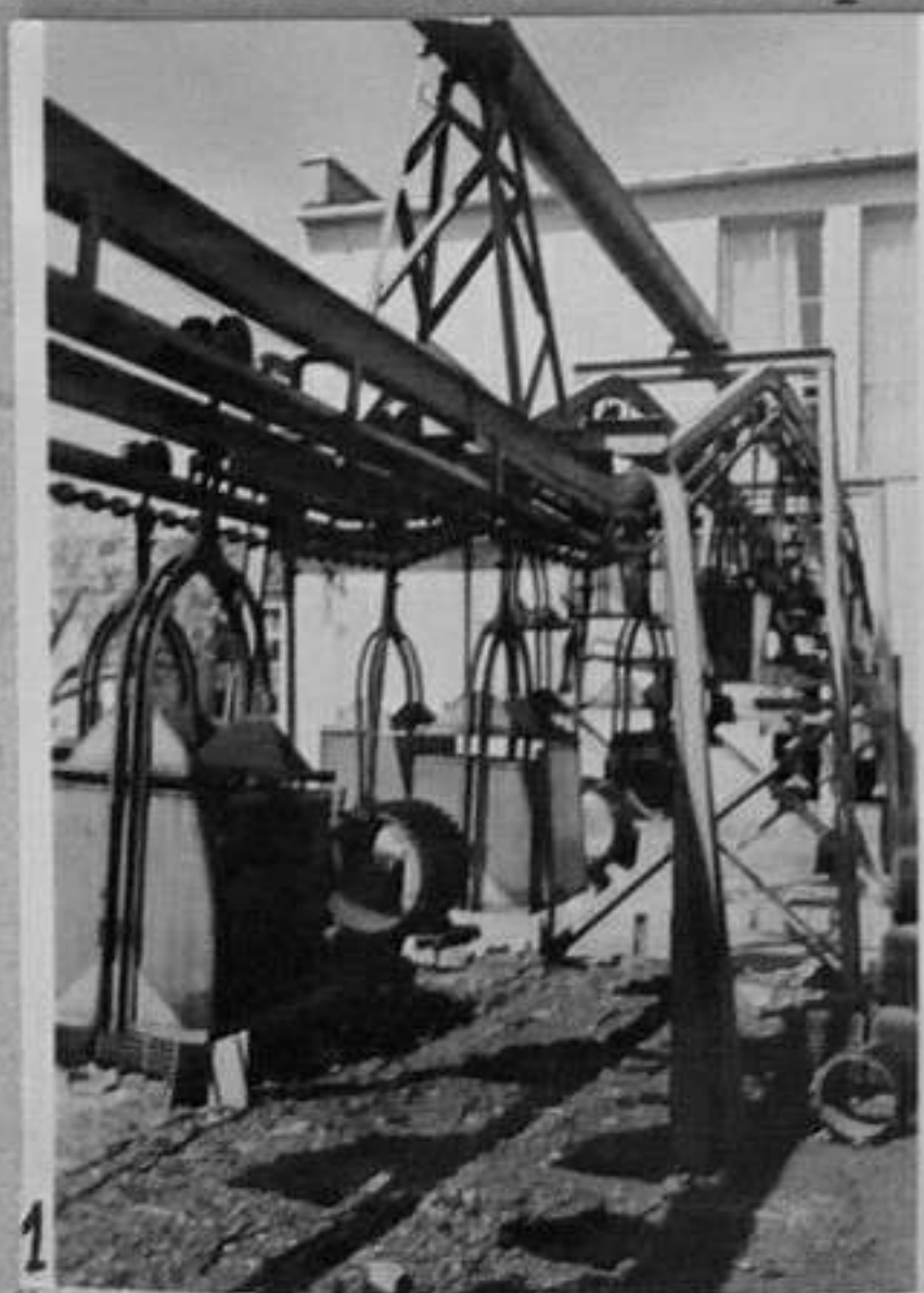
1-Конвейер за снабдяване на механичния цех с корпуси, статори и залати ротори.
