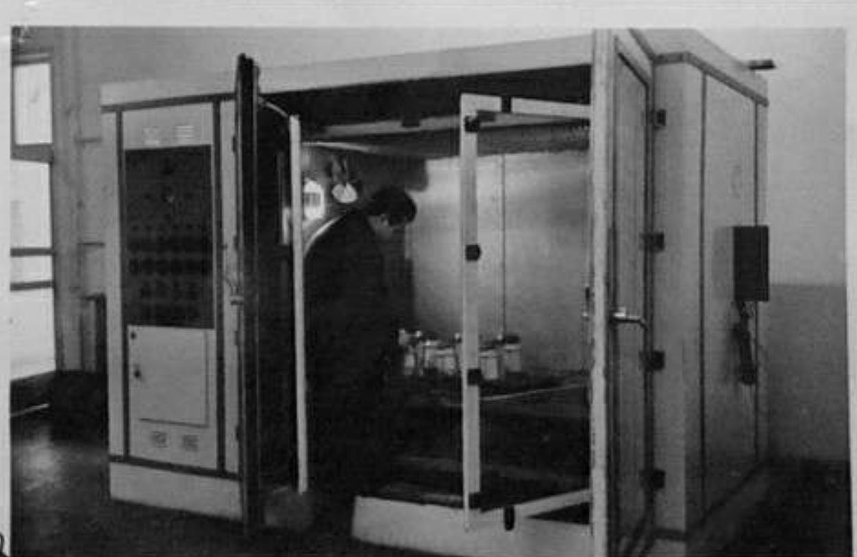
8-Камера за треническо изпитание на изделията, конструирана и изработена в завода.
