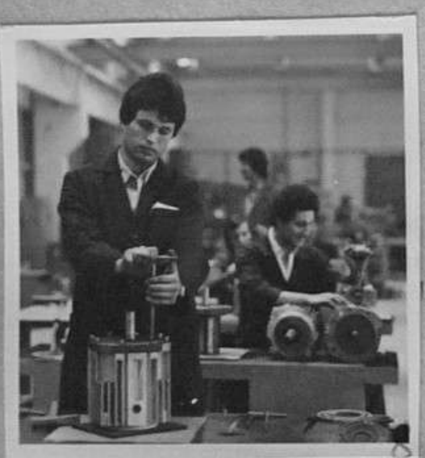
83-760-8 Монтаж на високо- моментни задвижвания Е.Любомиров/МД
