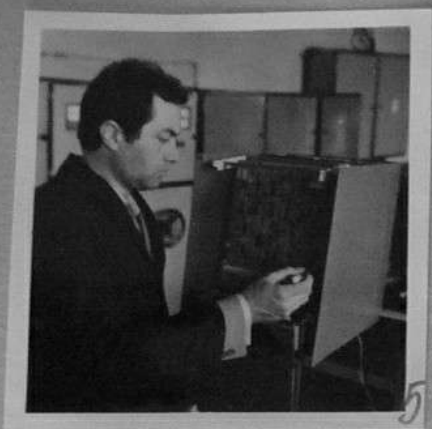
83-764-5 И.Ивовски - кон- структор, извършва настрой- ка и изпитание на опитен образец за асинхронно ел- задвигване В.Балевска/МД
