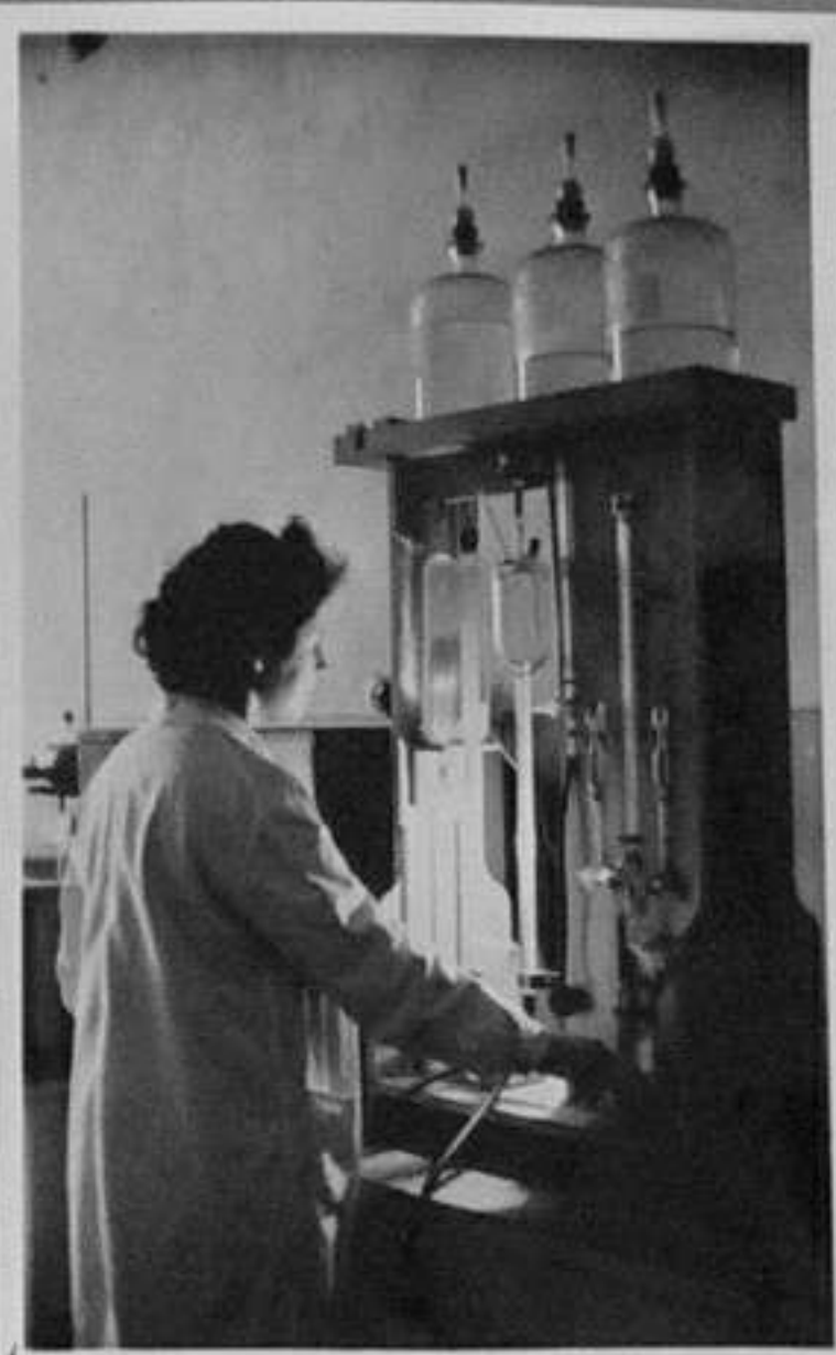
64/399-1-Определение въглерода и сярата в стоманата. /Янев/ ИМ
