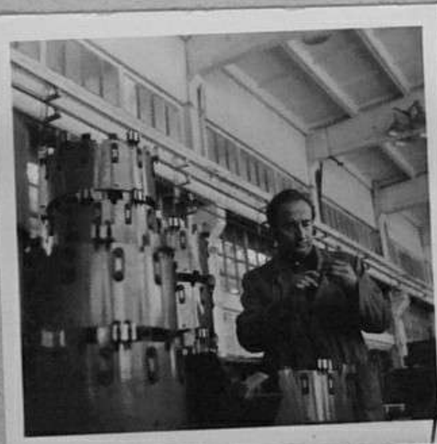
77-3205-10, 12 Инж. Константин Коцев работи върху кон- такти за мощен превключвател за стъпални регулатори 200 А Кр. Узунова/МД
