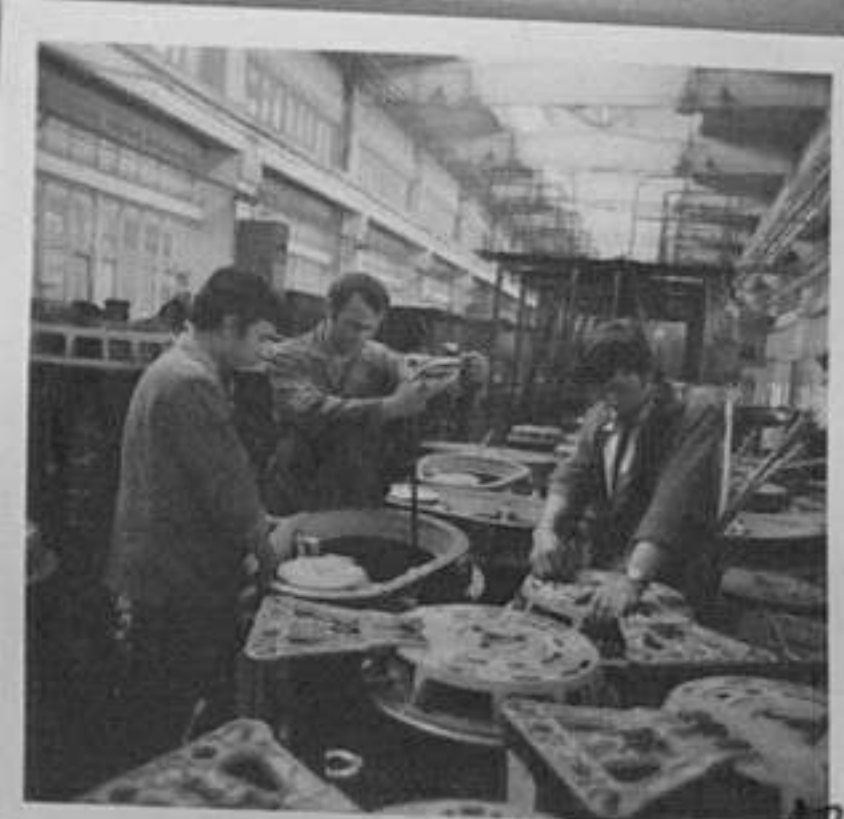
78-1926-13-Бригадата на Илия Атанасов от цех "Стъпален регулатор" извършва монтаж, центровка и изпитание на маслен съд. /М.Савова/АШ
