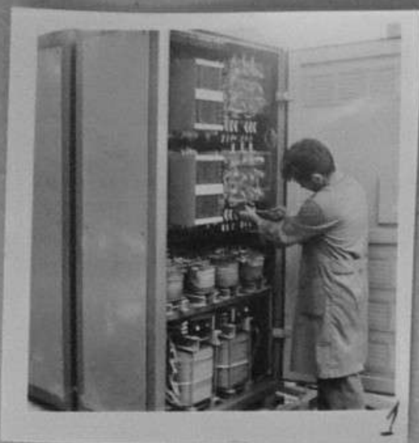
82-1501-1 Петър Ковачев - майстор производство, из-пробва шкаф за управление на високомоментни задвижва-ния Е. Любомиров/МД
