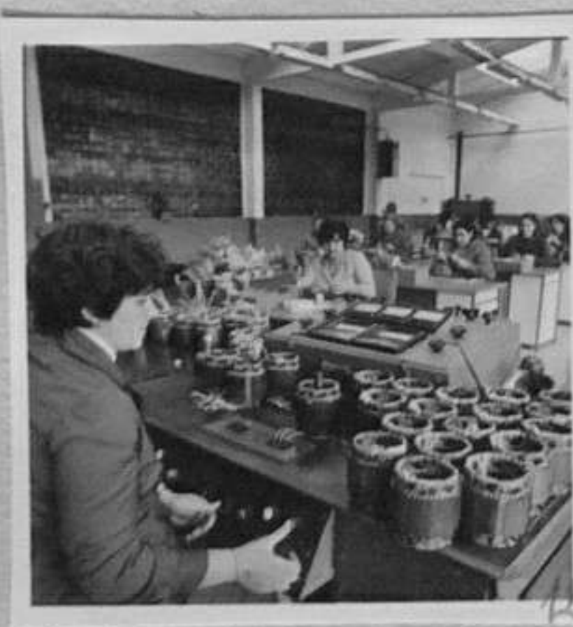
84-1597-12-Донка Петрова, ОТК извършва проверка на качеството на монтажа на ротора и статора. В.Балевска/ЛА
