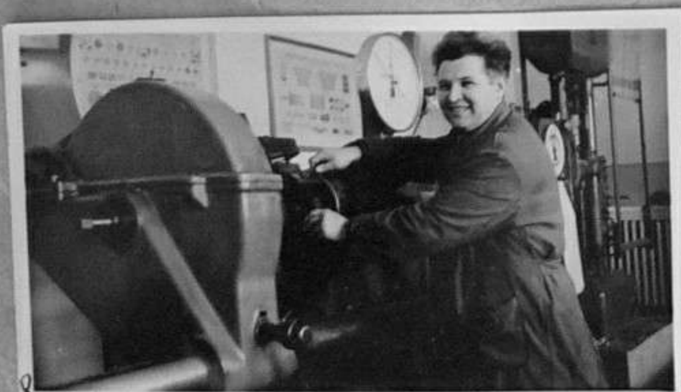
64/399-8-Снемане характеристика на пружини за маломаслени прекъсвачи. /Янев/ ИМ
