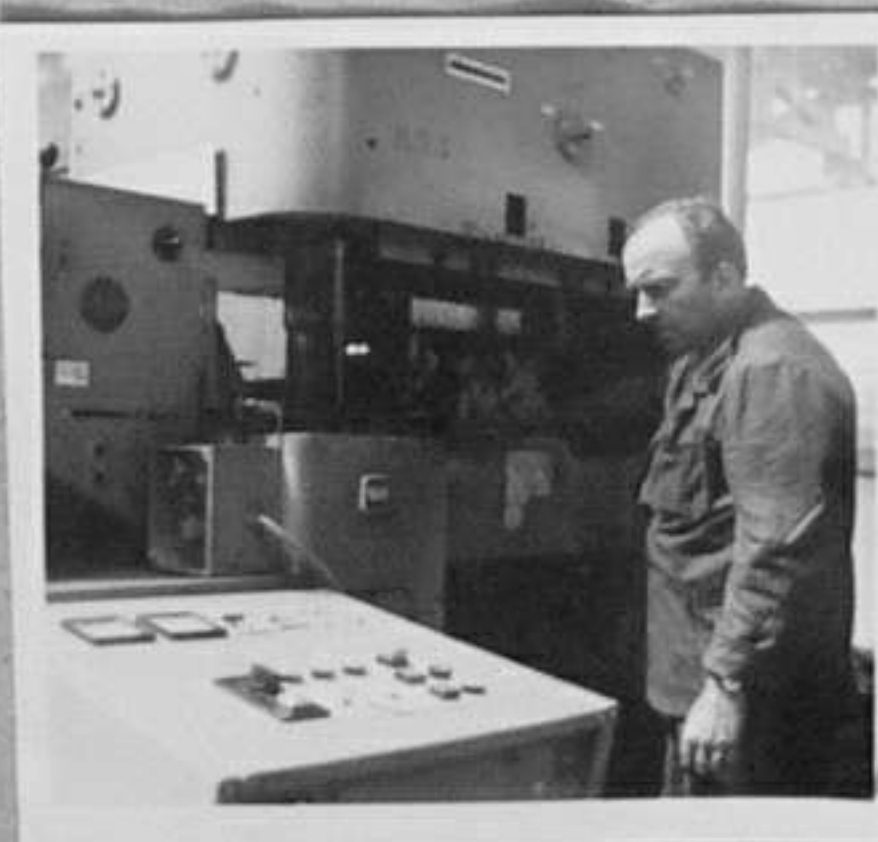
76-2704-4-Ангел Рангелов настройва машина за изси- тане на полюси за ел.мо- тори. /Е.Киров/ЛА
