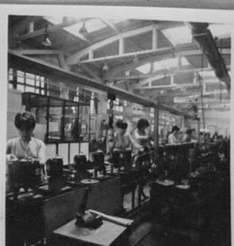
82-1490-9 Конвейер за пълнен монтаж - проверка и опаковка на стартери В.Балевска/МД
