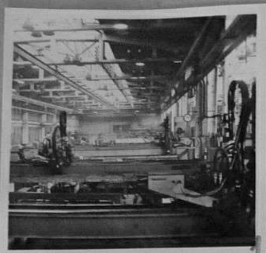
80-4071-1,3,6 Автоматична линия за обработка на валове за електродвигатели с капацитет 100 хиляди броя годишно, която се обслужва от "човека, преминал през квалификационен курс Г.Чакърян/МД
