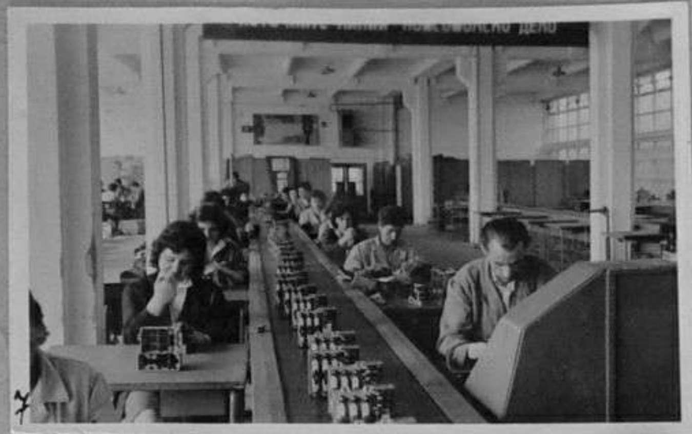
7-Изглед от монтажния конвейер за производство на въздушни контактори-КВ-40.
