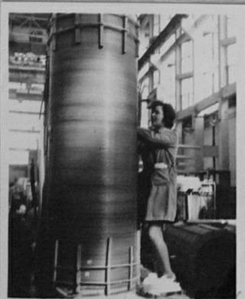
72-5510-6 - Пенка Василе- ва изолира вторична на- мотка за трансформатор. /Е. Любомиров/ЕИ
