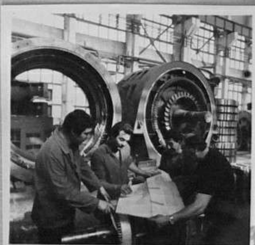
80-2332-9 Каруселен струг "Рафамед" за калиброване на статори Р.Марукян/МД
