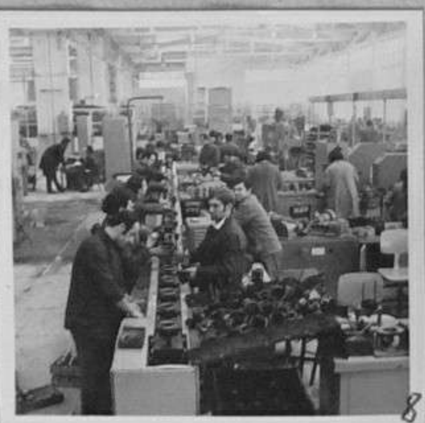
71-6411-5-М. Георгиева изв. монтаж на ротор на стартер. таж на стартери. /Н. Чобанов/ МК
