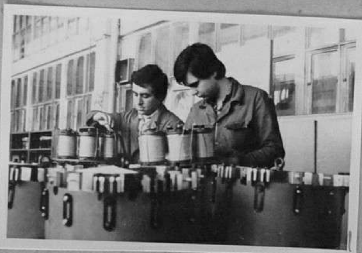
83-726-11-Иван Петров и Веселин Кайнаров извършват монтаж на превключвател за стъпален регулатор РС-4. Г. Чакърян/ЛШ
