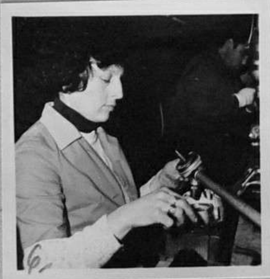
82-358-2 Поглед към цех "80" - монтажнен участък П.Донев/МД 82-358-6 Тотка Цветкова, партийна секретарка на първична парт.организация П.Донев/МД 82-358-10 Валентина Дончева Димитрова от цех "80" - монтажнен участък.Набиване на статорни пакети П.Донев/МД
