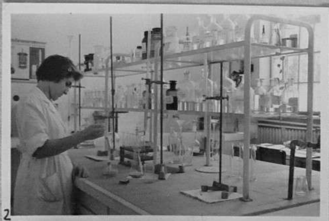
2- Химическа лаборатория - инж. химикът Ана Малчева прави количествен анализ на силиций в стоманата.
