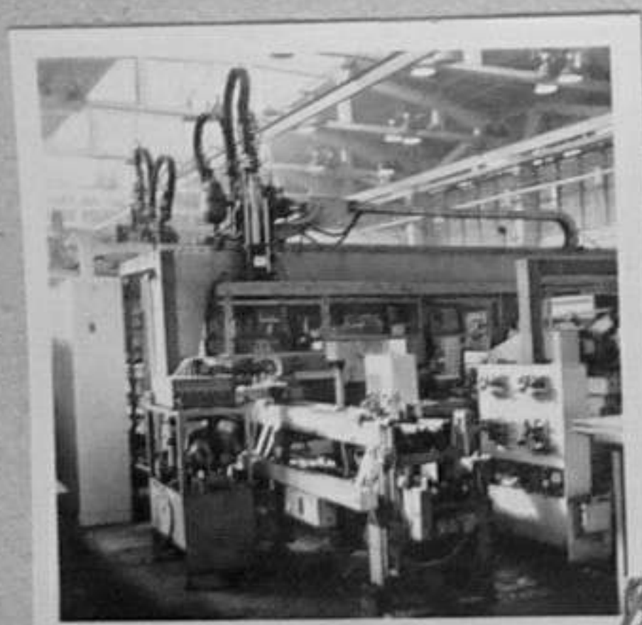
80-3489-8,11 Участък "Валове" - автоматична линия за шлайфане на валове Кр.Узунова/МД
