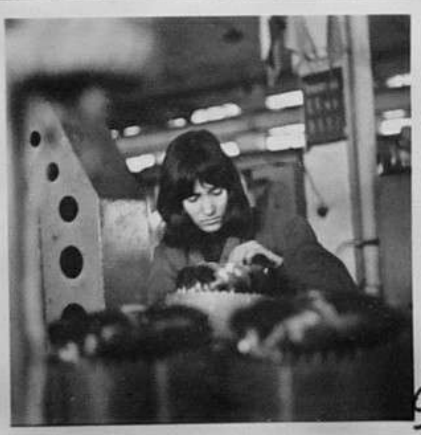
9 - Конвейер за монтиране на електромотори от среден тип. КГ 3.
