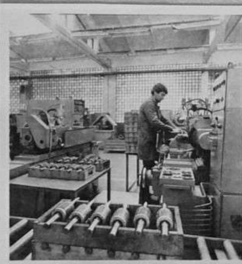
84-1597-4,5-Митка Стоянов, шлайфист, извършва шлайфане на вал-ротор. /В.Балевска/ЛА
