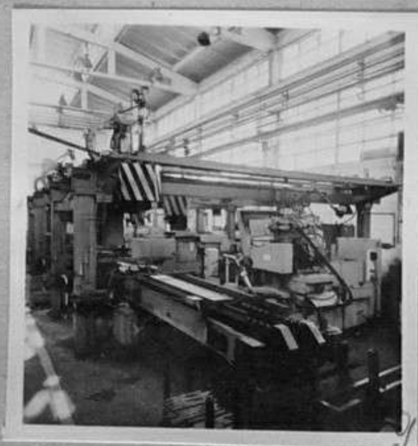
83-762-9 Автоматична линия за обработка на вал Е. Любомиров/МД
