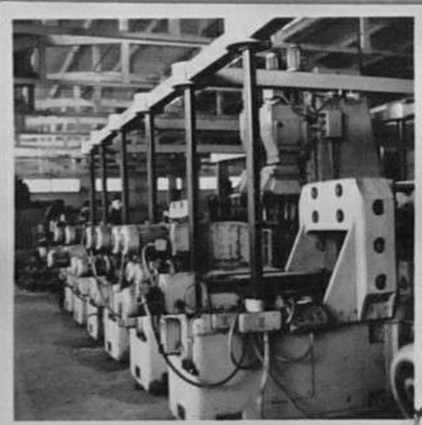
70-4187-7-Автоматична аг- регатна линия за обработ- ка корпусите на електро- моторите. /Л.Златков/ XII
