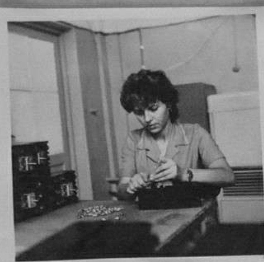
83-1397-11-Пепа Страхилова извършва електрически реглаж на автоматични прекъсвачи. Ем. Богоев/ЛШ
