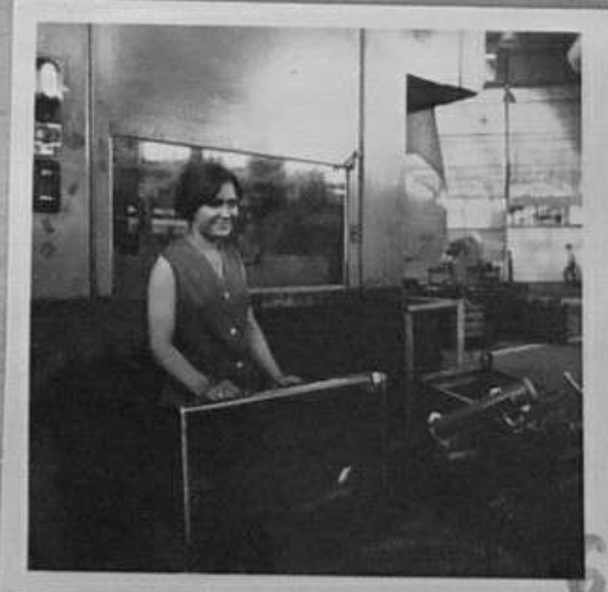
81-2255-6-Преса "Шулер" за изсичане пластинки за ротори и статори. Ем. Богоев/АШ
