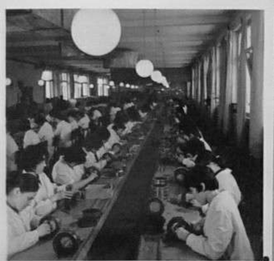
69-1328-2-Конвейерна линия за производство на електро-микродвигатели за хладилници. /Л.Чаръкчиев/ XII
