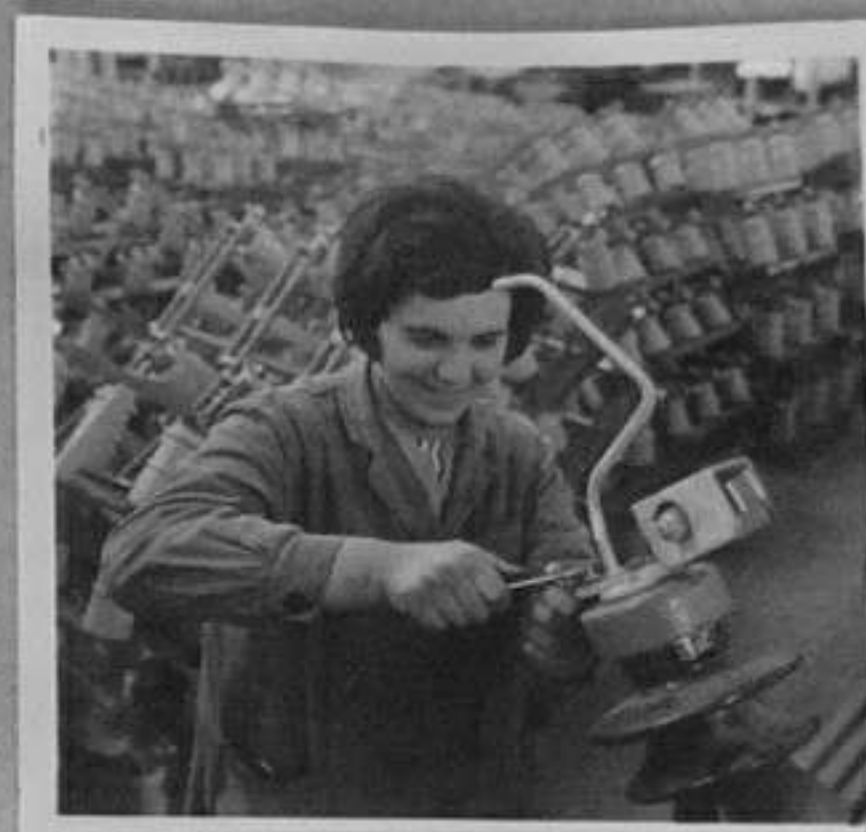
71-1478-6-Монтаж на еднопо- люсен разединител. /Р.Парушев/ ХП
