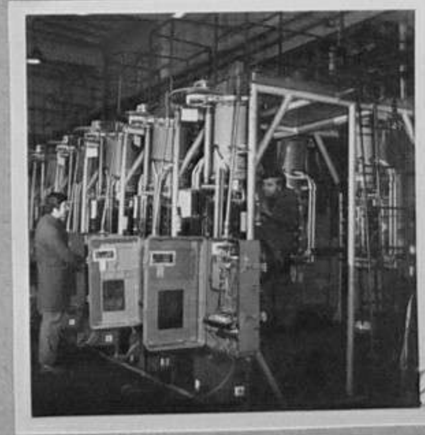
84-62-9-Стенд за механическо и електрическо изпитание на регулатори РС-4, получили оценка "К".
