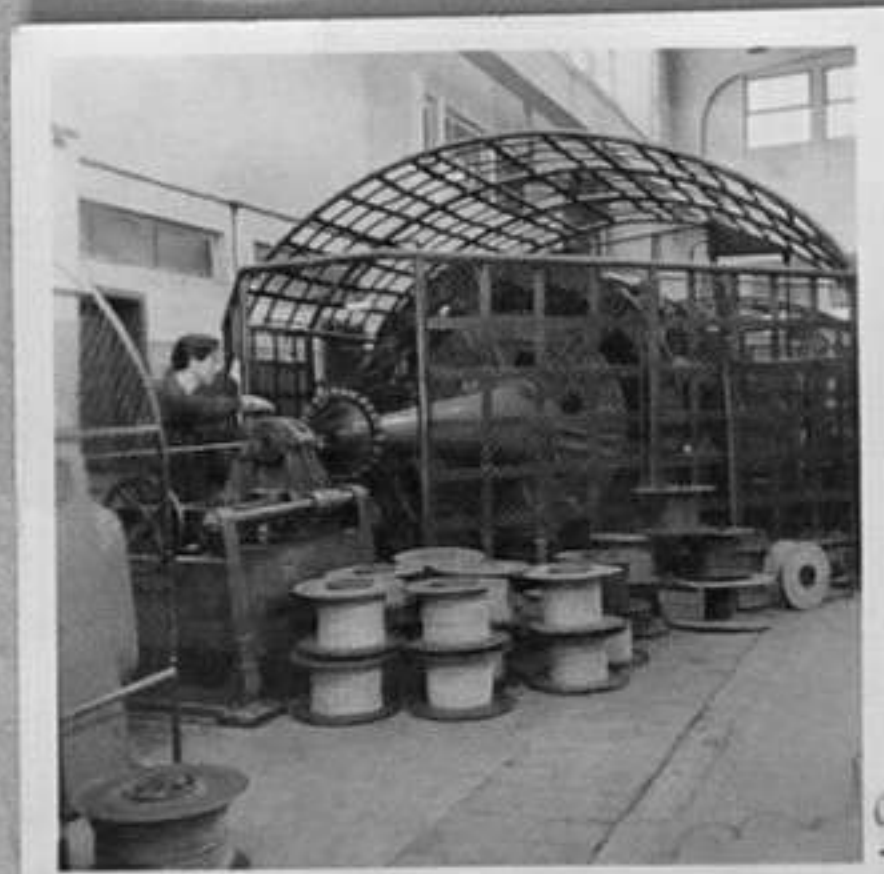
9- Машина, която усуква жилата на кабела с хартиена изолация.
