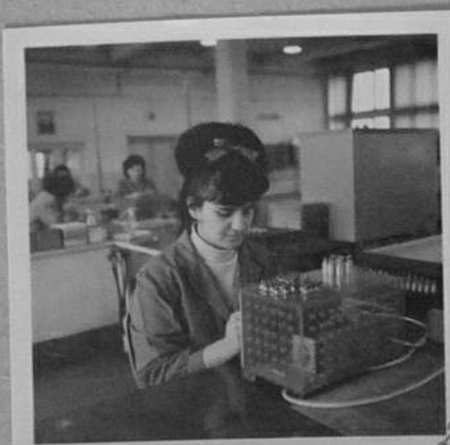
72-770-2-Комсомолката Д. Стоилова изпробва на магнитност патрон на термоелектрически предпазител за газови печки "Терма". /Е. Богоев/ МК
