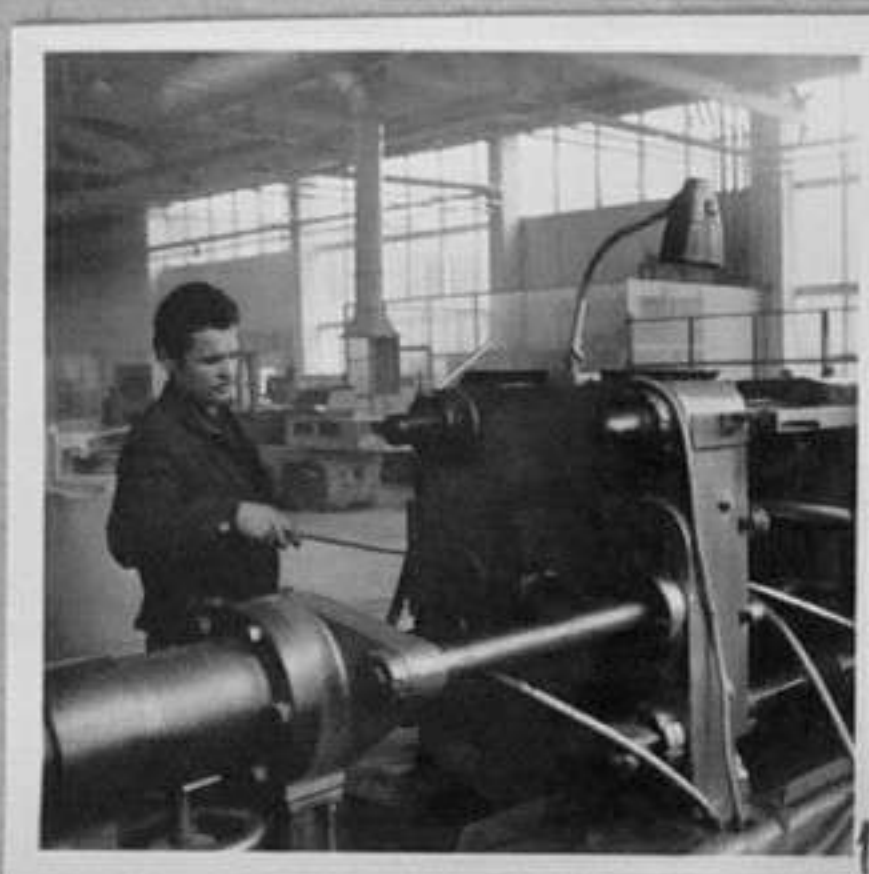
71-6408-1-Леярна маш. за леене на заден щит за ге- нер. на "Жигули". /Н. Чобанов/МК
