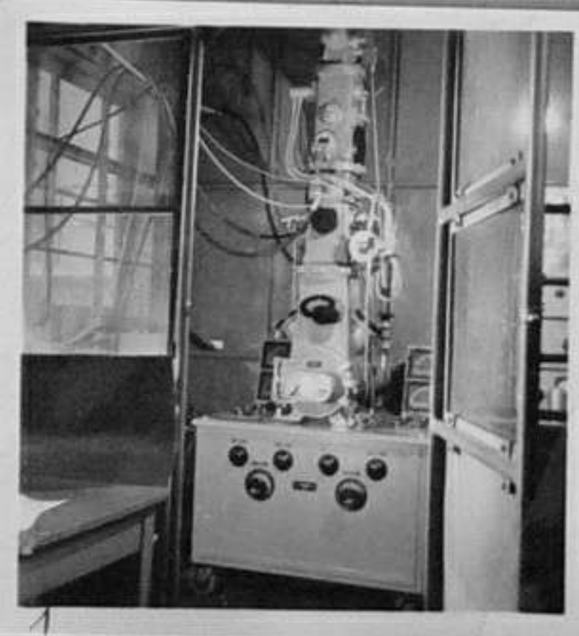
1-Електронен осцилограф за изследване на процесите при импулси с високо напрежение.
