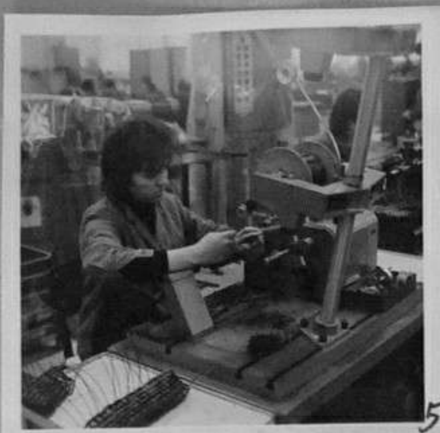
71-6410-5-Ст. Георгиева изв. навиване на фразови намотки на генератори. /Н. Чобанов/ МК
