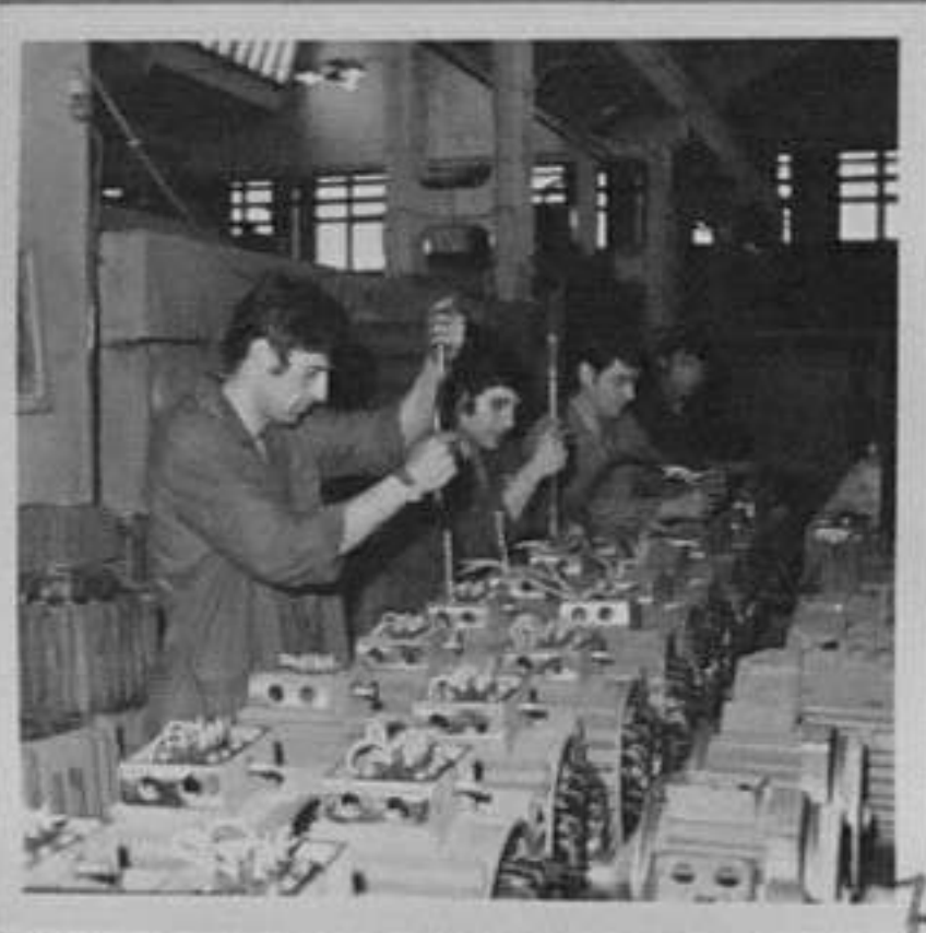
72-4477-7-Младежка бригада с ръководител В.Ангелов работи по монтажа на ел.двигател АСФ. /Ан.Цанков/ИК
