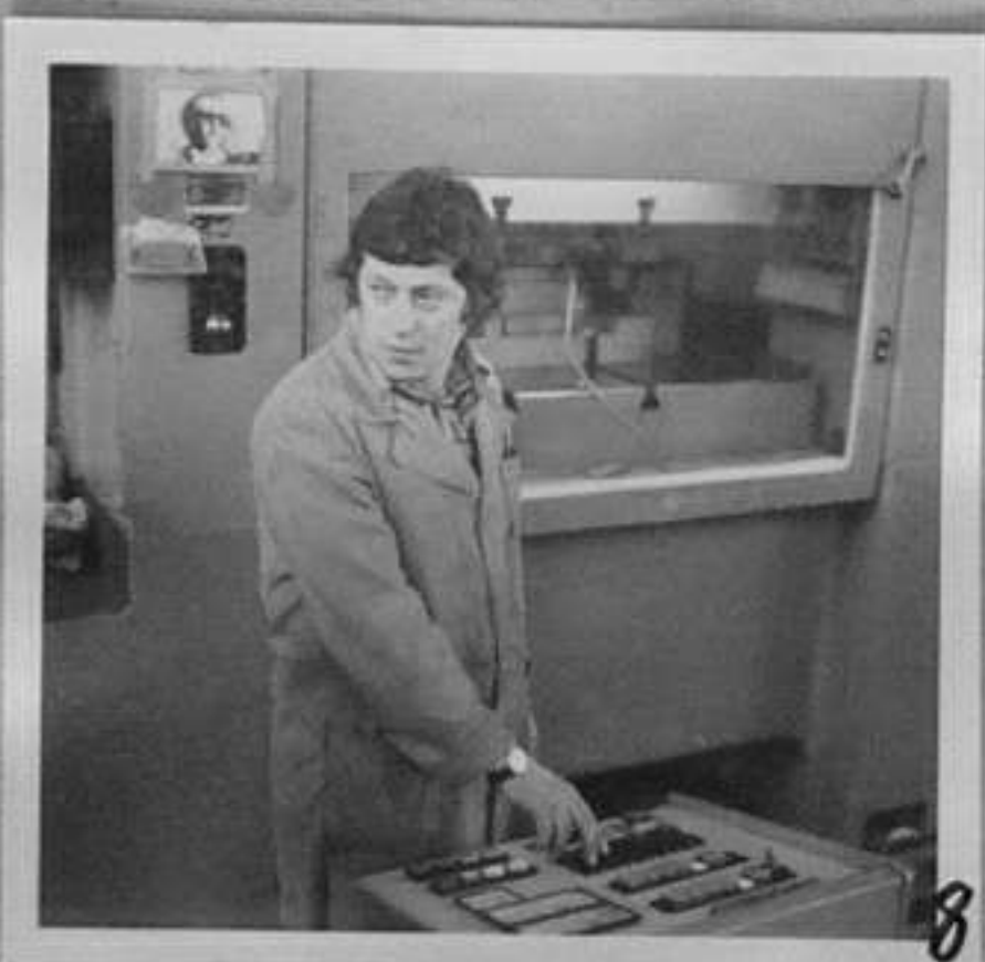
77-1813-8 Пресов цех - на новата автоматична преса за роторен и статорен пакет работи на-стройчикът Кънчо Стоянов, носител на сребърен орден на труда Кр. Узунова/МД
