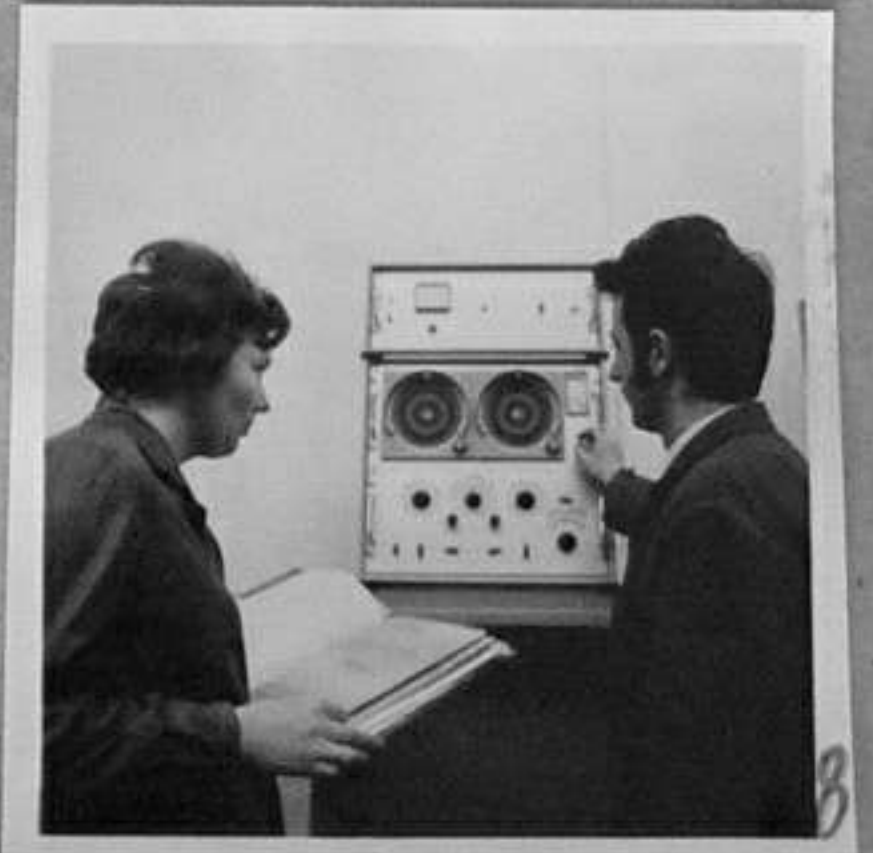
74-920-8-Инж.Х.Митев и Г.Захаријева проверяват дебалансите на роторите. /Х.Румян/ТК
