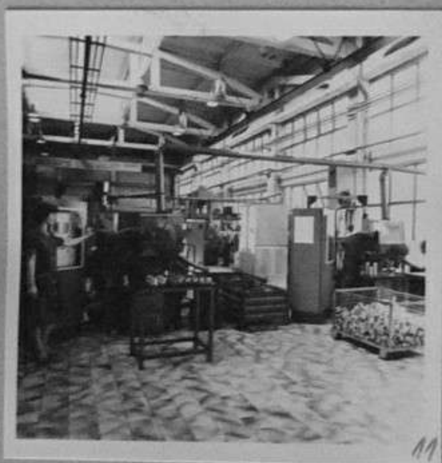
83-1339-11-Комплексен участък за производство на колектори за електродвигатели. Р. Марукян/ЛШ
