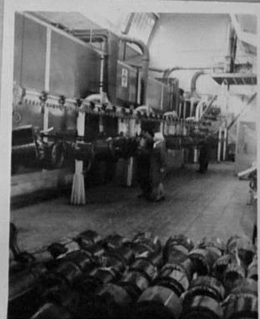
72-5511-4 - Автоматизирана уредба за импрегнация на статорни пакети за електро- двигатели. /Е. Любомиров/ЕИ
