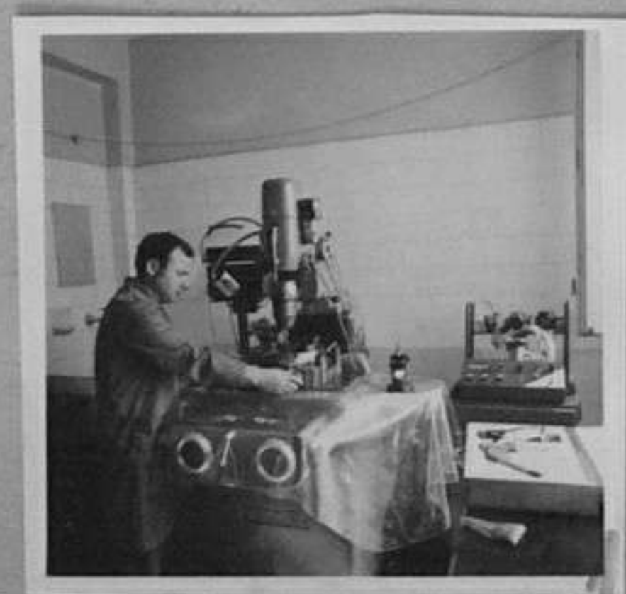
81-2255-1-Шлайфкоординатна машина "Дежел". Димо Пенев, оператор. Ем. Богоев/АШ
