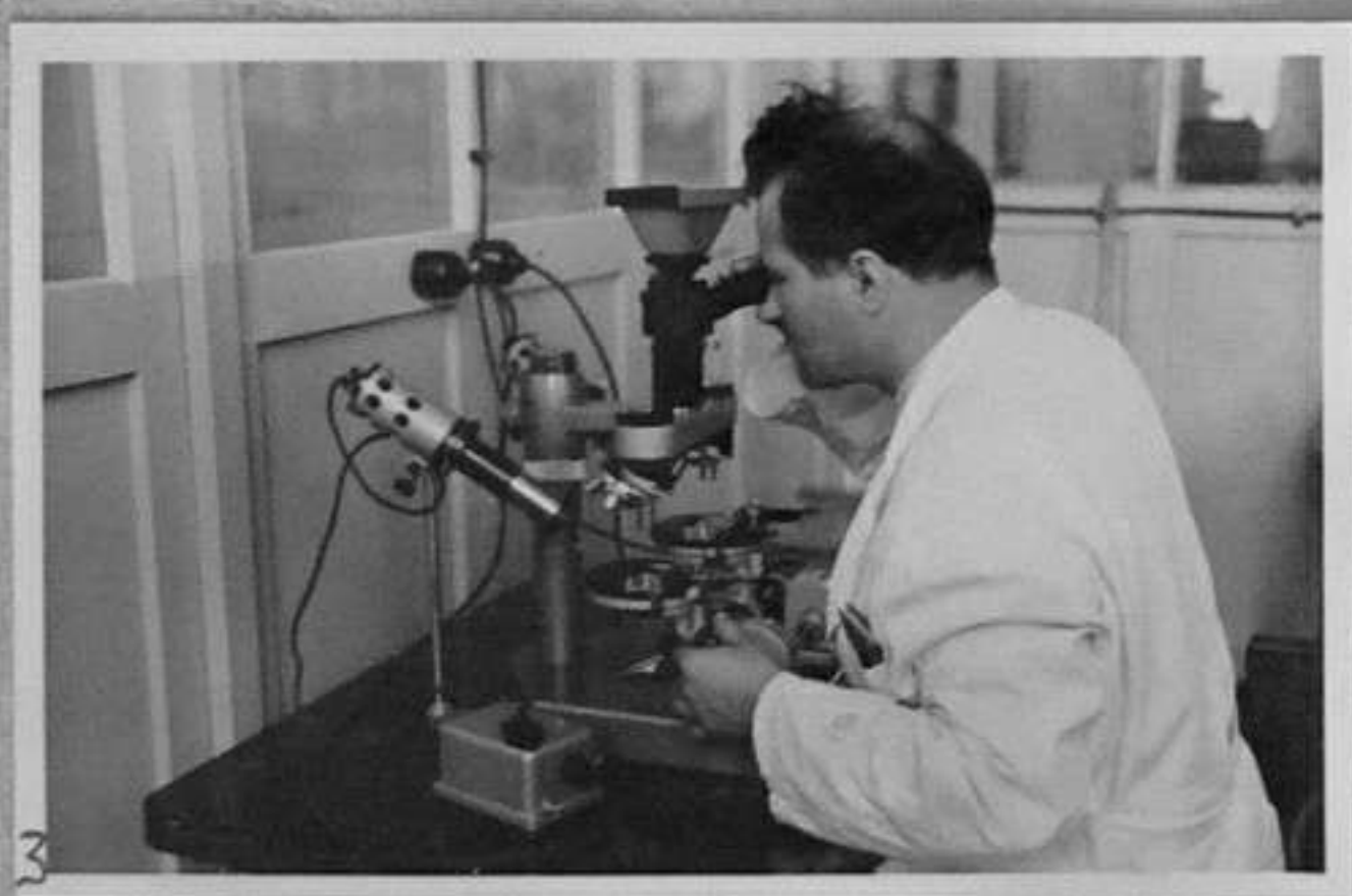
3-Сравнителен микроскоп за сравнение структурата на металите - Сотир Христов.
