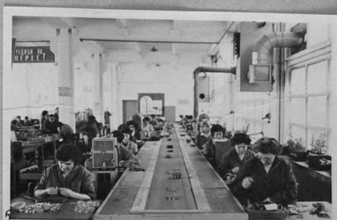
5-Монтажен конвейер за терморелета.
