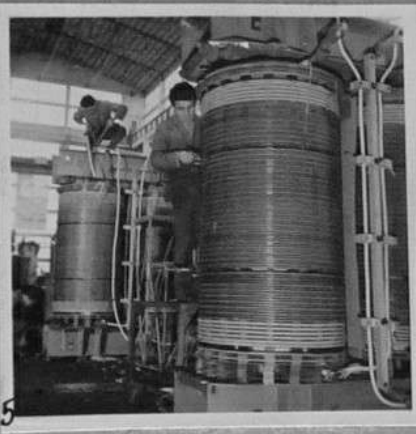
4-Изработка на печен трансформатор 1800 KVA.
