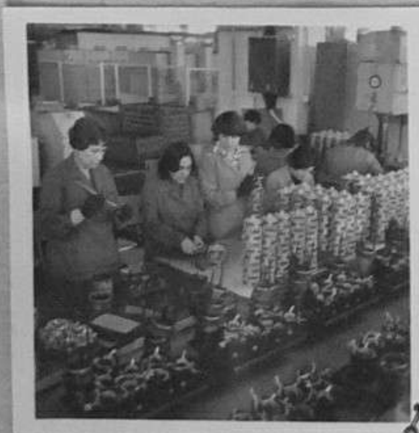
78-1114-2 Сглобяване различни части от ротора на електро-мотора на автомобил "Жигули" от Г.Иванова, М.Козарева и К. Вълчева Е.Любомиров/МД
