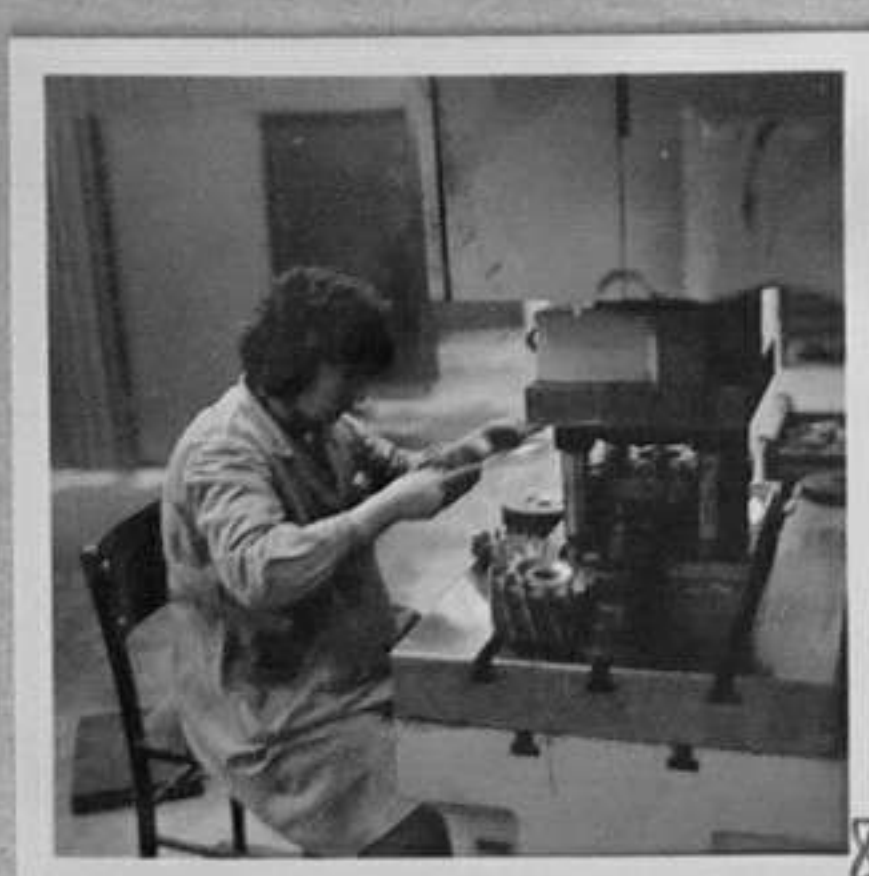
71-6409-8-Ст. Шуманова щан- цова вентил. на шайба на генератор. /Н. Чобанов/МК
