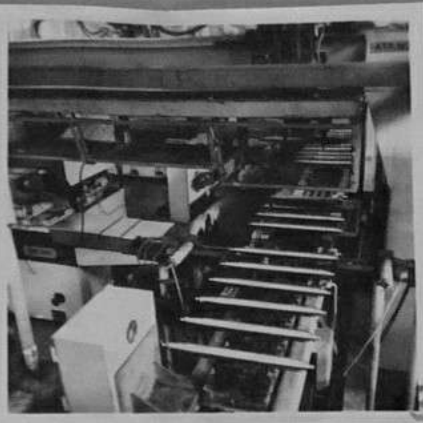
80-4071-1,3,6 Автоматична линия за обработка на валове за електродвигатели с капацитет 100 хиляди броя годишно, която се обслужва от "човека, преминал през квалификационен курс Г.Чакърян/МД
