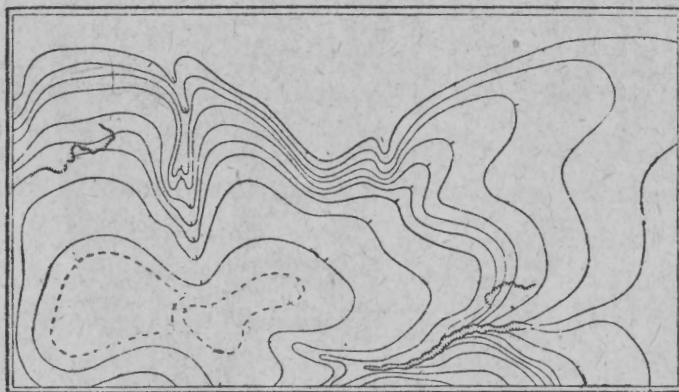
Фиг. 19 II. Изобразяване горния релеф чрез хоризонтални плоскости получават най-много светлина и затова остават изразени с бели площи. По-малко наклонените получават по-малко светлина, поради което те получават тънки щрихи и стават по-тъмни, а
